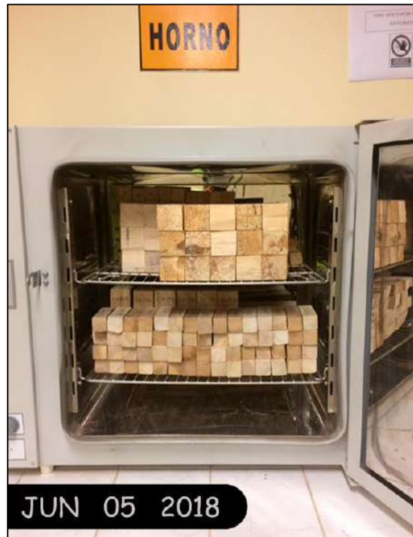
Fotografía 19. Horno de laboratorio con las muestras de madera
