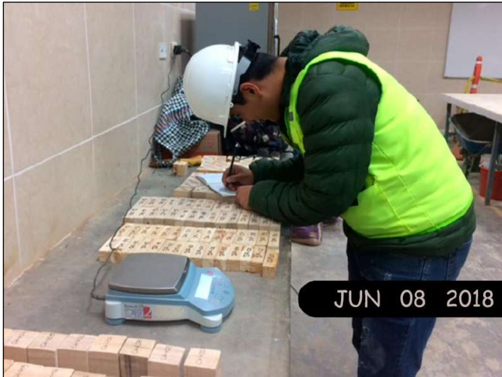
Fotografía 21. Toma de datos de muestras después de ser colocadas en el horno
