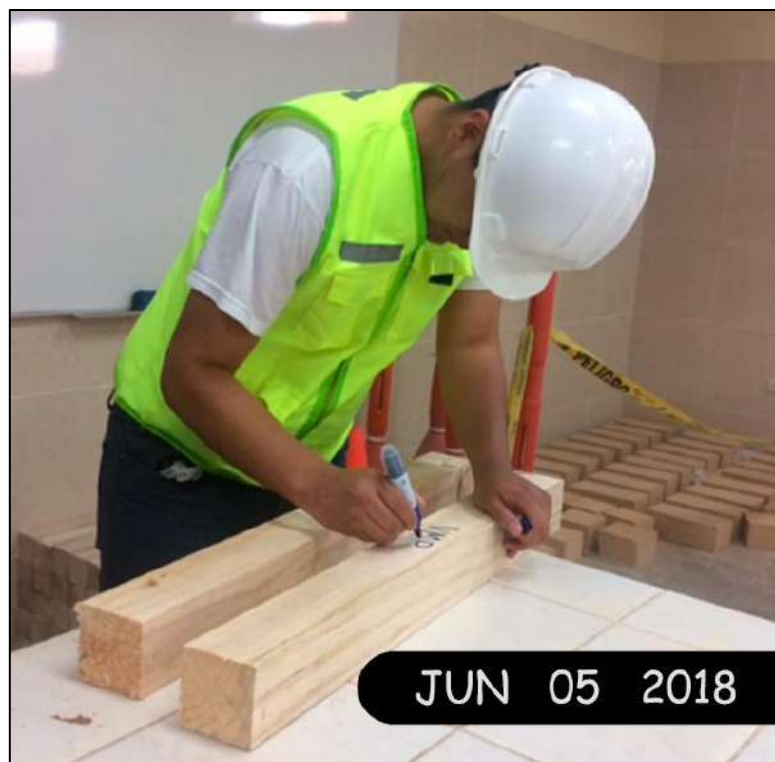
Fotografía 20. Codificación de muestras de vigas macizas
