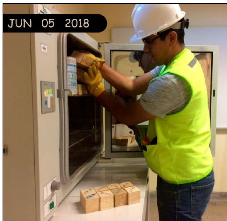
Fotografía 18. Colocación de muestras de madera en horno
