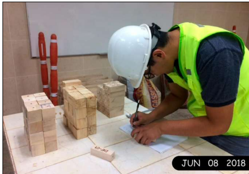
Fotografía 11. Toma de datos de dimensiones de probetas para CH y DB
