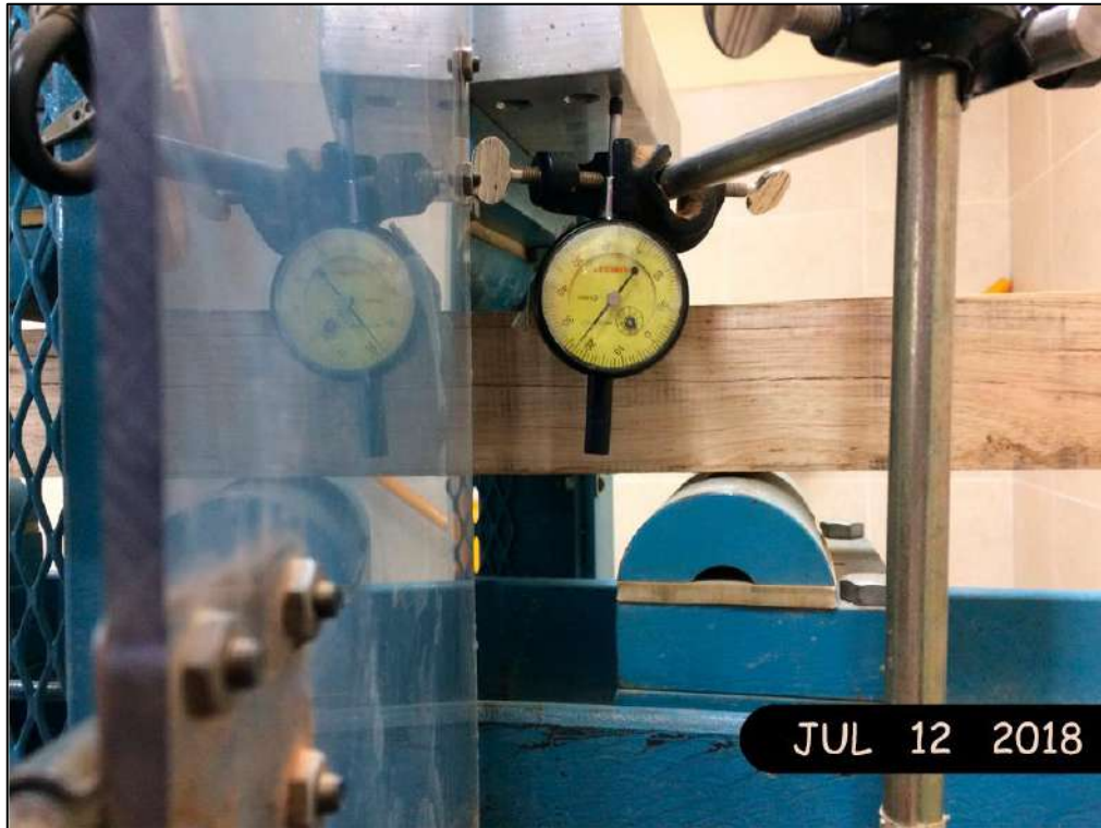
Fotografía 27. Toma de datos con deformímetro
