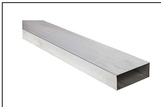
Figura 22: Regla de tarrajeo.
