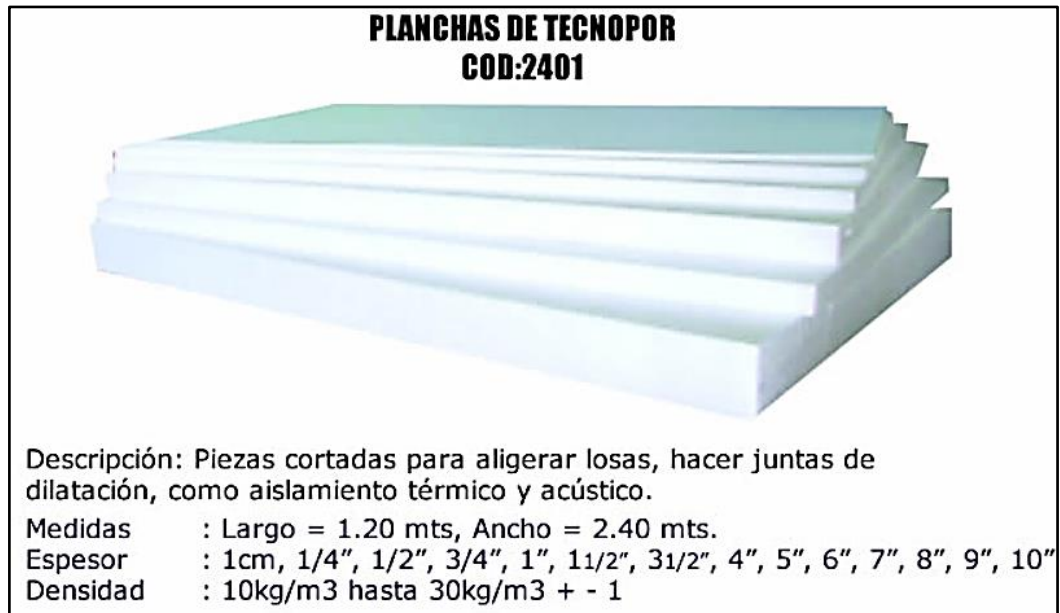
Figura 29: Especificaciones técnicas del tecnopor.
