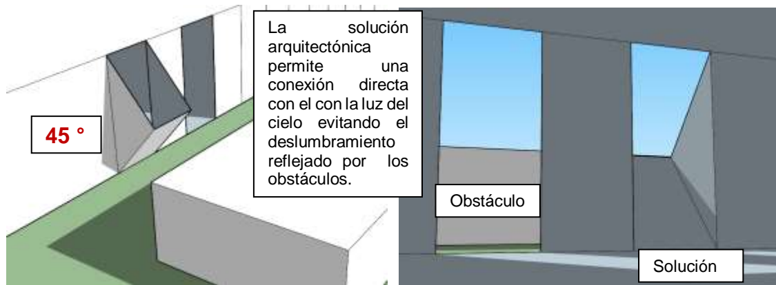
Figura n° 35: Grafico premisa de diseño orientación de ventanas sin obstáculos.
