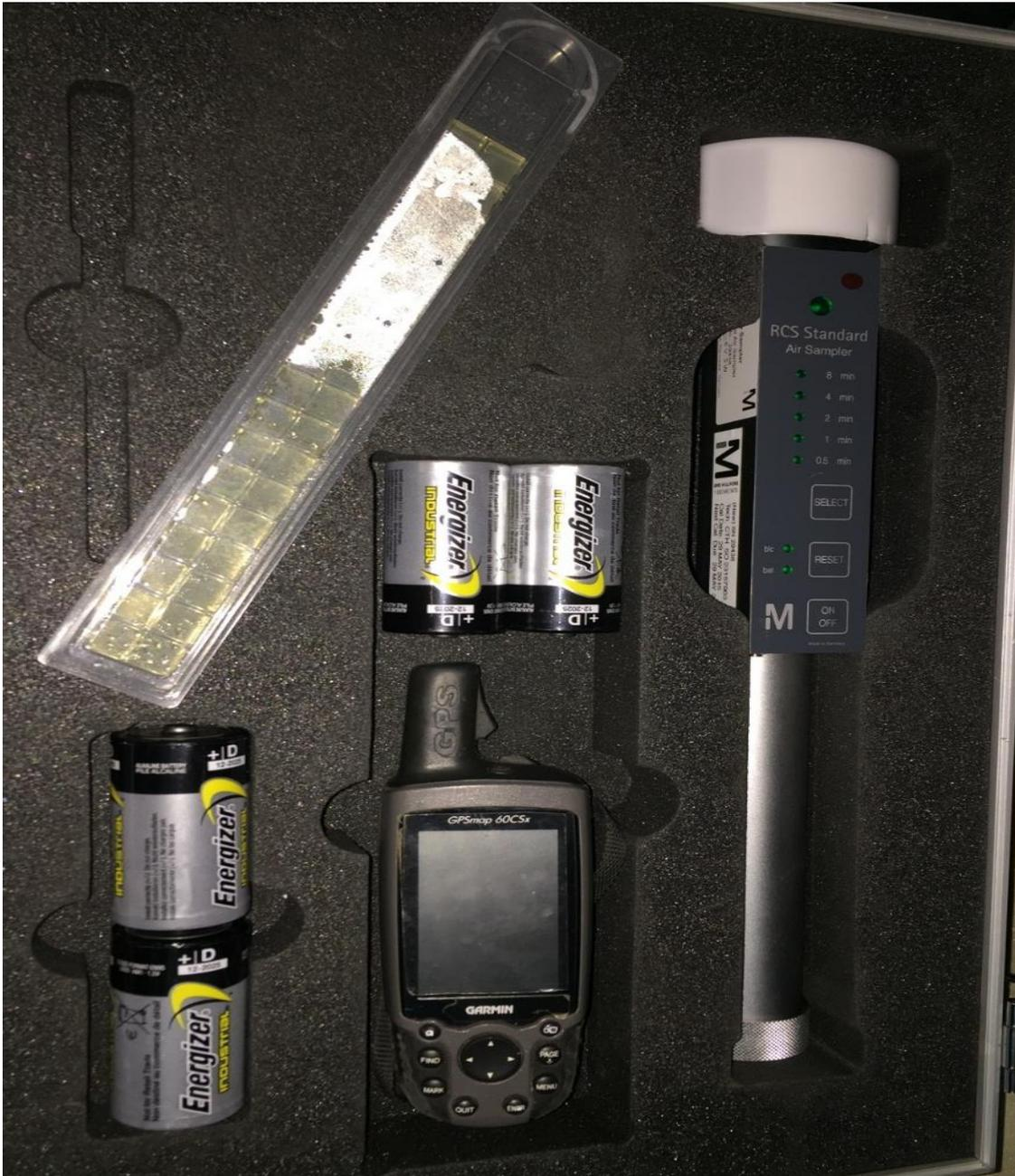
*Figura 1:* Equipo microbiológico de aire RC, una tira de agar y el GPS.
