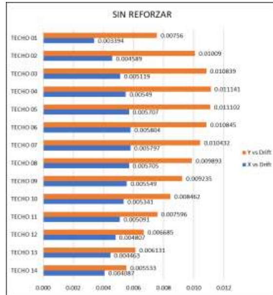
Figura 47: Distorsiones de entrepiso finales del modelo sin reforzar en el eje X y eje Y
