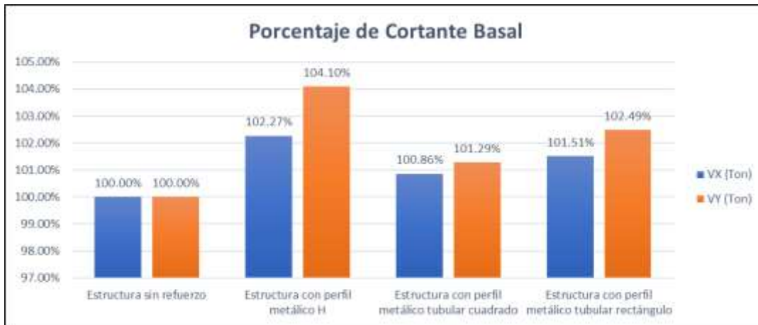
Figura 46: Porcentajes de Cortante basal final de cada modelo evaluado en el eje X y eje Y
