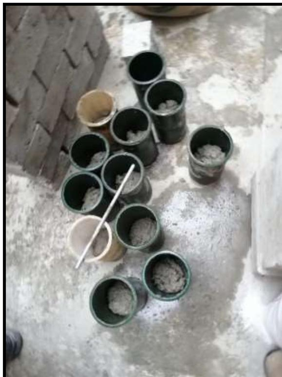
Fotografía N° 30: Colocación de la mezcla de concreto en los moldes.
