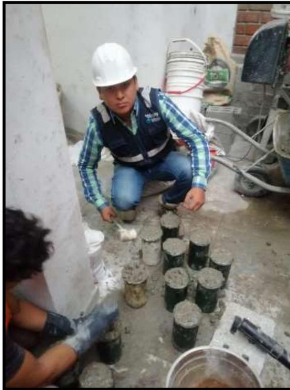
Fotografía N° 31: Curado de testigos de concretos.
