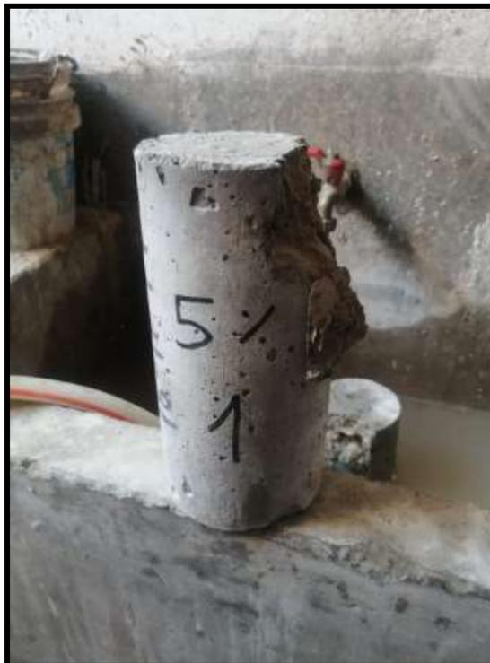
Fotografía N° 36: Falla tipo 5 en probeta de caucho granulado al 10%.
