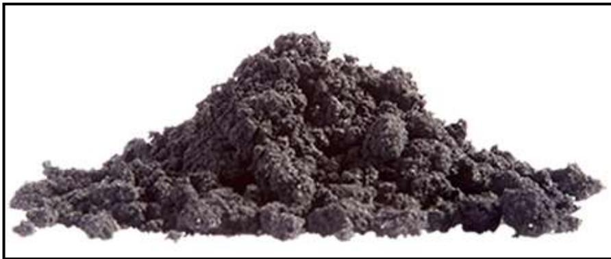
Figura N° 3: Caucho Granulado.
