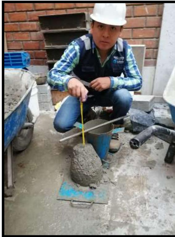
Fotografía N° 27: Toma de medición de slump 4”.
