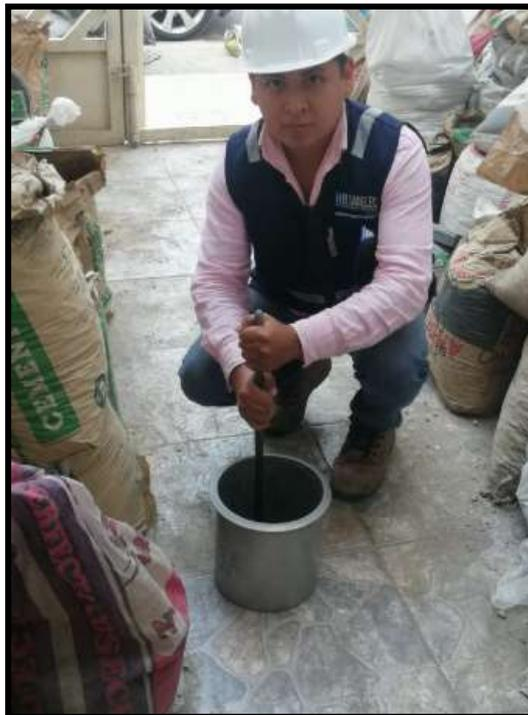
Fotografía N° 8: Toma de datos para ensayos de contenido de humedad de agregados.
