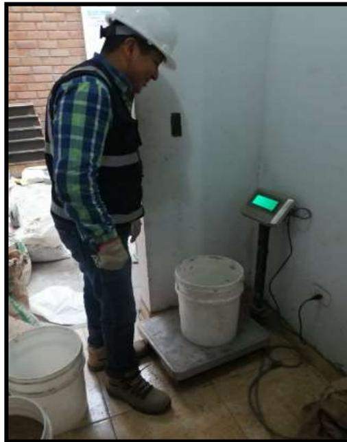
Fotografía N° 15: Pesaje de cantidad de agregado según diseño.
