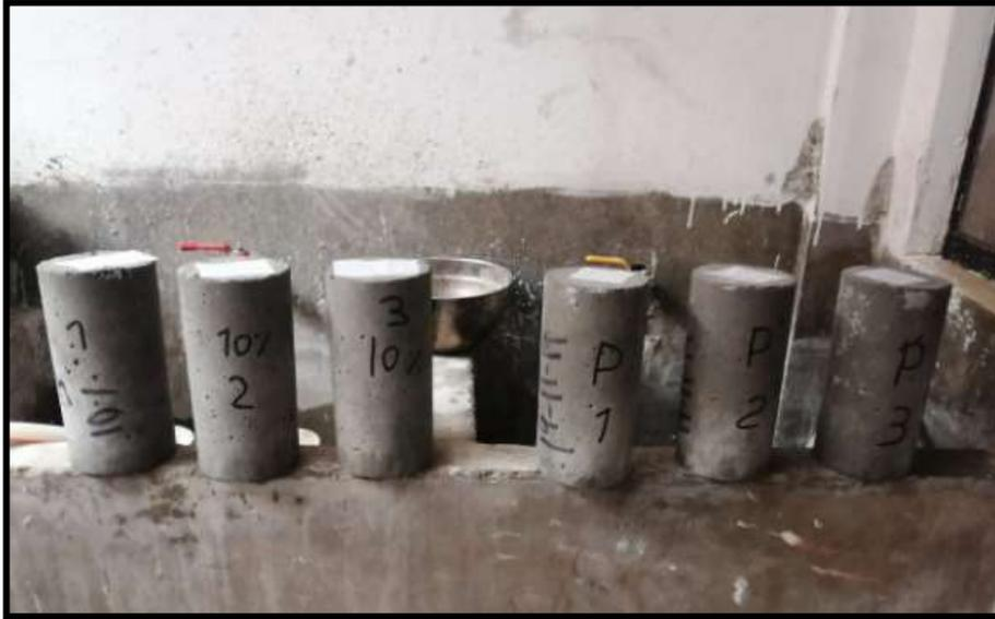
Fotografía N° 33: Testigo de caucho granulado al 10% listo para ser ensayado a carga axial.
