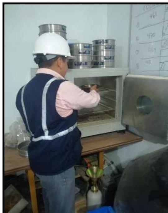
Fotografía N° 10: Toma de datos para peso específico de los agregados.
