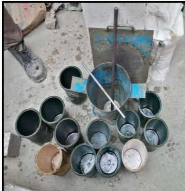
Fotografía N° 20: Preparado de moldes para probetas.
