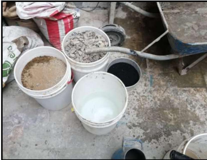
CONCRETO SIMPLE Es una mezcla de cemento Portland, agredo fino, agregado grueso y agua. En la mezcla el agregado grueso deberá estar totalmente envuelto por la pasta de cemento, el agregado fino deberá rellenar los espacios entre el agregado grueso y a la vez estar recubierto por la misma pasta. (Castillo, 2010).
