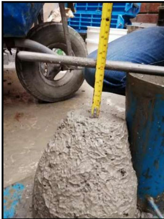
Fotografía N° 28: Toma de medición de slump 4”.
