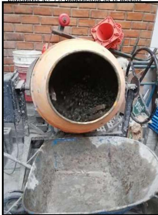
Fotografía N° 23: Colocación de caucho granulado a la mezcla en
