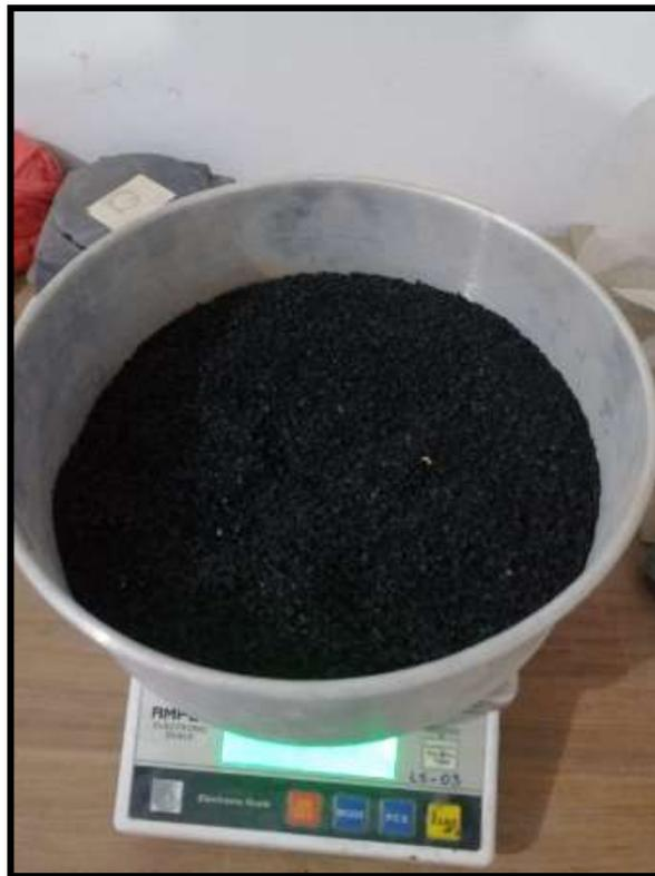
Fotografía N° 17: Pesaje de cantidad de caucho granulado según diseño.
