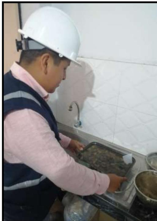
Fotografía N° 12: Tamizado de agregados para toma de datos.
