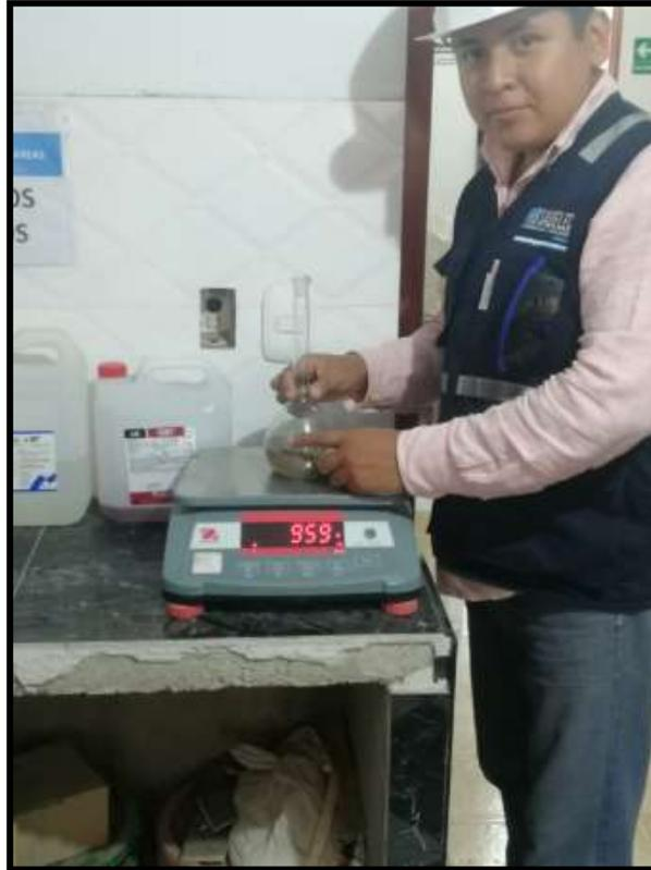
Fotografía N° 11: Lavado de agregado grueso para toma de datos de peso específico.
