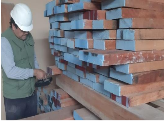
Figura 21: medicion del grado de humedad.
