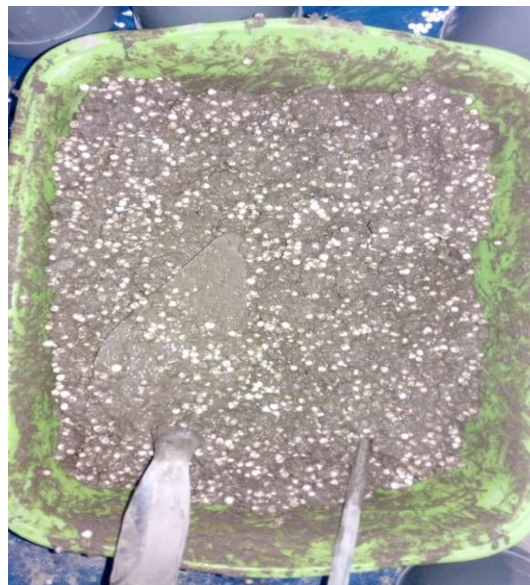
Figura 5. Concreto preparado al 35% de poliestireno expandido y listo para depositar en las probetas.
