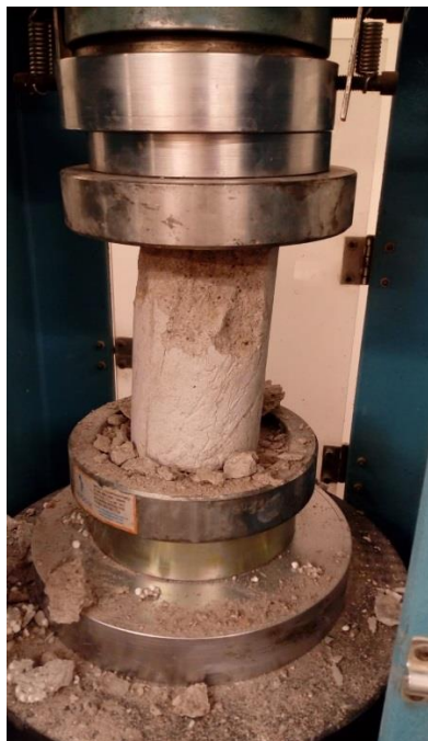
Figura 21. Ensayo a compresión de testigo de 28 días, sin adición de poliestireno expandido, se observa una rotura superior.
