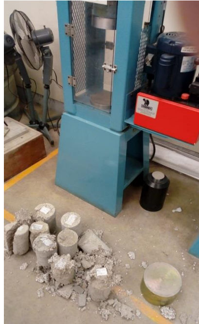
Figura 24. Testigos ensayados, y analizados en resistencia y forma de falla en su estructura.
