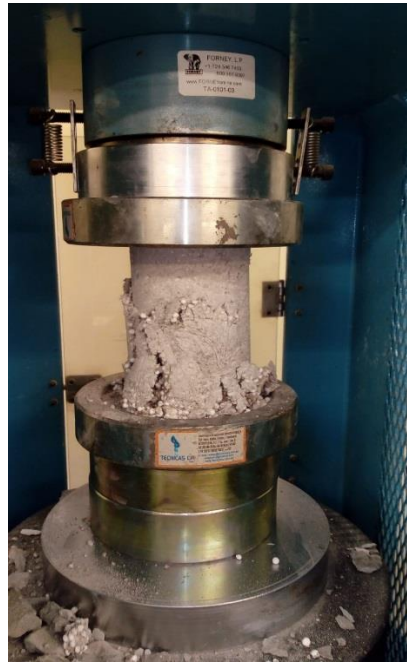
Figura 20. Ensayo a compresión de testigo de 28 días al 35% de poliestireno expandido, se observa deformaciones plásticas.
