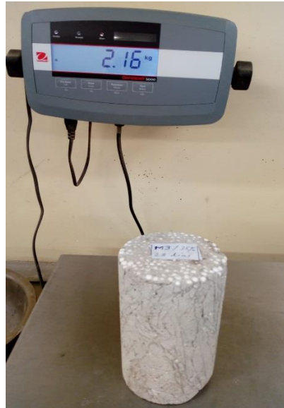
Figura 12. Pesaje de espécimen al 35% desmoldados, y listos para la medición de nivel de absorción (24 horas).
