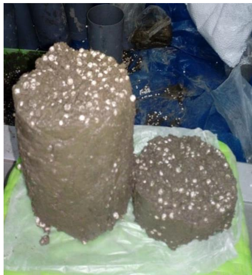
Figura 7. Extracción de concreto 20 minutos después de vertido en probeta, posee una consistencia ligosa y elástica, producto mismo del material de poliestireno. La imagen muestra un corte transversal del espécimen.
