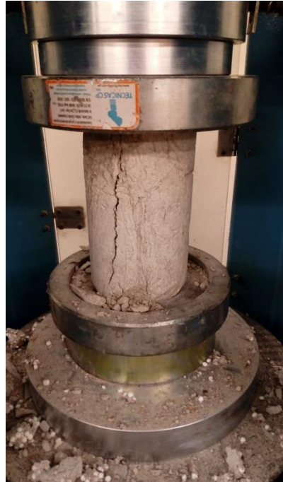
Figura 22. Ensayo a compresión de testigo de 28 días, sin adición de poliestireno expandido con una rotura tradicional en diagonal.
