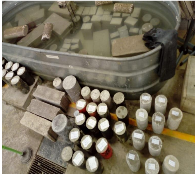
Figura 16. Laboratorio de la Universidad Privada del Norte, y especímenes con 28 días de curado, listos para ensayo a compresión.
