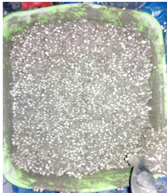
Figura 9. Concreto preparado al 50% de poliestireno expandido y listo para depositar en las probetas.
