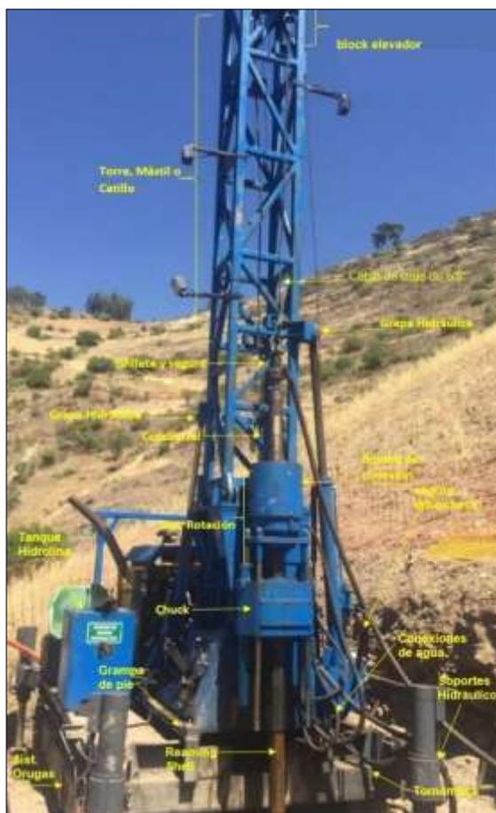
Figura N° 25 Máquina perforadora y montaje
