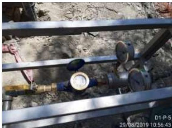
*Figura N° 35* Toma de datos como el tiempo y medición del volumen de agua en relación con los niveles de agua en el interior de tubería de casing de acero en pozo perforado
