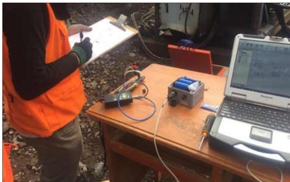
Figura N° 61 Verificación y calibración de transductor en conexión con Datalogger
