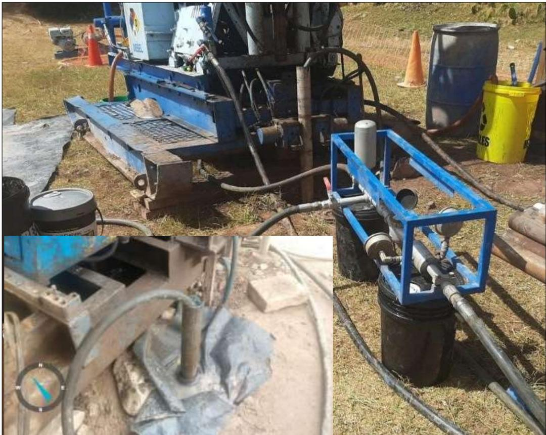
Figura N° 37 Etapa de registros del ensayo de permeabilidad Lefranc a carga variable, el ensayo dura aproximadamente una hora.
