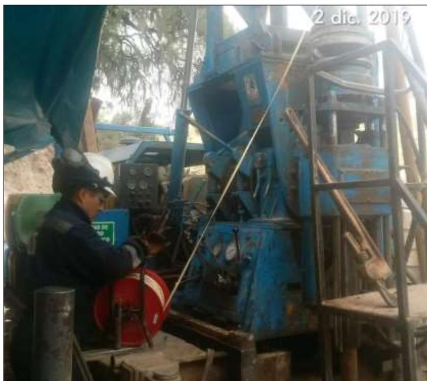
*Figura N° 30* El ratio de avance en la perforación y el cambio de presión requerida puede ayudar a identificar los cambios de estrato. Las pérdidas o ganancias de agua permiten definir presiones piezométricas y el flujo a través de las capas investigadas. La medida del nivel freático al final de un día e inicio del siguiente, permite cuantificar las permeabilidades e identificar aguas estáticas.
