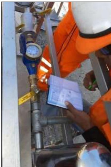
*Figura N° 34* Toma de datos durante la ejecución del ensayo de permeabilidad Lefranc a carga constante
