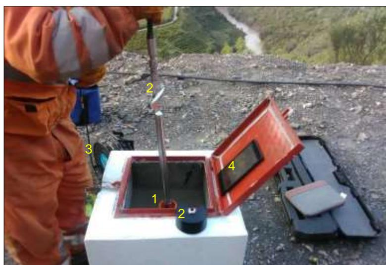
Figura N° 4 1)Tubería (guide casing), 2)Sonda torpedo con adaptador, 3)Cable graduado con carrete y 4)Unidad lectora portátil
