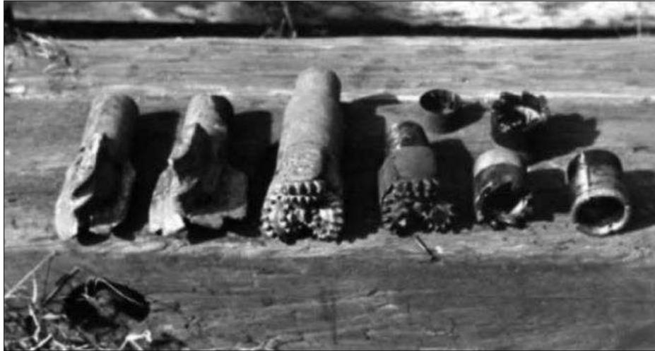
*Figura N° 22* Varios tipos de brocas, de izquierda a derecha: Brocas de corte de tierra de tres hojas, Brocas de corte de roca con rodillo tricónico, brocas de dientes de carbolog tipo corona para cortar roca blanda y broca de diamante para perforación de roca.
