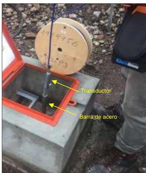
Figura N° 63 Ingreso de Transductor configurado, con de barra de 30 cm (contrapeso evitará que flote)
