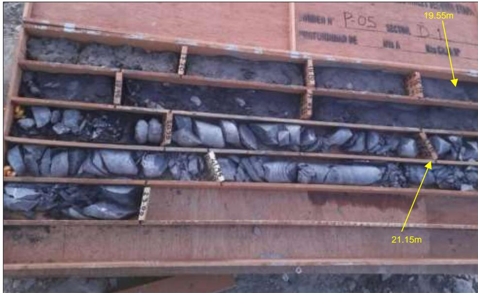
*Figura N° 31.* Por ejemplo, para el punto D1-P5 de la zona inestable N° 1, se observa que antes de ingresar a suelo firme o roca, se presenta un estrato posiblemente permeable donde se pueda estar desarrollando la superficie de deslizamiento, discontinuidad y falla progresiva. Por ello la profundidad del ensayo se desarrolla entre los 19.55m y 21.15 m.
