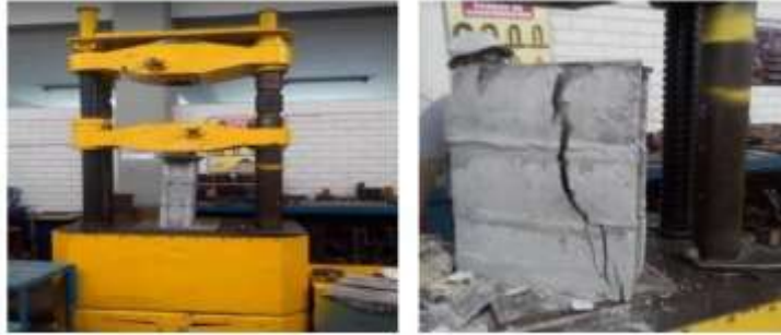
Figura 52: Falla producida en el ensayo de la pila
