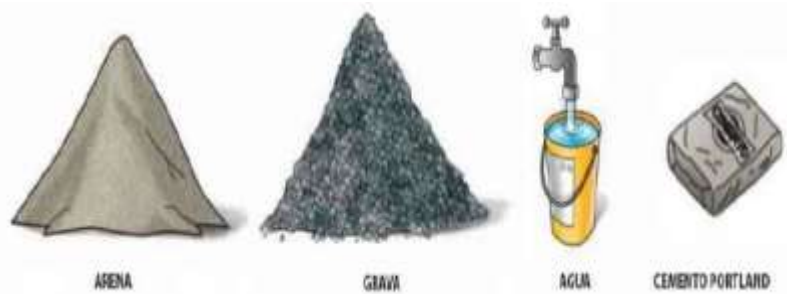
Figura 4: Componentes de los bloques de concreto
