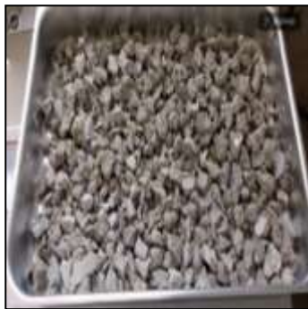
Figura 26: Trituración de las probetas de concreto
