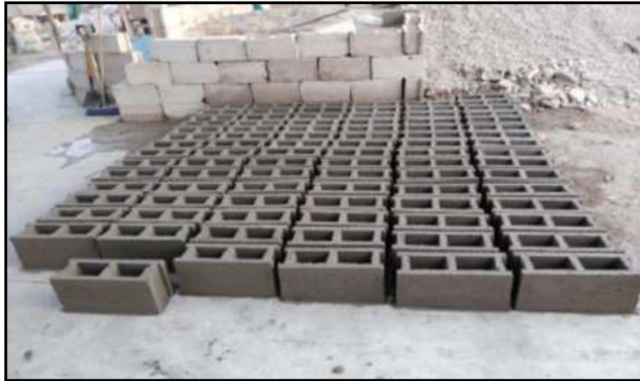
Figura 35: Proceso de almacenaje de los bloques elaborados
