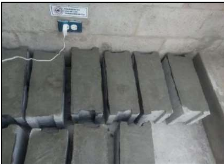
Figura 34: Proceso de curado de los bloques de concreto elaborados
