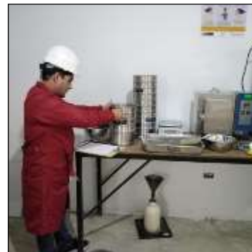
Figura 27: Tamizado de los residuos de concreto
