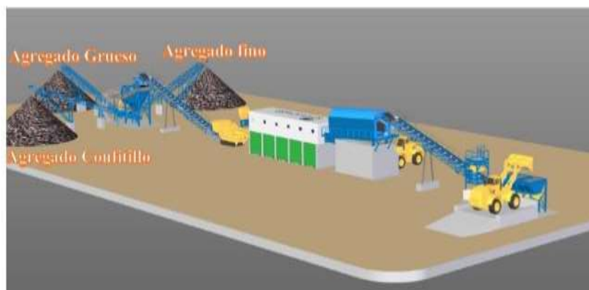
Figura 9: Proceso productivo para obtener el árido reciclado
