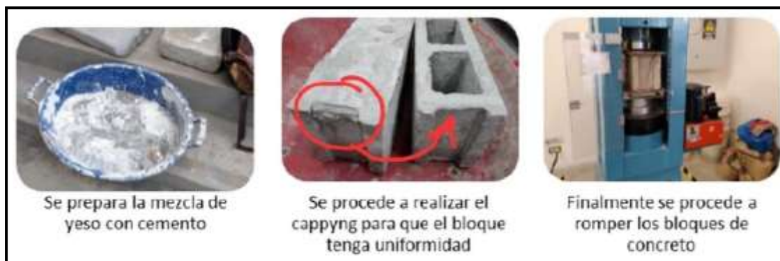
Figura 44: Ensayo de Compresión del bloque de concreto con agregado reciclado
