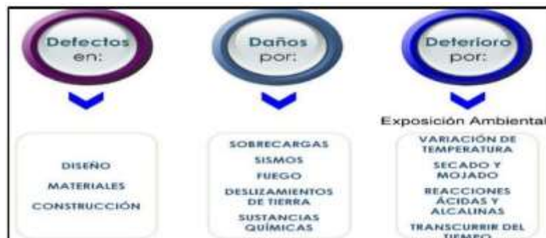
Figura 5. Clasificación general de Patologías en las Edificaciones.
