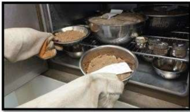
Figura 19. Procedimiento de secado de muestras en el horno
