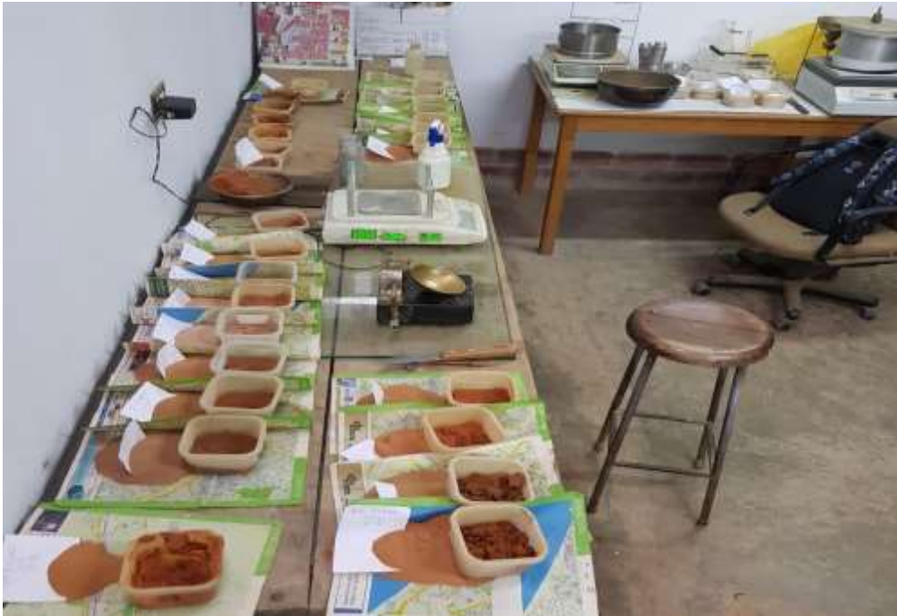
Foto 2. Laboratorio ensayos: Limites de Atterberg – Limite Líquido y Limite Plástico
