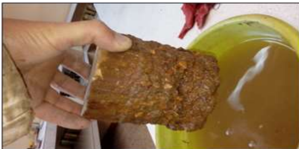
Figura 12. Ensayo de estabilidad hídrica.
