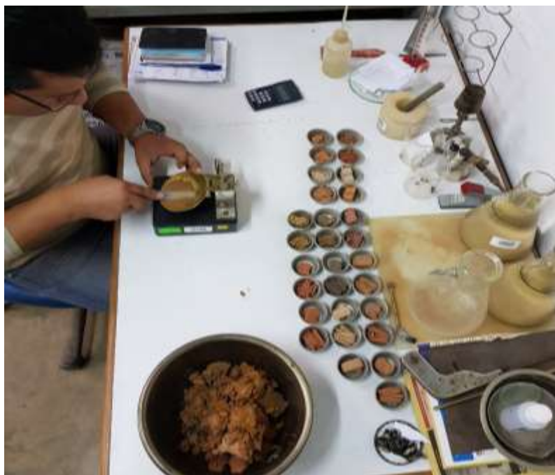
Foto 3. Laboratorio ensayos: Limites de Atterberg – Limite Líquido y Limite Plástico
