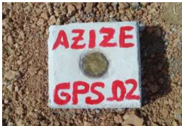
Figura 27. Punto de control GPS-02 monumentado.
