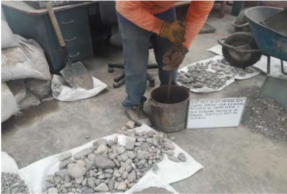
Foto 4. Ensayo de Compactación – Proctor Modificado
