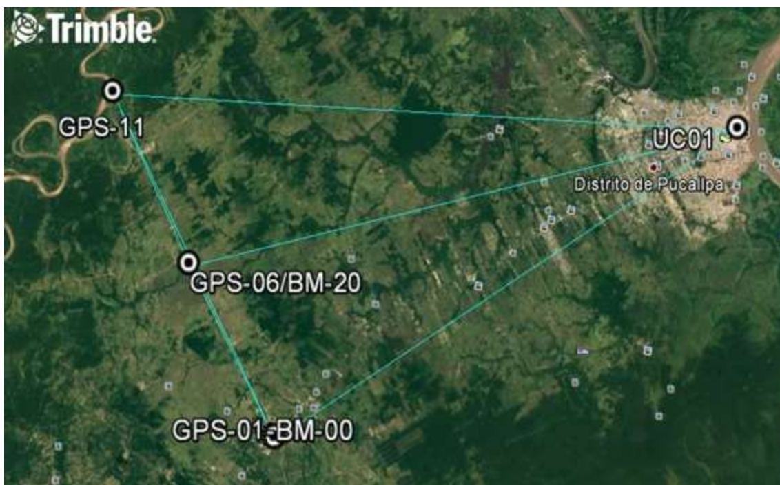
Figura 28. Equipo GNSS: Trimble R8 modelo - Croquis de enlace con la base de rastreo permanente. UC01, reporte del programa TRIMBLE BUSSINES CENTER
