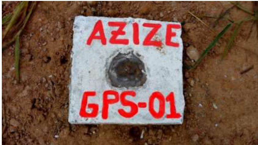
Figura 25. Punto de control GPS-01 monumentado
