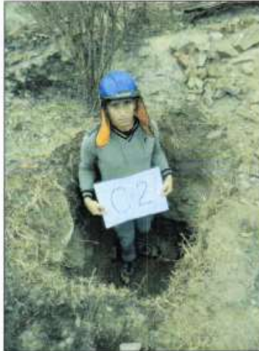
Foto N°5: De 0.00 a -0.55m de profundidad de la calicata C-2, es una arena mal graduada (SP), contiene gravas sub-redondeadas de tamaño máximo 1", suelta, de color gris, 0.9% de humedad, su composición es: 32.91% de gravas, 62.70% de arenas y 4.39% de finos.
