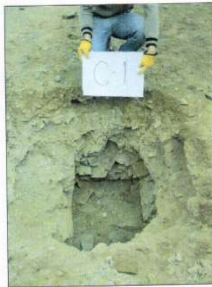
Foto N°4: De -0.20 a -1.50m de profundidad de la calicata C-1, es una roca fracturada moderadamente dura del tipo andestia (Roca), es una roca ígnea volcánica (extrusiva), verdosa, de grano fino o textura afanítica, muy compacta, constituida principalmente por plagioclasas y anfíboles. La propiedad física más notoria es su resistencia a la tracción y compresión. No presenta alteraciones químicas ni mineralógicas que puedan alterar sus propiedades físicas, solo el intemperismo natural y superficial.
