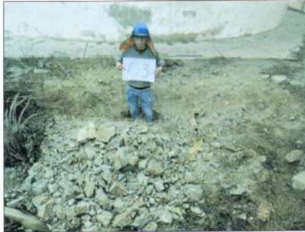
Foto N°7: De 0.00 a -0.25m de profundidad de la calicata C-3, es una arena mal graduada (SP), contiene gravas sub-redondeadas de tamaño máximo 1", suelta, de color gris, 0.9% de humedad, su composición es: 32.91% de gravas, 62.70% de arenas y 4.39% de finos.
