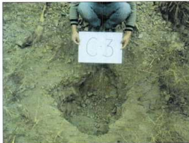
Foto N°8: De -0.25 a -1.00m de profundidad de la calicata C-3, es una roca fracturada moderadamente dura del tipo andesita (Roca), es una roca ígnea volcánica (extrusiva), verdosa, de grano fino o textura afanítica, muy compacta, constituida principalmente por plagioclasas y anfíboles. La propiedad física más notoria es su resistencia a la tracción y compresión. No presenta alteraciones químicas ni mineralógicas que puedan alterar sus propiedades físicas, solo el intemperismo natural y superficial.
