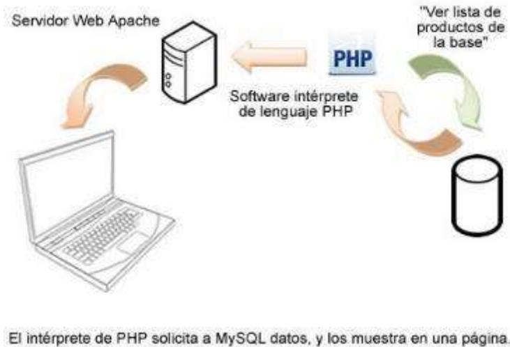
Figura 3: Interacción de un navegador hacia una base de datos
