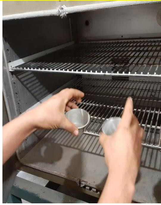
Foto N° 8 secado de las muestras en el horno
