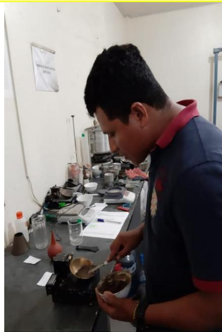
Foto N° 6 realización del ensayo en la copa Casagrande
