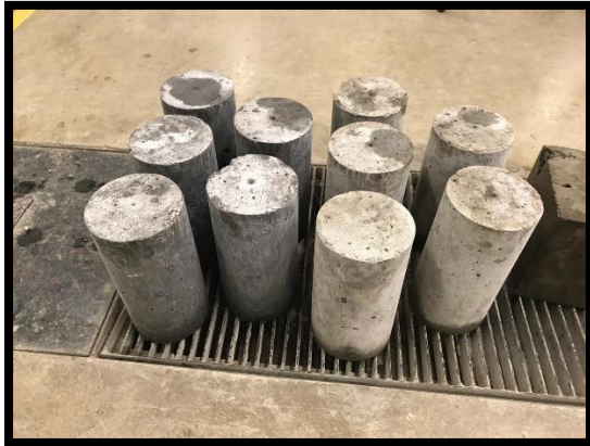
Figura 21 – Secado de las probetas por 24 horas en ambiente natural. (2019). Elaboración propia.
