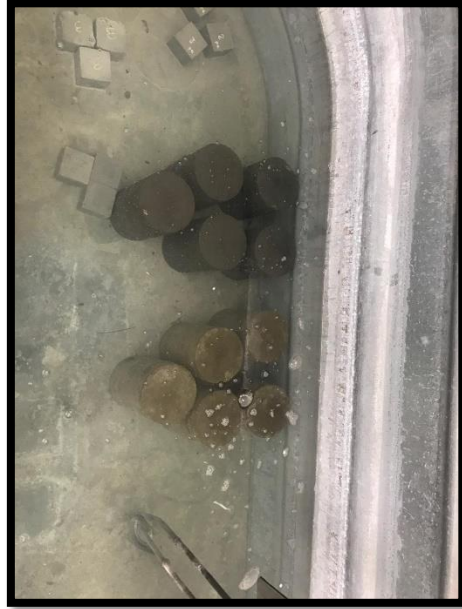
Figura 20 – Curado de las probetas cilíndricas. (2019). Elaboración propia.
