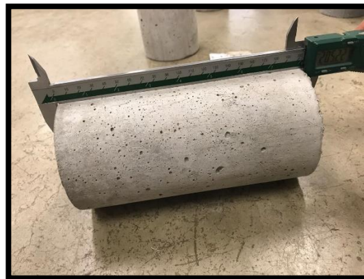
Figura 24 – Medición de la altura de la probeta. (2019). Elaboración propia.
