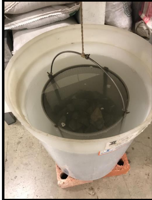
Figura 14 – Uso de la canastilla para el módulo de finura del agregado grueso (2019). Elaboración propia.
