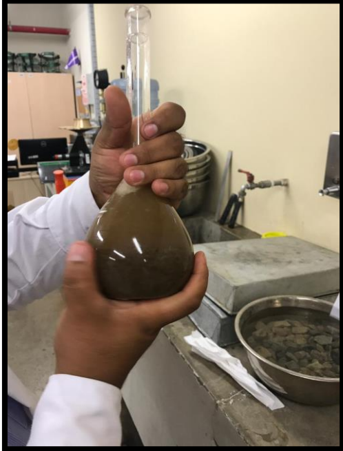
Figura 13 – Uso del picnómetro para el módulo de finura del agregado fino (2019). Elaboración propia.
