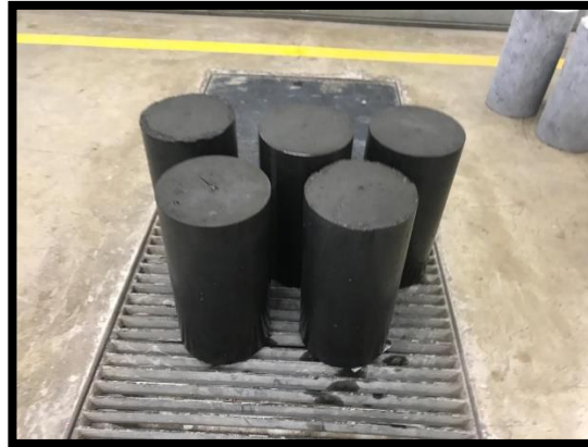
Figura 22 – Probetas con 5% de grafito del peso del cemento. (2019). Elaboración propia.
