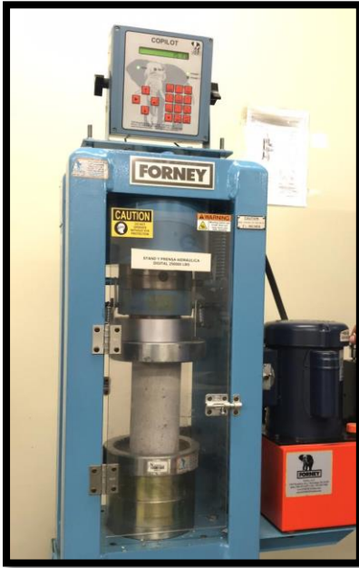
Figura 25 – Rotura de probeta del concreto convencional en la maquina de compresion. (2019). Elaboración propia.
