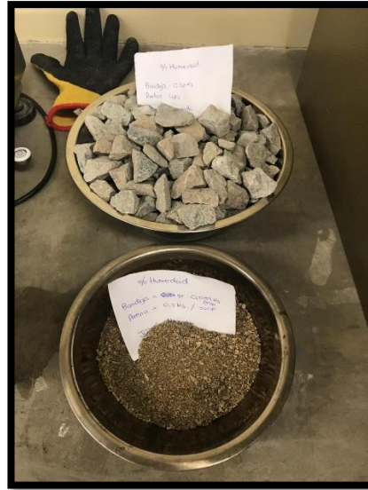
Figura 10 – Contenido de humedad de los agregados finos y gruesos (2019).
