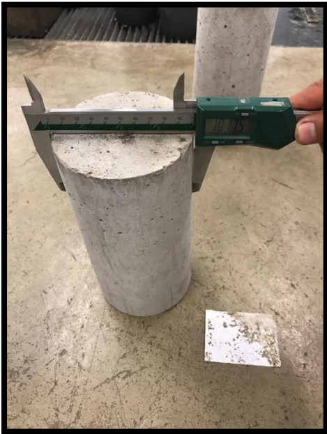
Figura 23 – Medición del diámetro de las probetas. (2019). Elaboración propia.
