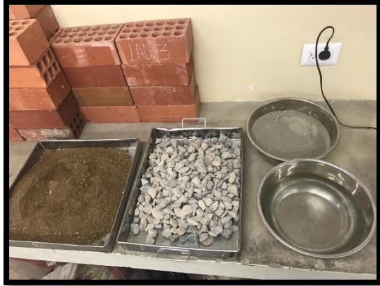
Figura 15 – Dosificación de los agregados y agua. (2019). Elaboración propia.
