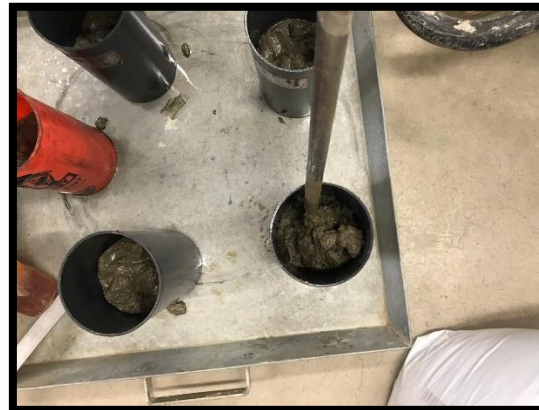
Figura 18 – Llenado de los moldes cilíndricos. (2019). Elaboración propia.
