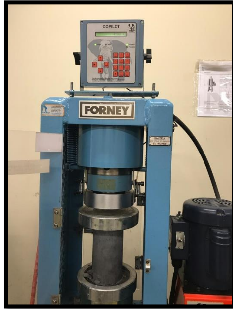
Figura 26 – Rotura de probeta del 5% de grafito del peso del cemento en la maquina de compresion. (2019). Elaboración propia.
