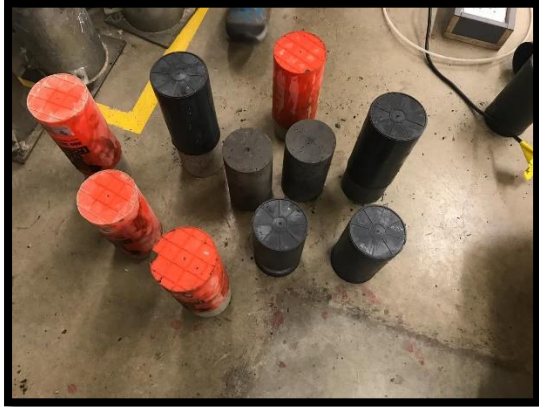
Figura 19 – Desenfofrado de las probetas cilíndricas. (2019). Elaboración propia.
