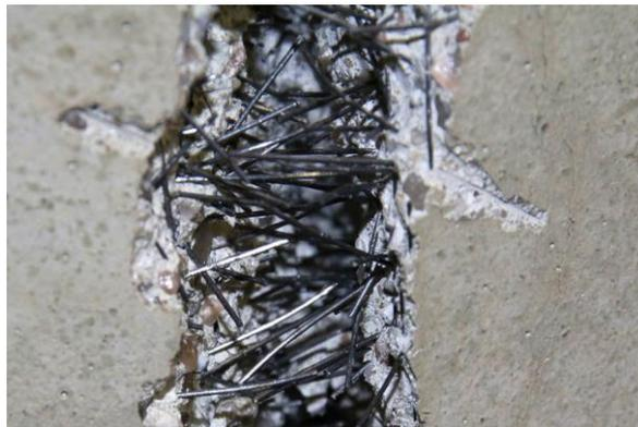
*Ilustración 9: Concreto reforzado con fibra de acero*
