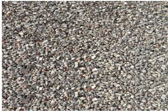
***Ilustración 18: Agregado grueso (confitillo)***
