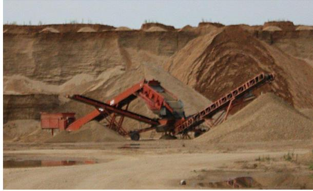
**Ilustración 17: Recolección de agregado fino con maquinaria**
