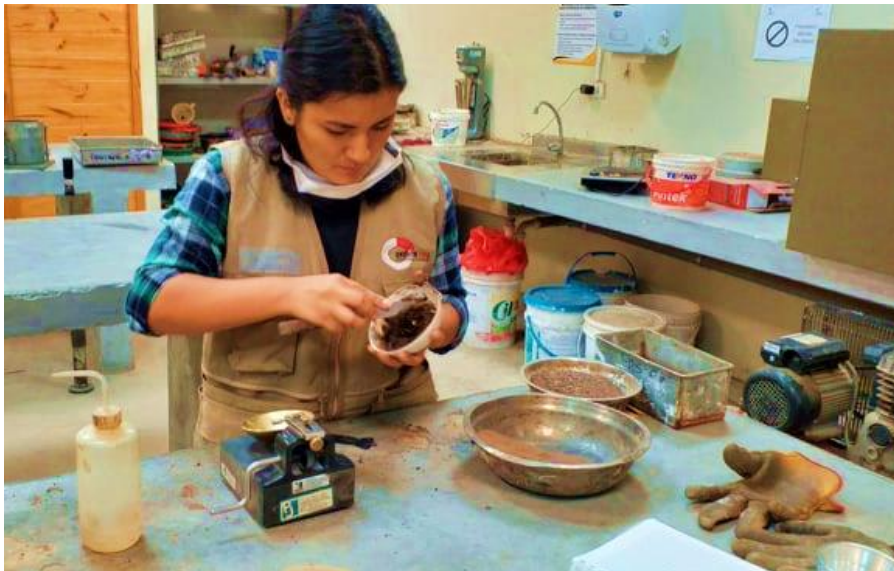
Figura N° 9: Ensayo de Límite Líquido
