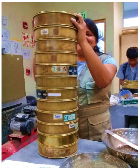
Figura N° 8: Ensayo de granulometría por tamizado
