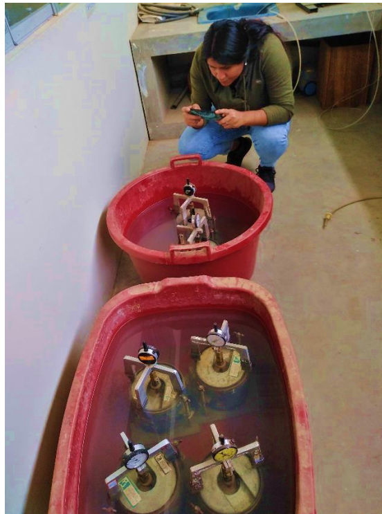
Figura N° 13: Ensayo de Hinchamiento
