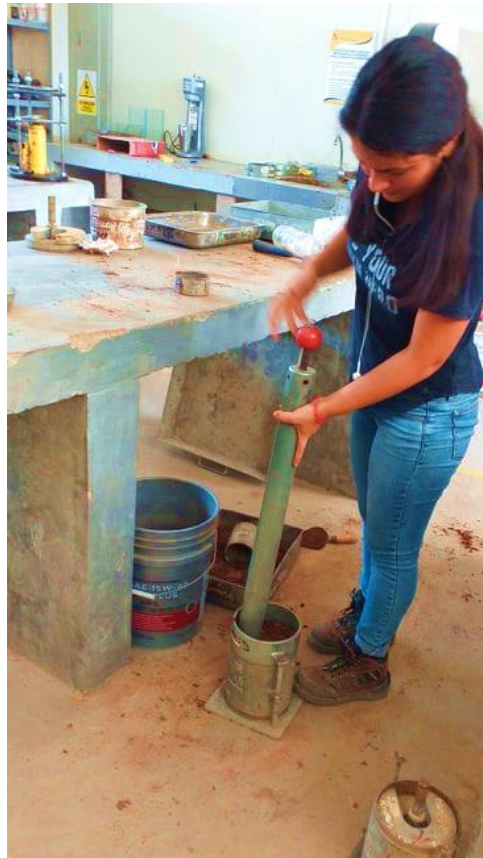
Figura N° 12: Ensayo de CBR
