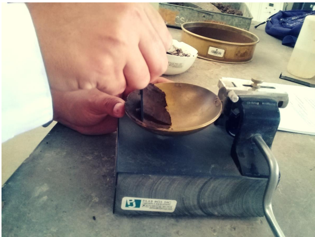
Fotografía N° 12: Ensayo del Límite Líquido
