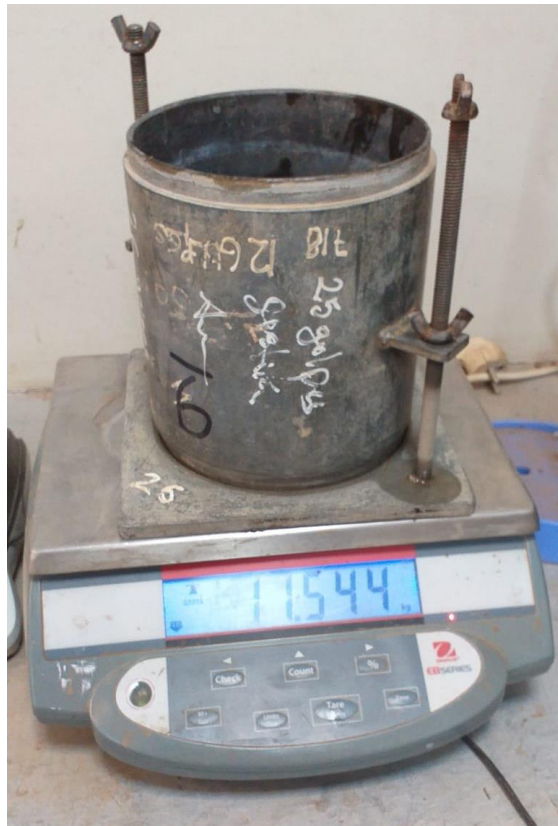
Fotografía N° 19: Peso de una muestra de CBR después de estar saturada.
