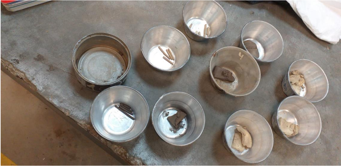
Fotografía N° 13: Muestras secas del ensayo de Límites de Atterberg.
