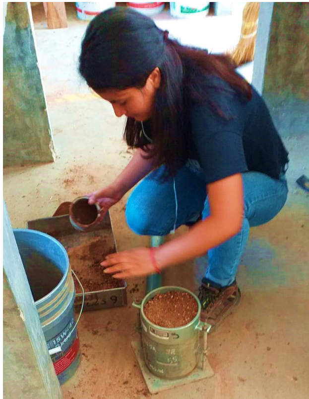
Fotografía N° 17: Ensayo de CBR usando molde “A”
