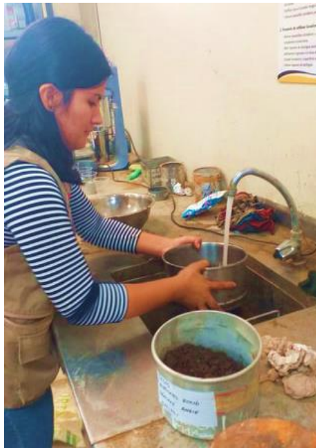
Figura N° 7: Ensayo de granulometría por lavado
