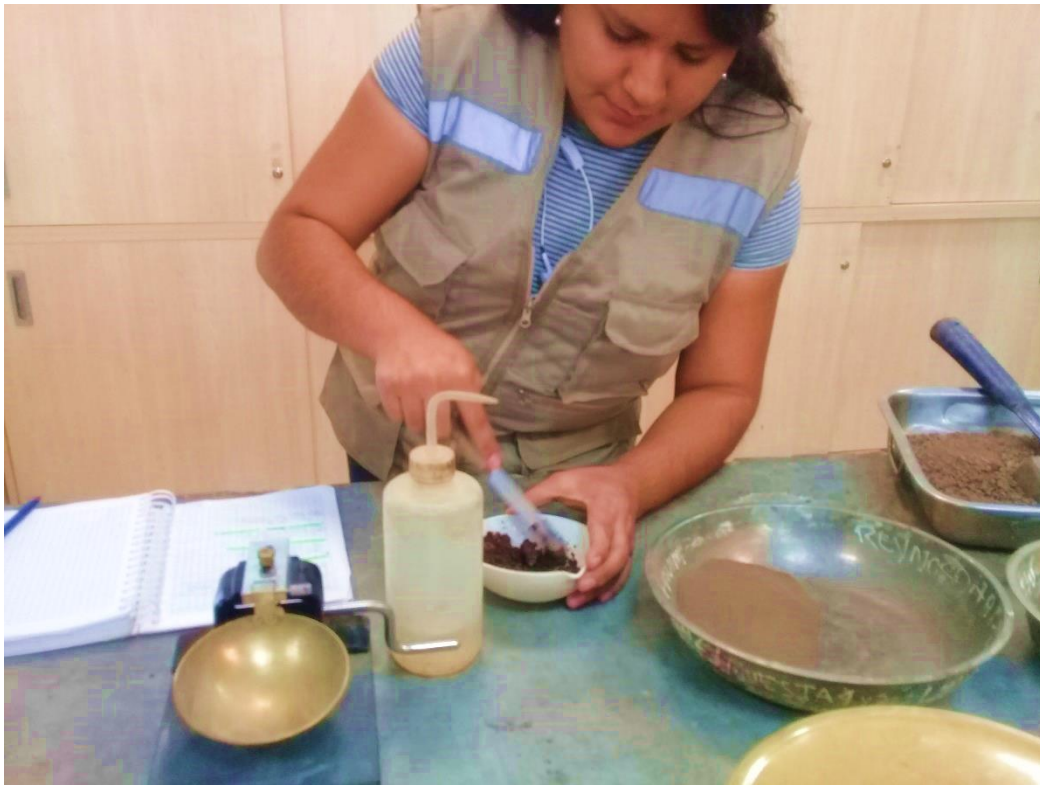
Fotografía N° 11: Ensayo del Límite de Plasticidad.
