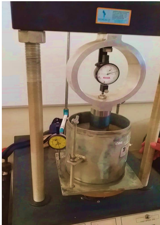
Figura N° 14: Ensayo de Penetración (CBR)
