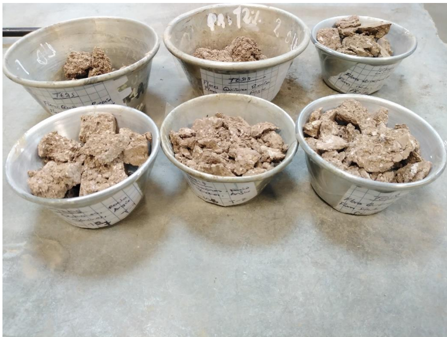
Fotografía N° 16: Muestras secas del núcleo del Proctor Modificado.
