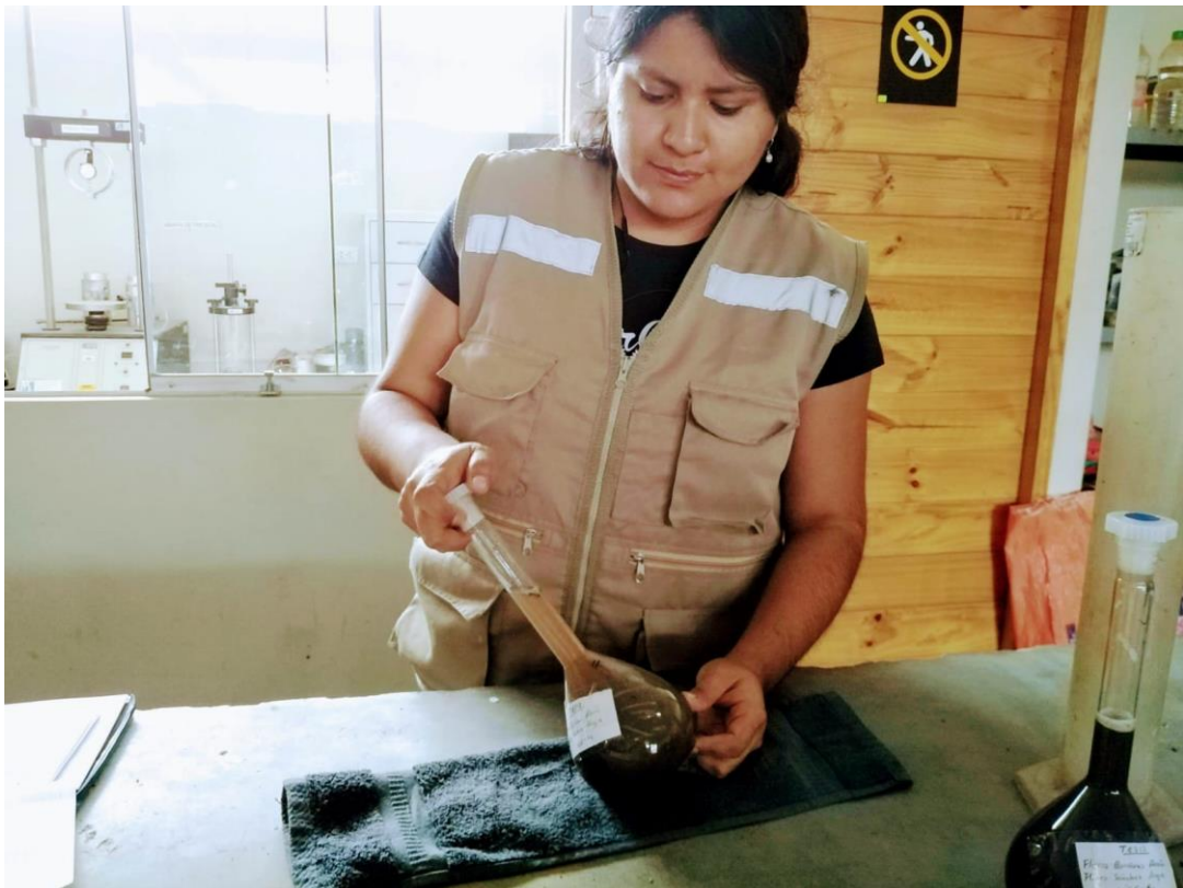
Fotografía N° 14: Ensayo de Peso Específico.
