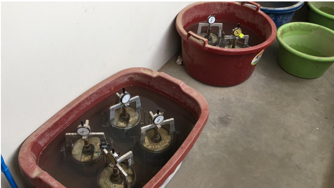
Fotografía N° 18: Saturación de las muestras de CBR.
