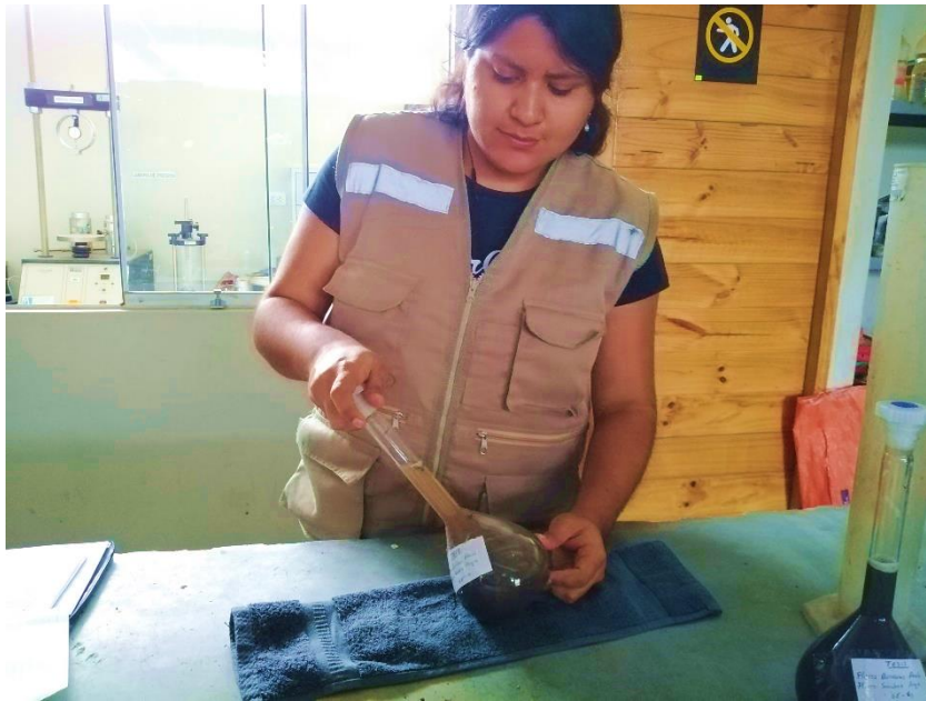
Figura N° 11: Ensayo de Peso Específico
