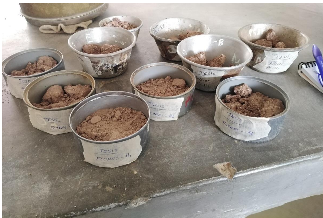
Fotografía N° 10: Muestras para el ensayo de contenido de humedad.
