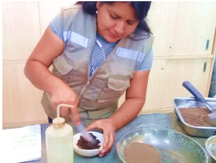
Figura N° 10: Ensayo del Límite Plástico
