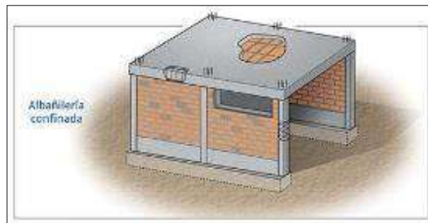
Figura 8. Vivienda de albañilería confinada.
