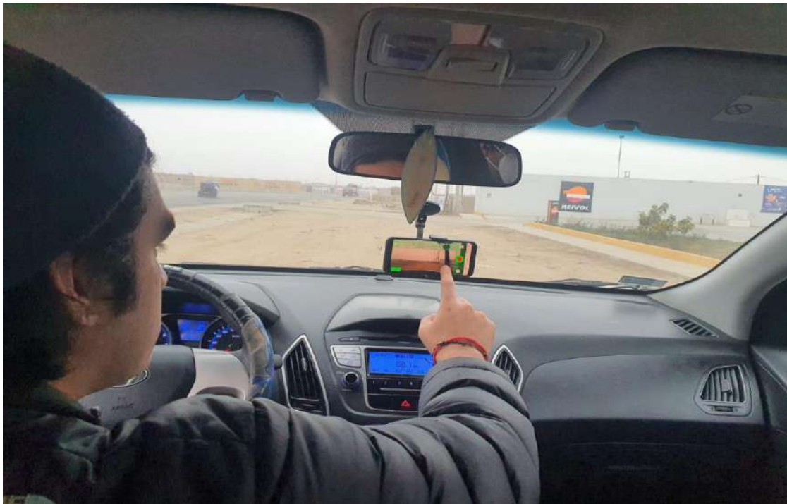
Estabilización y puesta en marcha del dispositivo Roadroid.
