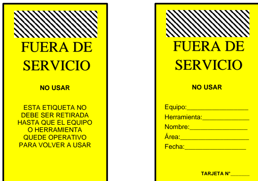
Figura 3. Tarjeta amarilla de identificación de equipos o herramientas inseguras.
