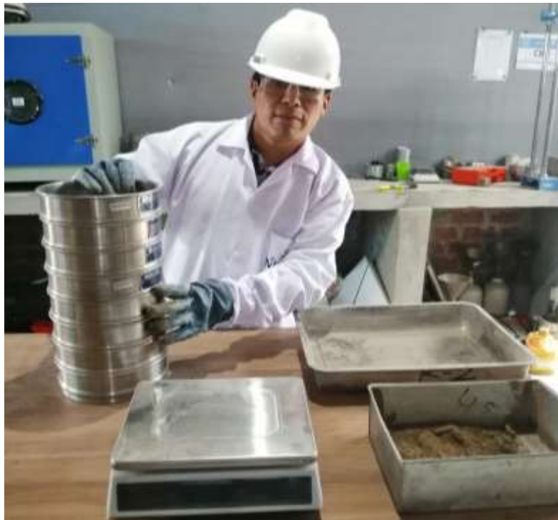
Figura 15. Análisis granulométrico del laboratorio Tamizado ASTM D-422 Y ASSHTO T88.
