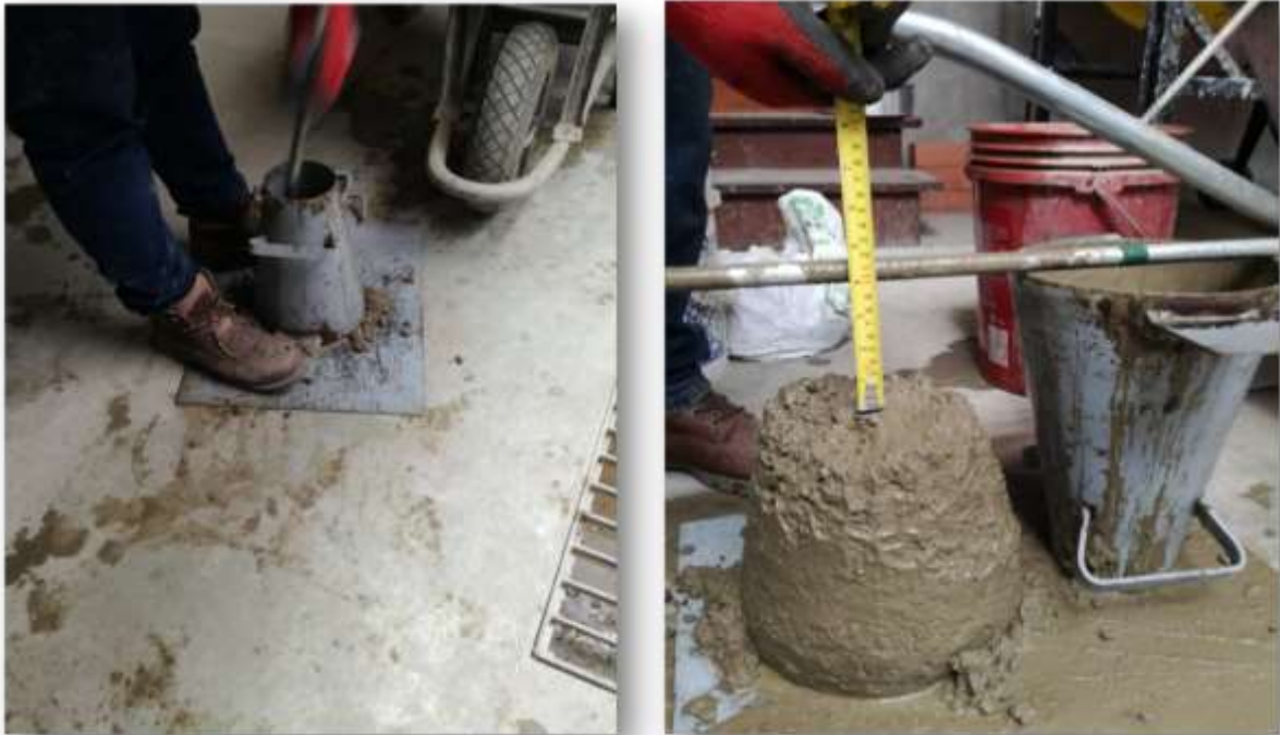
Figura 3. Preparación del cono de Abrams y medida del asentamiento.
