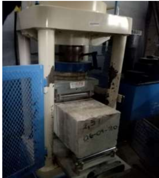
Figura 24. Colocación adecuada del espécimen, según medidas.
