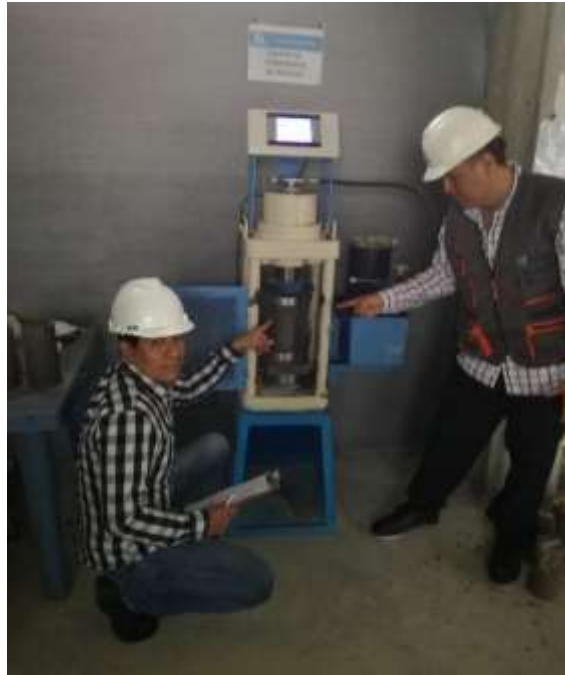
Figura 21. Ensayo a Compresión
