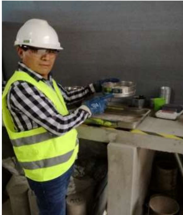
Figura 9. Tamizado (N°4) de la fibra de vidrio
