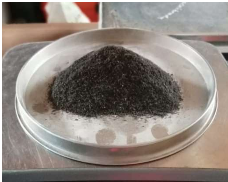
Figura 12. Tamizado del polvillo de acero con el Tamiz N° 200.
