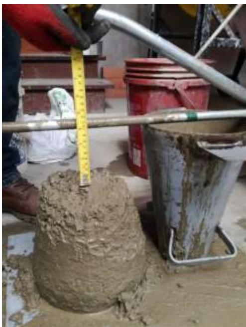
Figura 18. Toma de medida del Slump.
