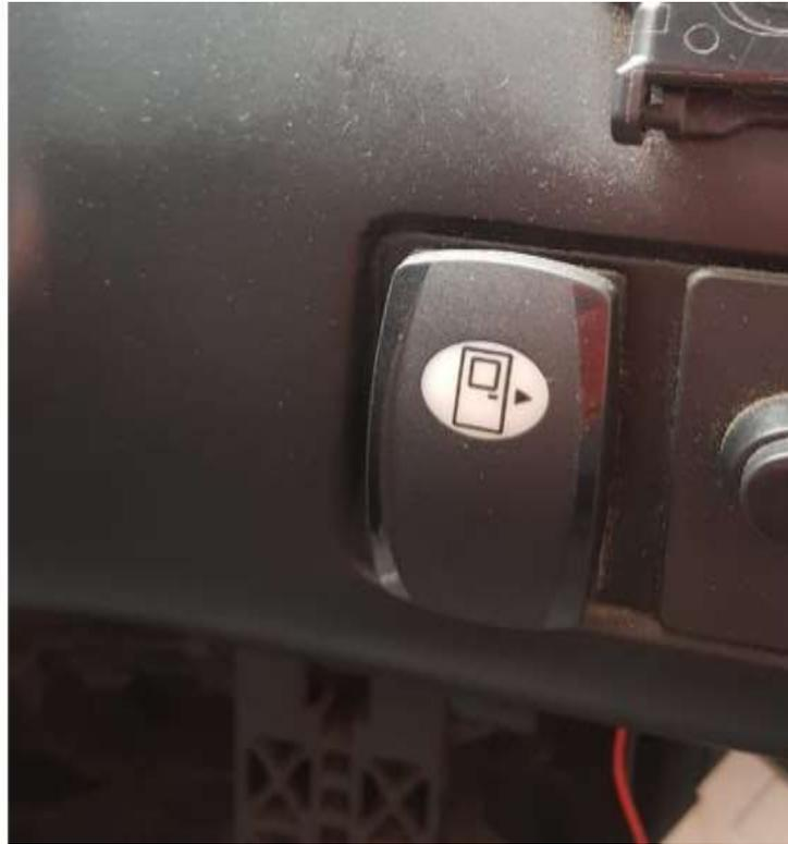
*Figura 44:* Mando para la Apertura y Cierre de la Puerta del Bus
