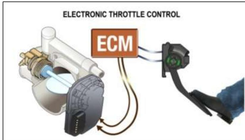
Figura 7: Sistema de Aceleración Electrónica Controlado por Medio de la ECU del Motor
