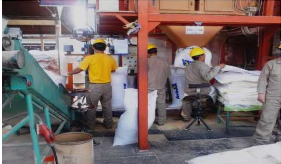
El producto es empaquetado en sacos de 50 Kg. Es en esta parte del proceso donde se toman muestras para llevar a cabo el control de calidad, posteriormente es almacenado para luego ser despachado a las granjas.
