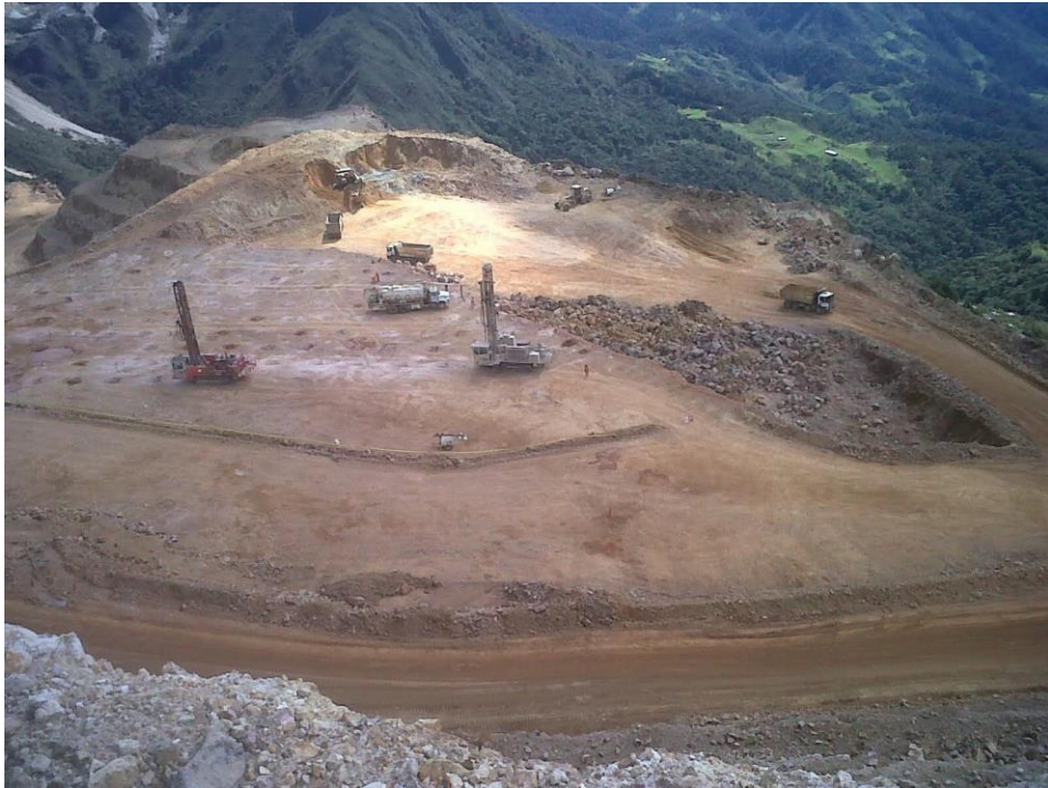
Foto 1. Área de perforación y voladura de la mina a tajo abierto en Cajamarca
