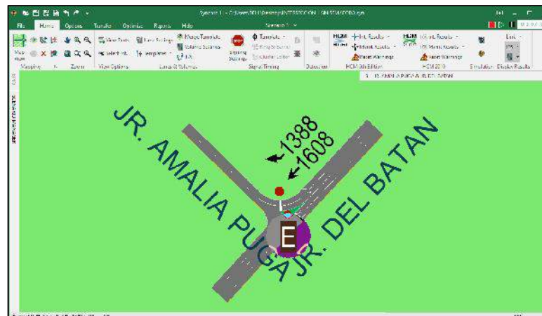
Figura 24: Nivel de Servicio al implementar la propuesta en la Intersección 1 a través de la simulación en software Synchro 11.0.
