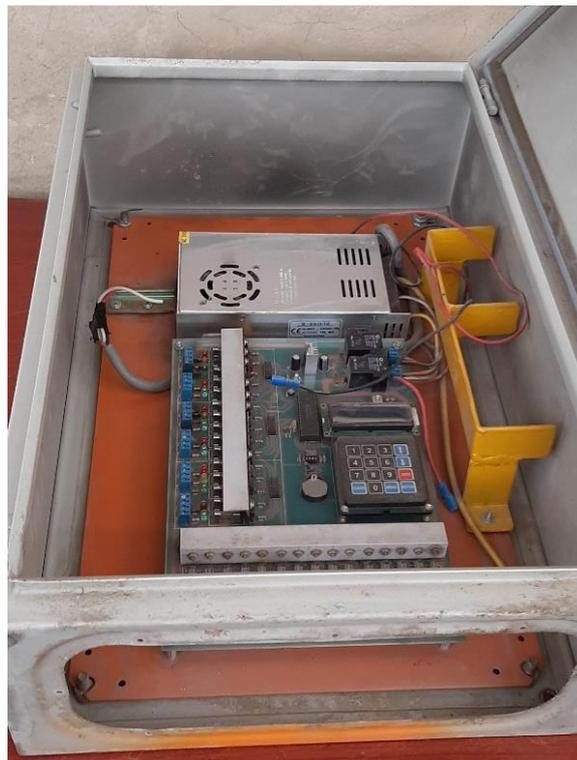
*Figura 05:* la figura 05 nos muestra el controlador de tráfico que estaba en funcionamiento, pero por ahora se encuentra en reparación, pero por falta de componentes no se pone en funcionamiento.
