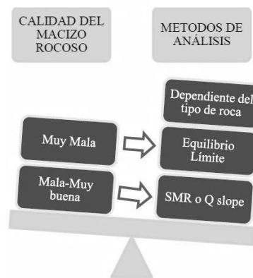
Figura 4. Criterios para la determinación del método de análisis según el tipo de roca
