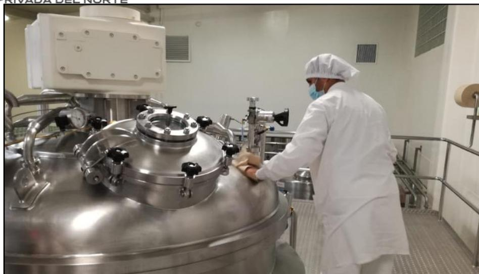
Figura 52: Limpieza externa del MH 5TN
