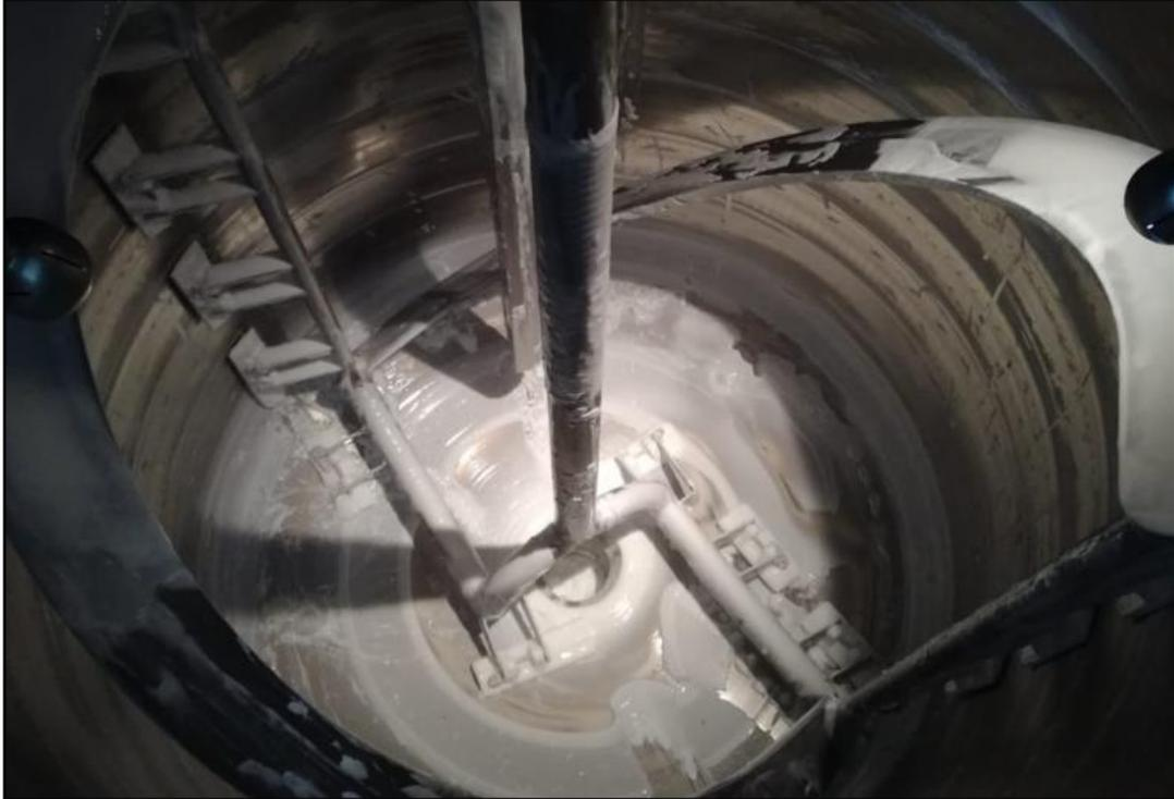
*Figura 54:* Proceso de fabricación de cremas en el Bulk (MH 5TN)
