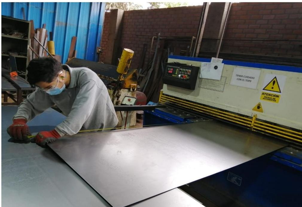
*Figura 17. Máquina Guillotina ZDMT.
