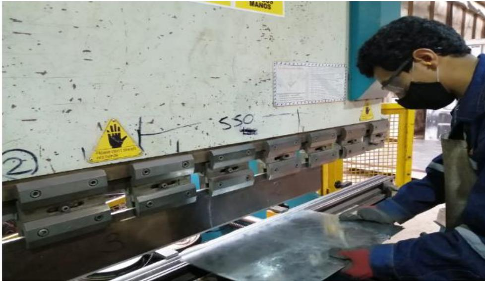
*Figura 16. Máquina Dobladora ZDMT.
