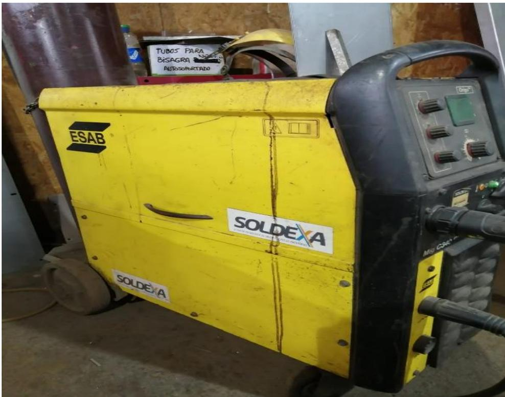
*Figura 15. Equipo para soldar mig
