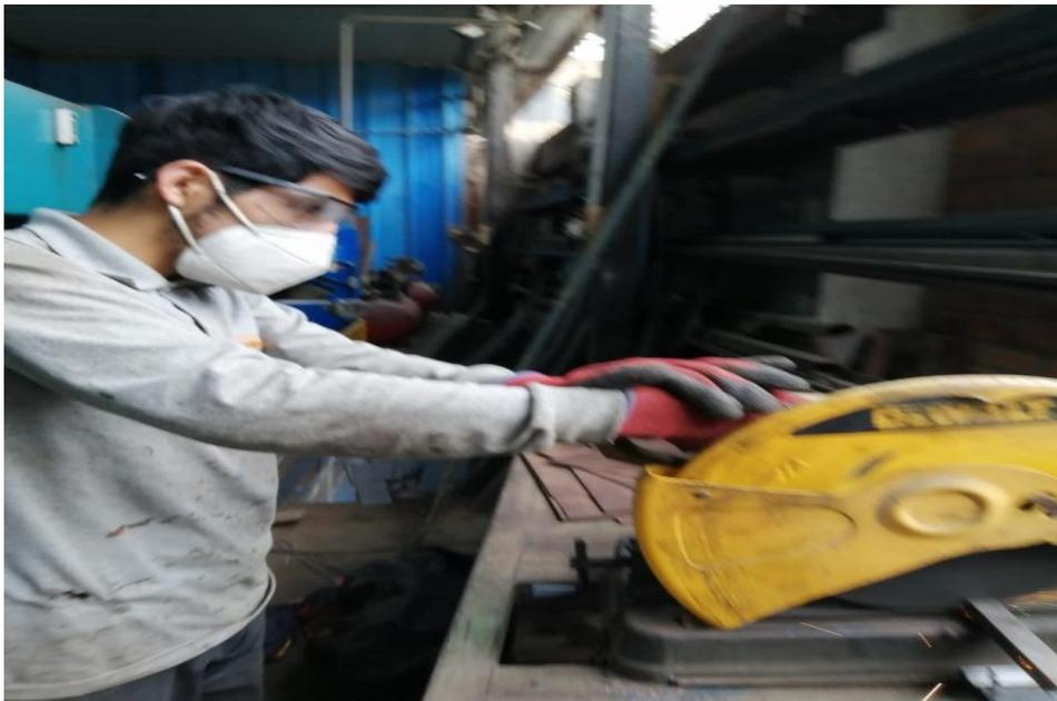
*Figura 21. Máquina tronzadora.*
