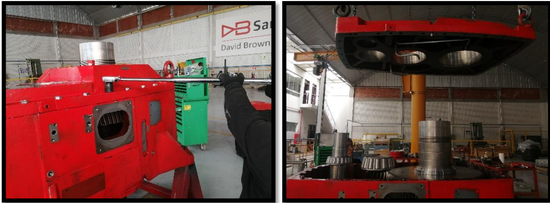
Figura 46: Colocado de tapa superior y torqueado de pernos.
