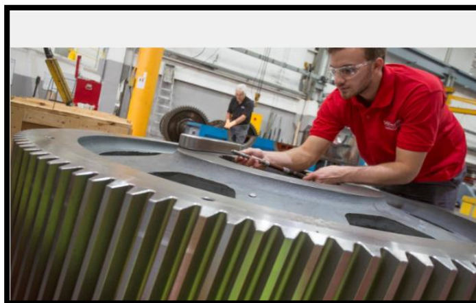
Figura 36: Reparación de caja de engranajes.
