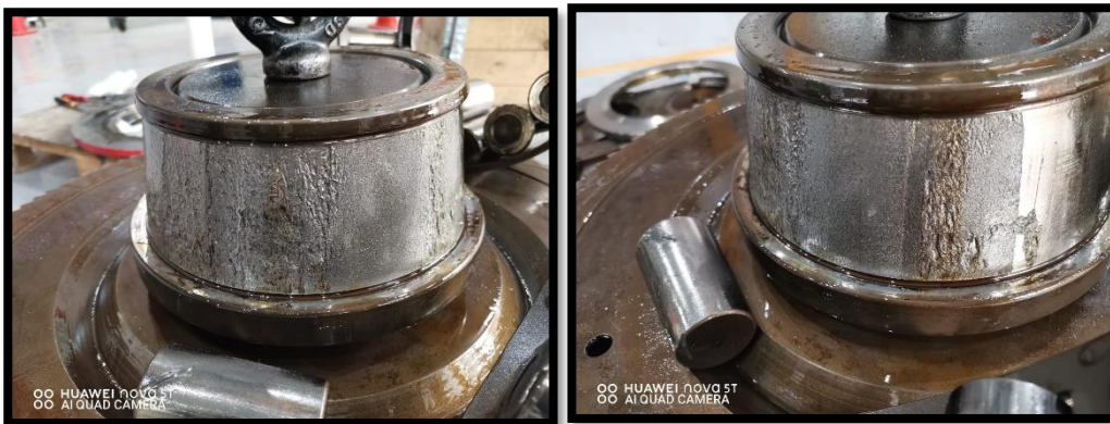
Figura 23: Ejemplo de inadecuada de montaje de rodamientos
