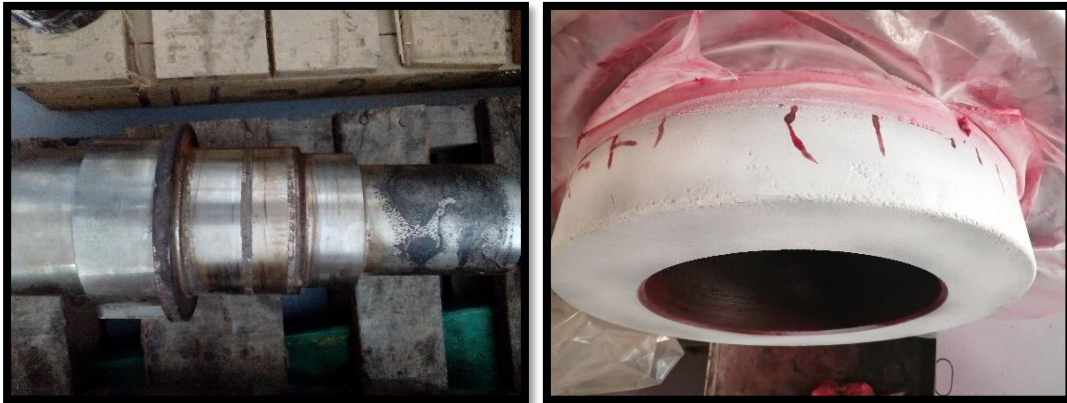
Figura 26: Ejemplo de fisura en los ejes y fuga de aceite.
