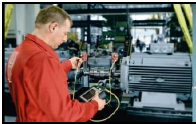
Figura 43: Monitoreo a condición.
