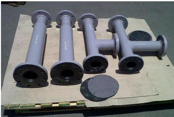
*Figura 11. Spool de tubería*
