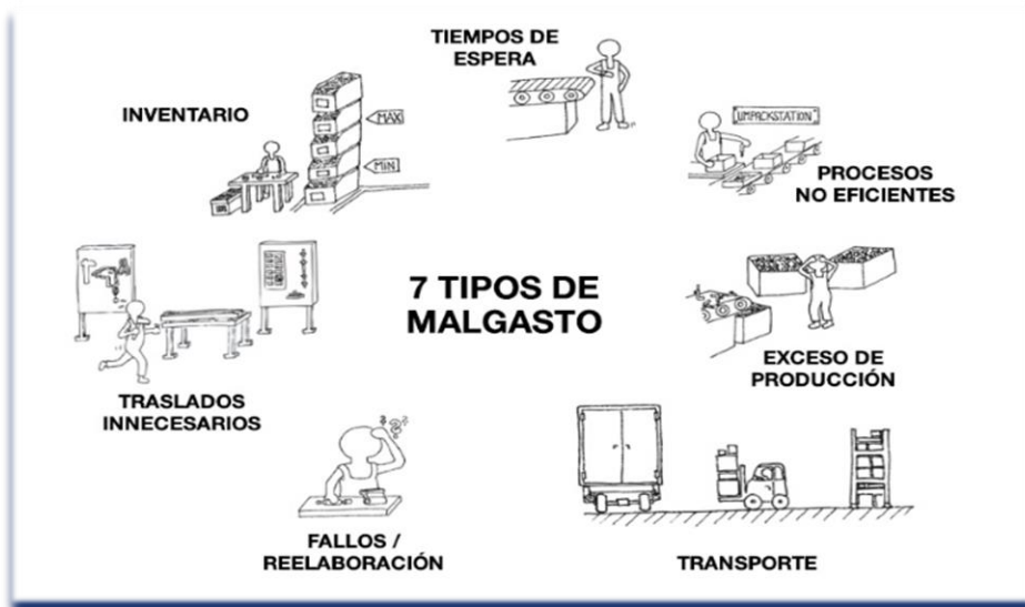
Figura n° 7. Identificación De Desperdicios En El Proceso De Fabricación
