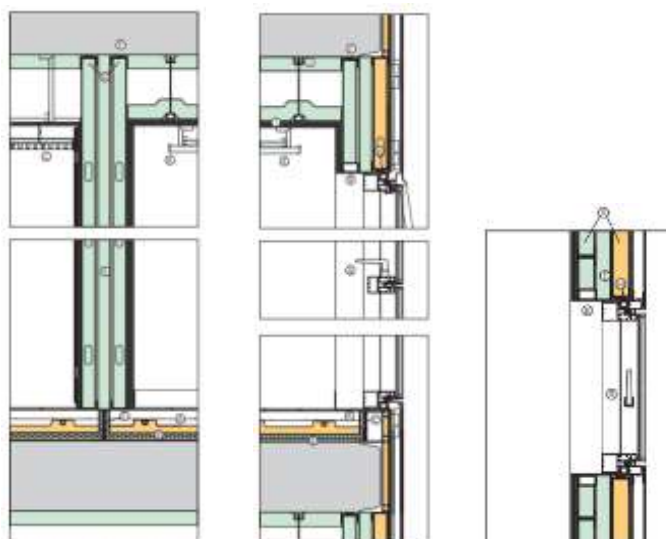
Figura 35 Detalle de muro con sistema tipo sándwich
