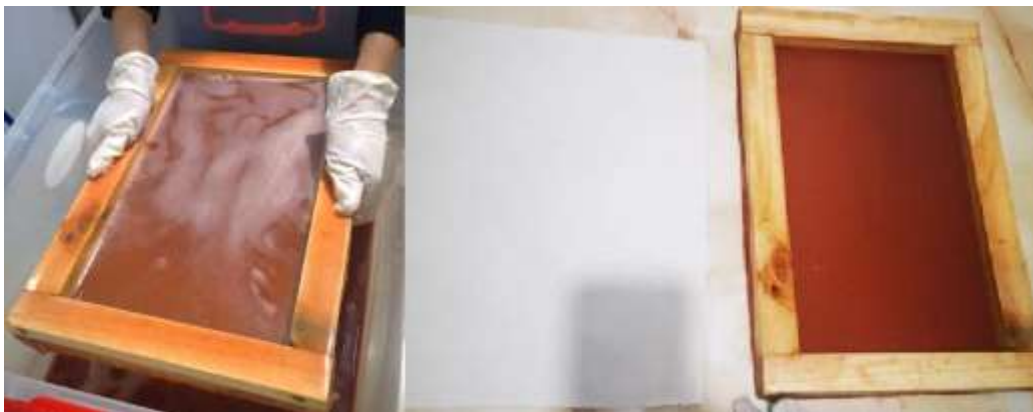
Figura 36. Material de trabajo de las primeras pruebas, marco, contramarco, tela de algodón y contenedor.
