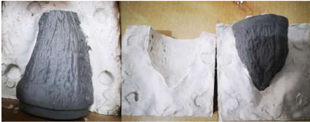
Figura 43. Vaciado en yeso y extracción de la plastilina. Fuente: Autor.
