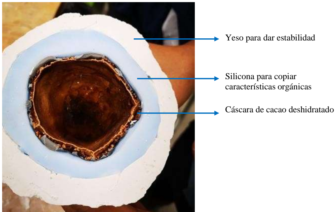
Figura 40. Proceso de extracción del molde. Fuente: Elaboración propia.
