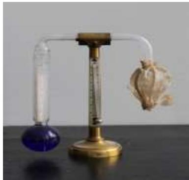
Figura 12. Higrómetro de condensación
