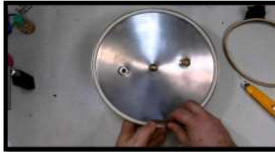
Figura 13. Proceso colocar perillas y pernos
