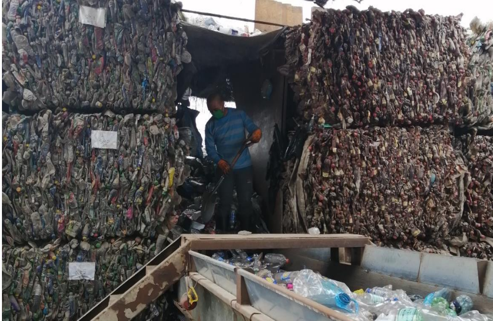
Figura 1. Material PET ingresando a faja de transporte. Un trabajador mueve manualmente hacia la franja transportadora todo el material PET que fue apilado por el montacarga.
