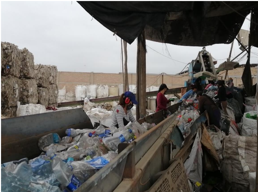
Figura 2. Selección de material PET por colores. El material es trasladado por la faja hacia el molino. Antes, un grupo de trabajadoras separa los materiales por colores en sacos ubicados en los laterales.
