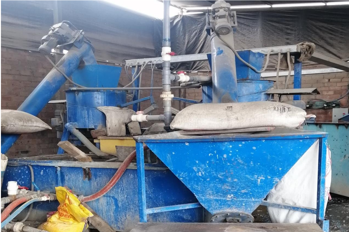
Figura 6. Máquina de molido. En esta ingresa el plástico duro en su forma entera o molida, según haya sido comprado.
