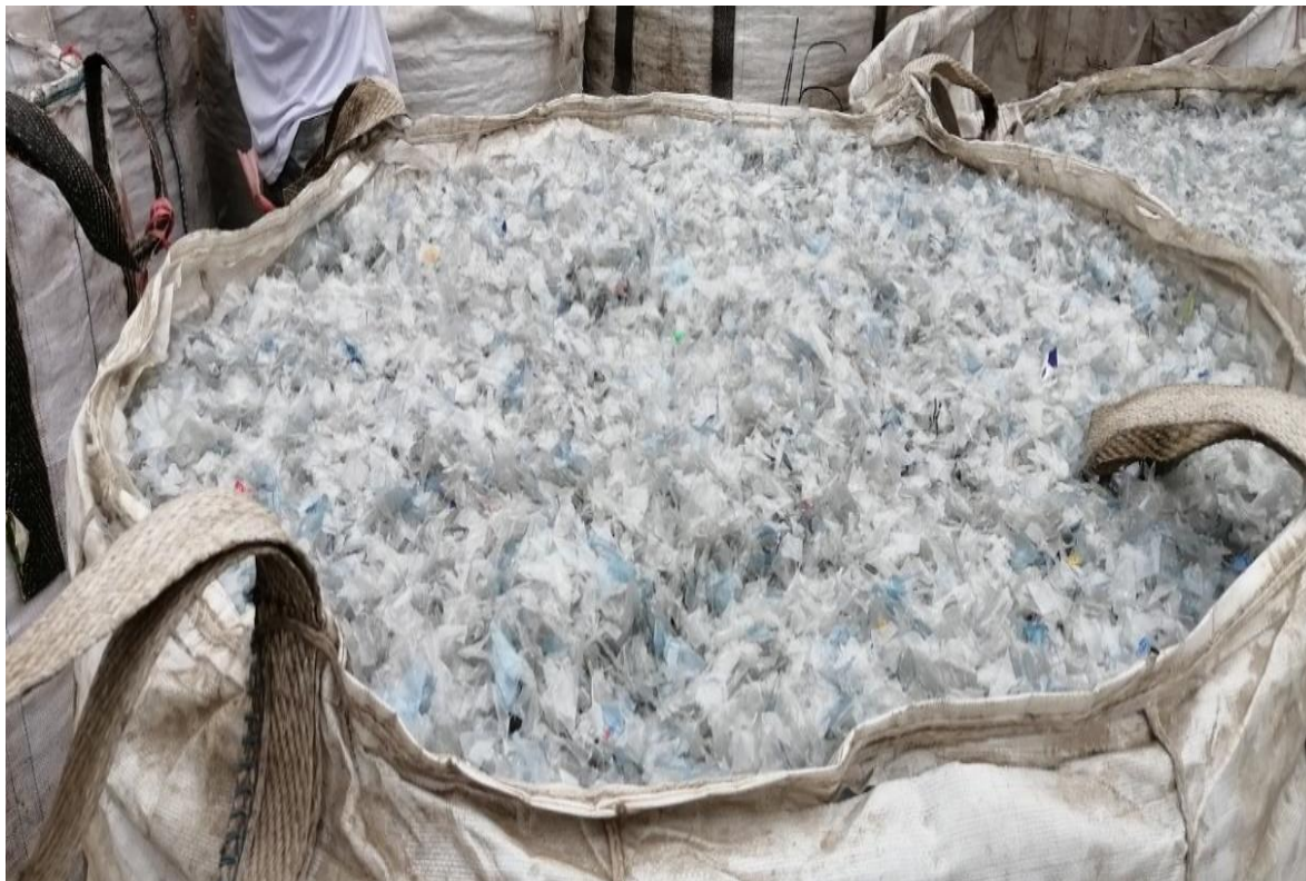
Figura 5. Estado final del PET molido y prelavado. El material se coloca en sacos de 300 kg. para su traslado y lavado.
