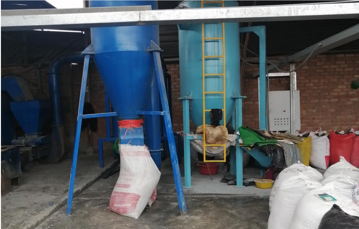
Figura 8. Máquina secadora. Este equipo funciona con carbón y permite secar los materiales a altas temperaturas.
