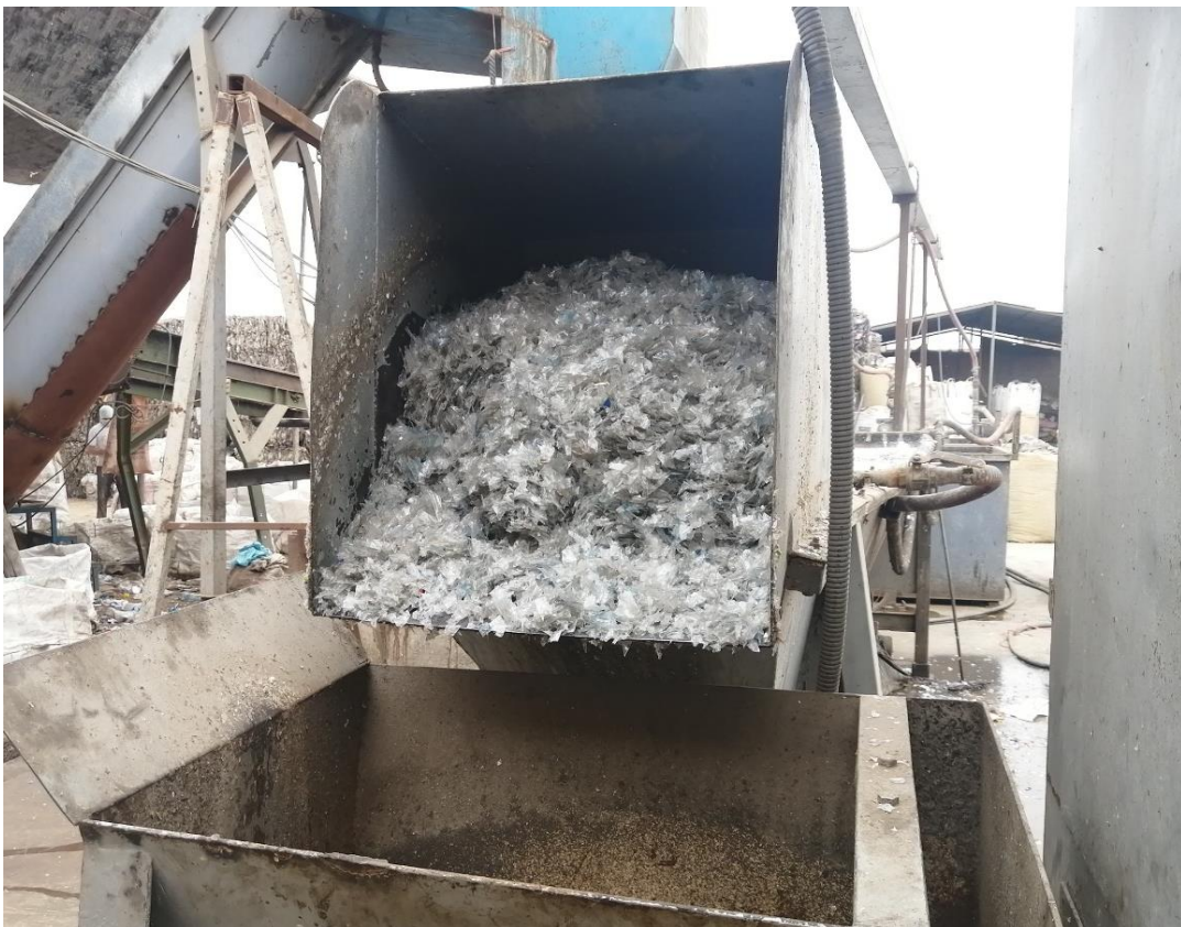
Figura 4. Imagen del PET molido. Este material ingresa incluso con etiqueta, pero sin tapa. La máquina separa previamente los componentes.
