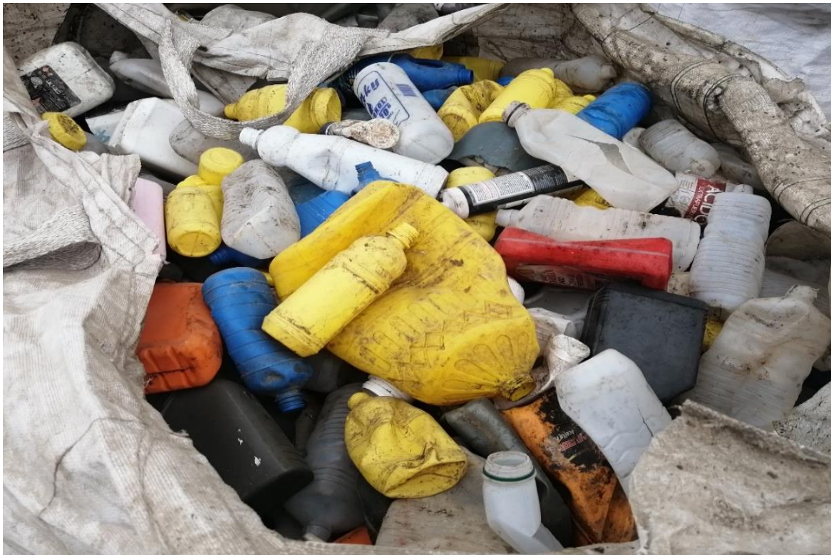
Figura 13. Imagen de muestra de envases de plástico duro ingresados a planta para ser procesados. Estos también ingresan en bruto, con etiqueta y tapa.
