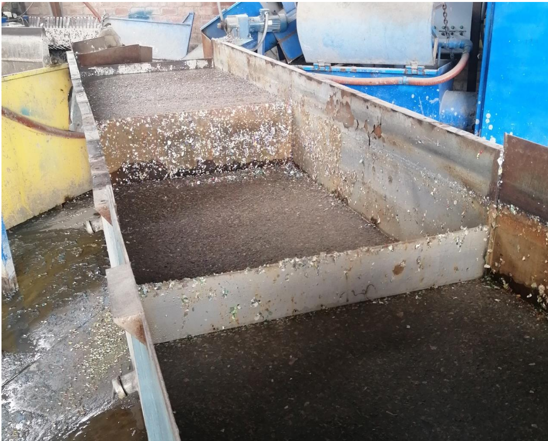
Figura 7. Máquina lavadora de plástico duro. En este equipo se aplican diversos insumos de alta concentración química, para desinfectar los diversos materiales que ingresan.
