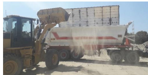
Figura 6 PROCESO DE LLENADO DE ARENA CATODINA A VOLQUETES DE 20 TN
