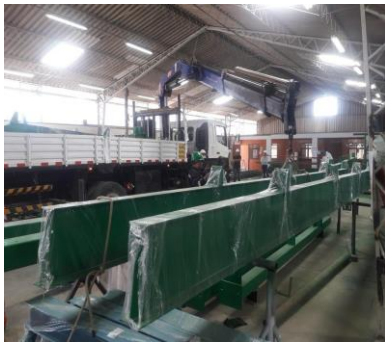
Figura 3. PROCESO DE RETIRO DE VIGAS CON CAMION GRUA
