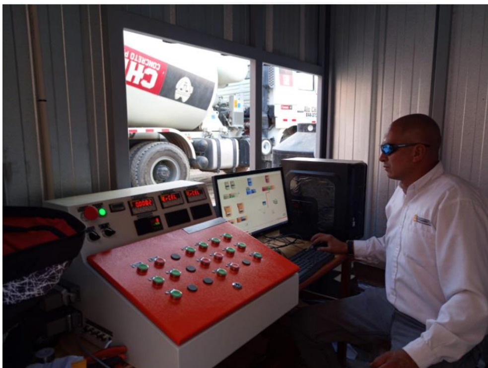
Figura 4. Automatizacion de planta dosificadora de concreto chimu Concreto Peru (Trujillo) 2018 Fuente : Elaboracion propia (2020)
