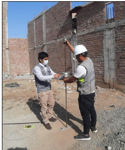
Foto 02: Ensayo de DPL, para una profundidad máxima de 3m.
