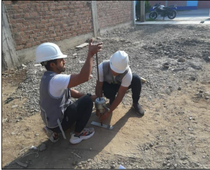
Foto 03: Ensayo de DPL, para una profundidad máxima de 3m
