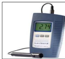
**Figura 21:Salinómetro para medición el % de sal**
