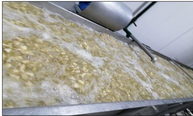
**Figura 36:Desalado de la alcachofa con burbujeo**
