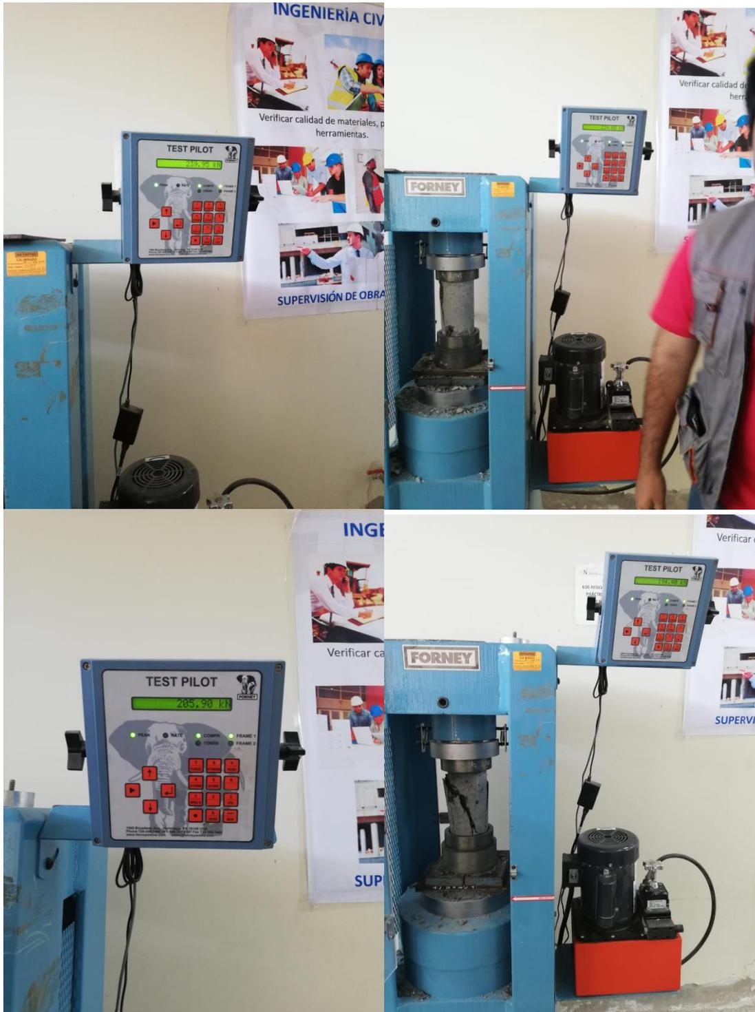
*Ilustración 21: Ensayo de resistencia a la compresión*
