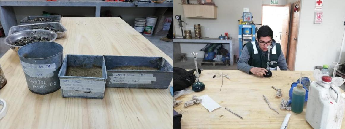
*Ilustración 8: Peso específico y Porcentaje de Absorción del agregado grueso, fino y CCA.*
