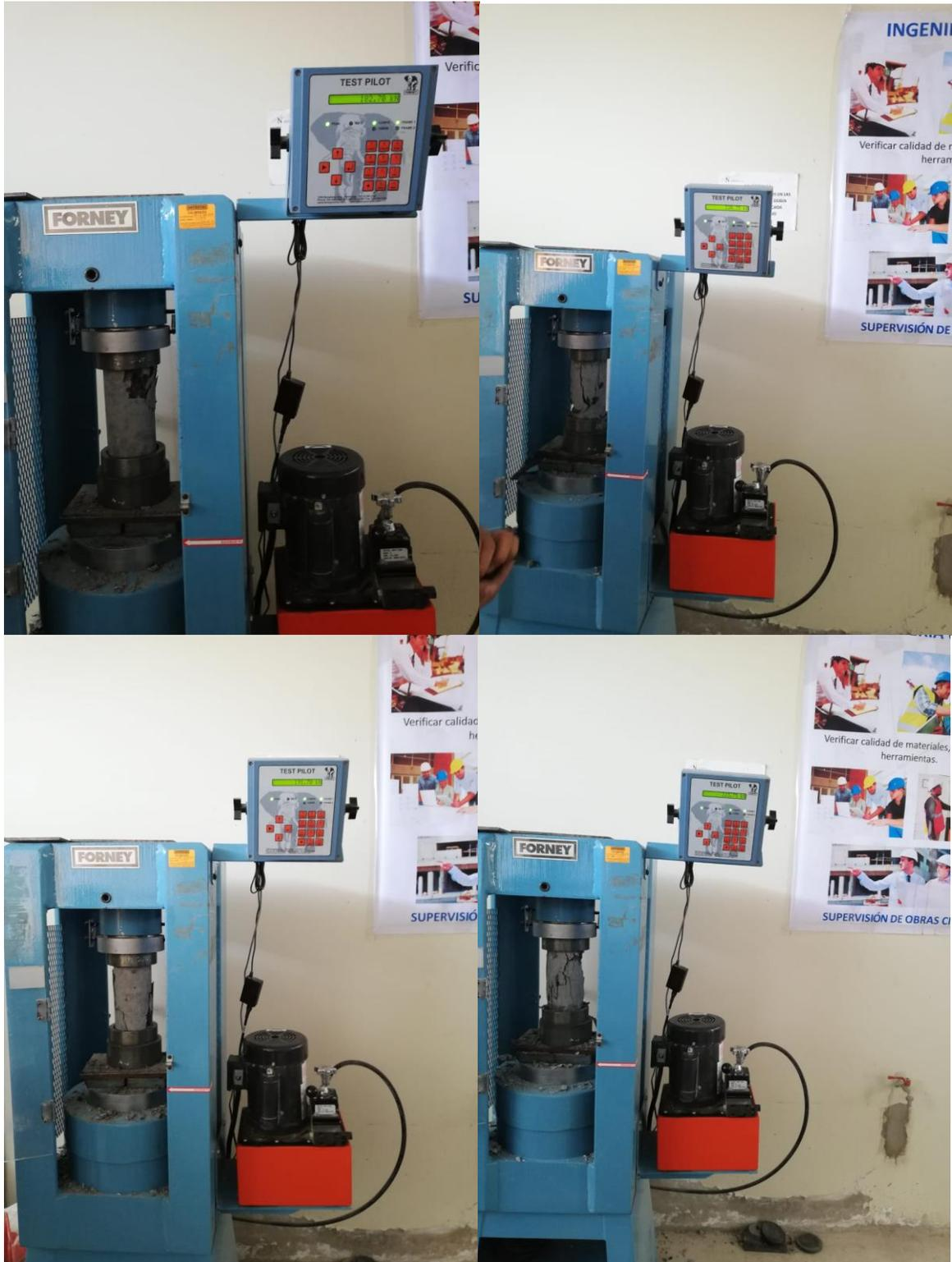
*Ilustración 18: Ensayo de resistencia a la compresión*
