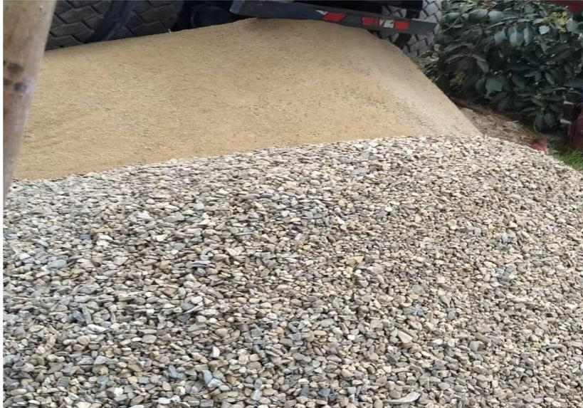
*Ilustración 4: Agregados grueso y fino.*
