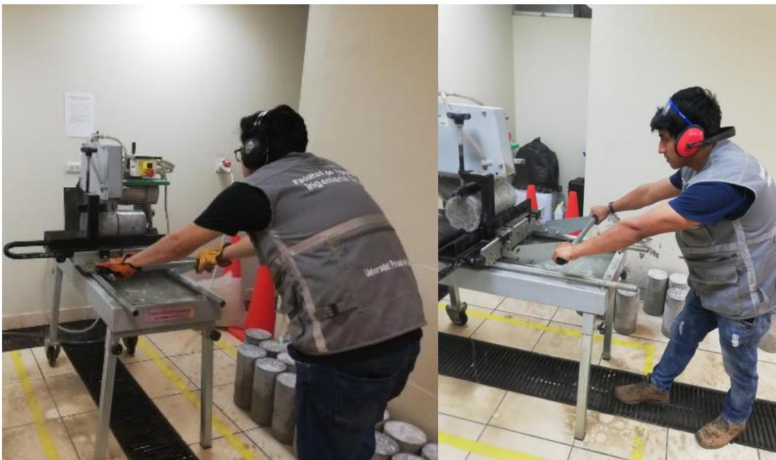
*Ilustración 13: Cortado de probetas cilíndricas para ensayo de profundidad de penetración.*
