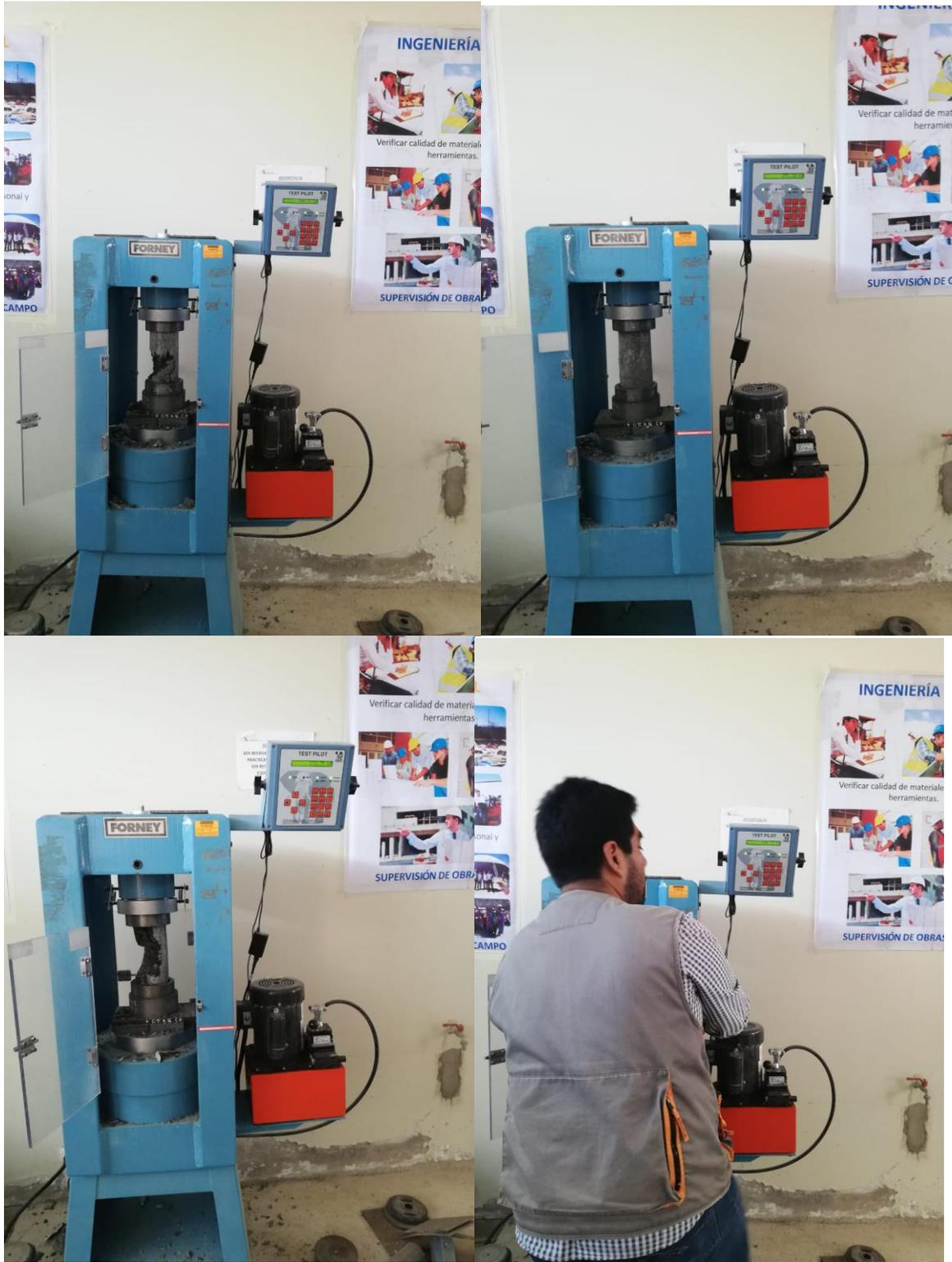
*Ilustración 19: Ensayo de resistencia a la compresión*
