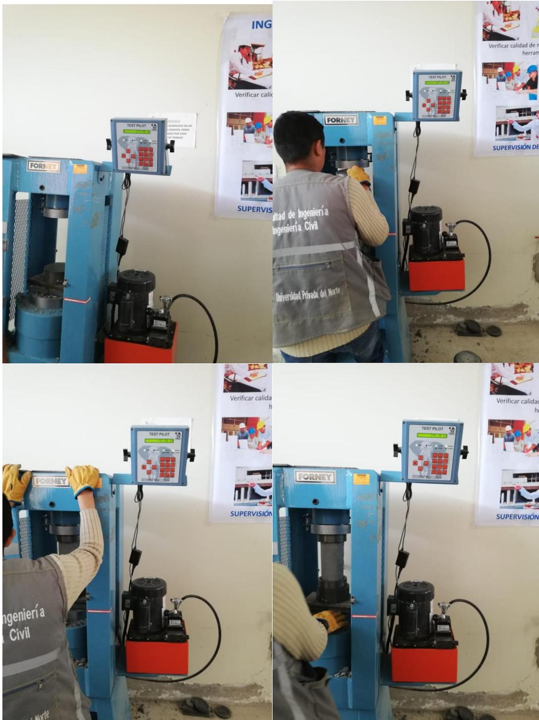
*Ilustración 16: Ensayo de resistencia a la compresión*
