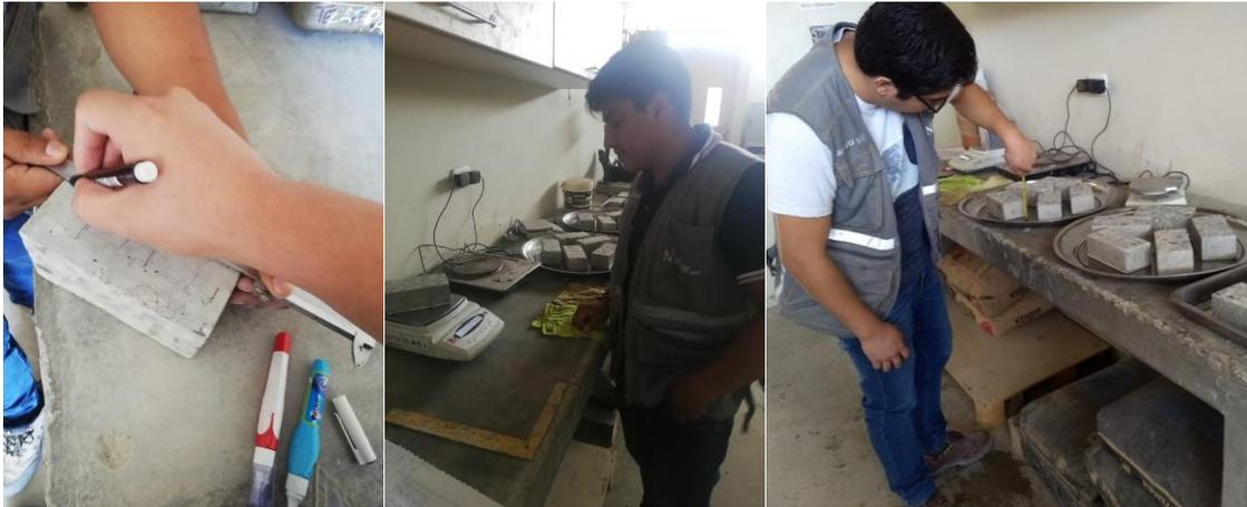
*Ilustración 12: Ensayo velocidad de succión capilar.*
