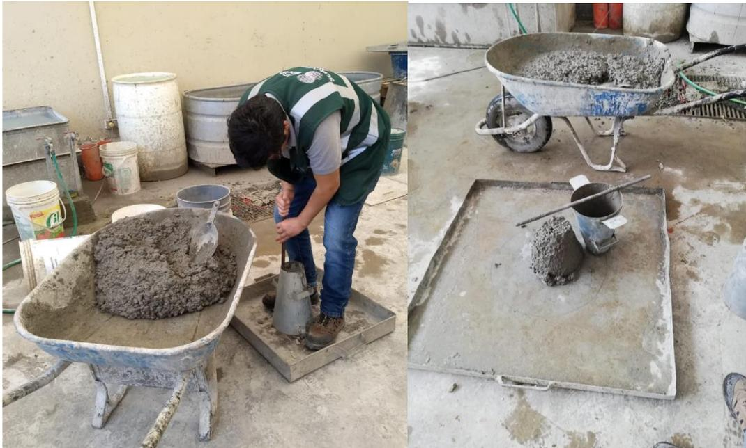
*Ilustración 10: Ensayo slump*
