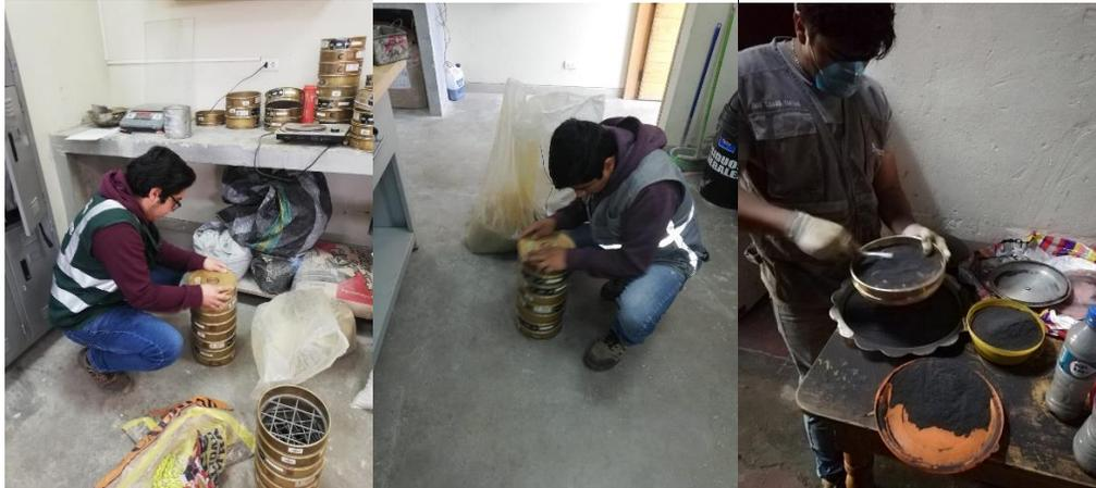
*Ilustración 6: Análisis granulométrico de los materiales.*
