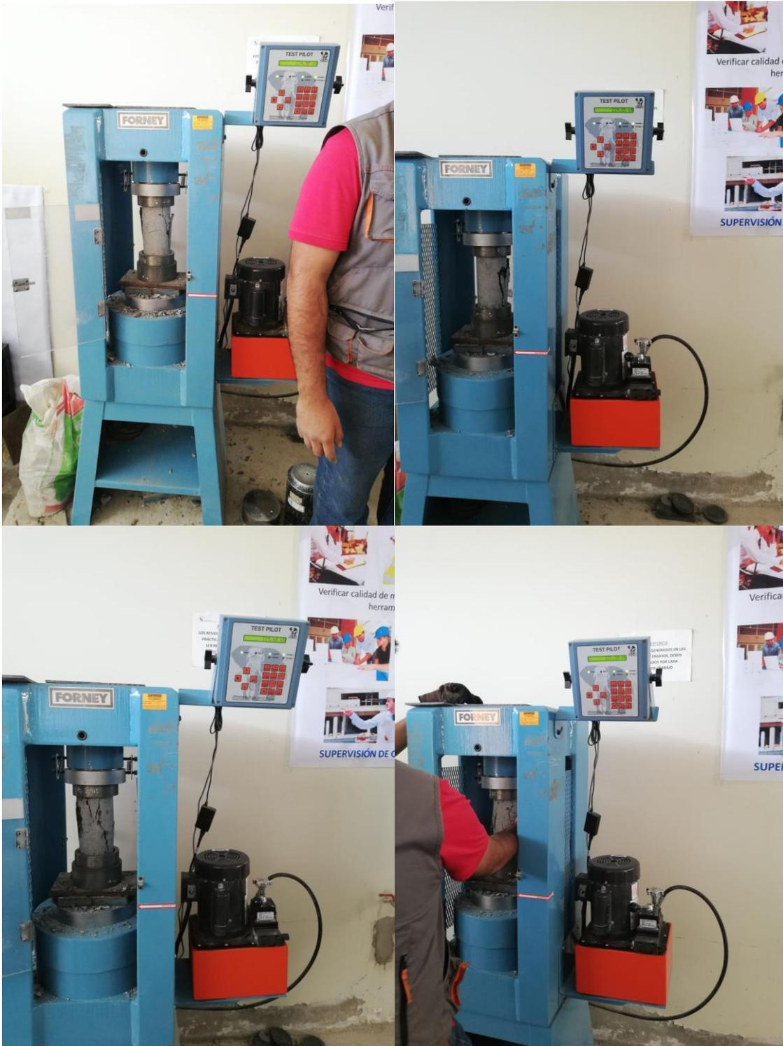
*Ilustración 17: Ensayo de resistencia a la compresión*
