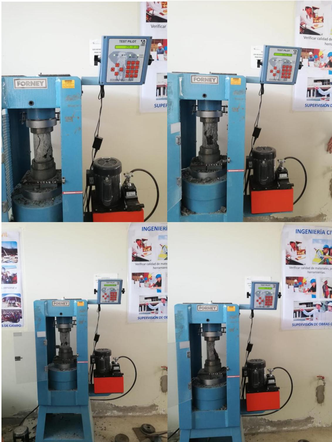
*Ilustración 20: Ensayo de resistencia a la compresión*
