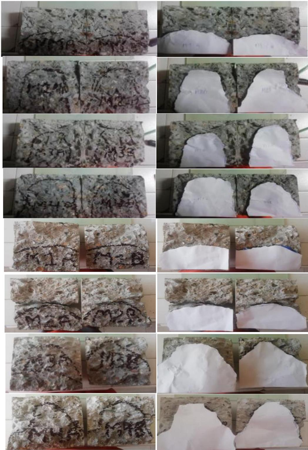
*Ilustración 14: Ensayo de penetración por agua*
