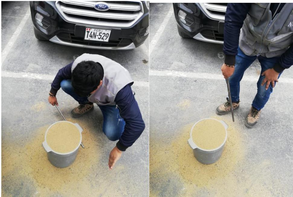
*Ilustración 7: Peso unitario suelto y compactado del agregado fino.*
