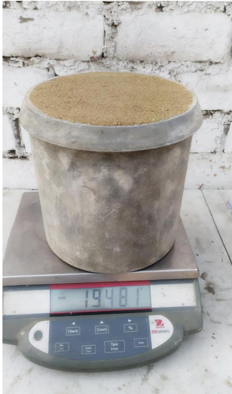
*Figura 47: Resultado del peso unitario compactado del agregado fino*
