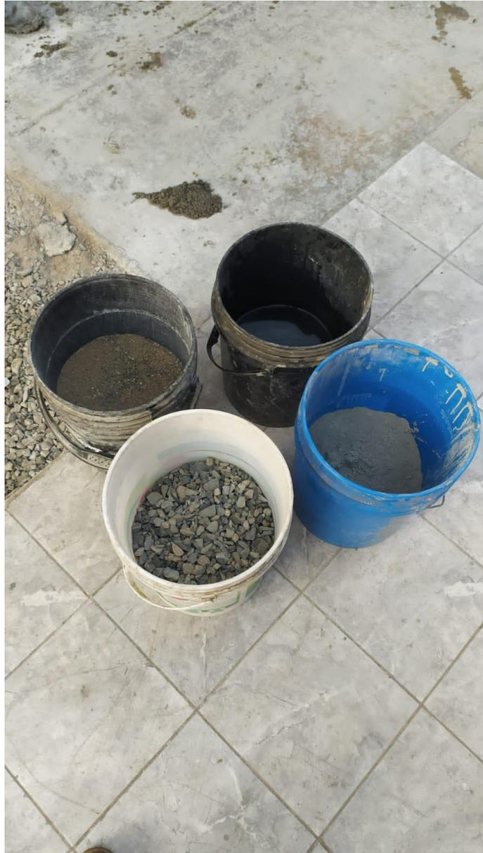
*Figura 55: Agregados para el concreto*
