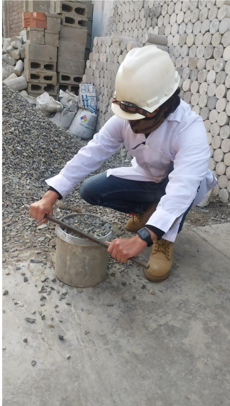
*Figura 48: Peso unitario suelto del agregado grueso*
