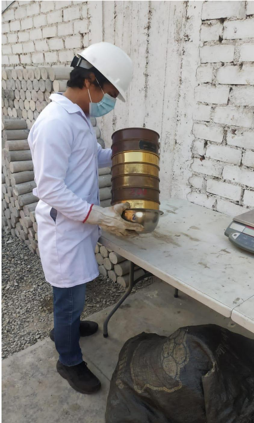
*Figura 43: Análisis granulométrico del agregado grueso*
