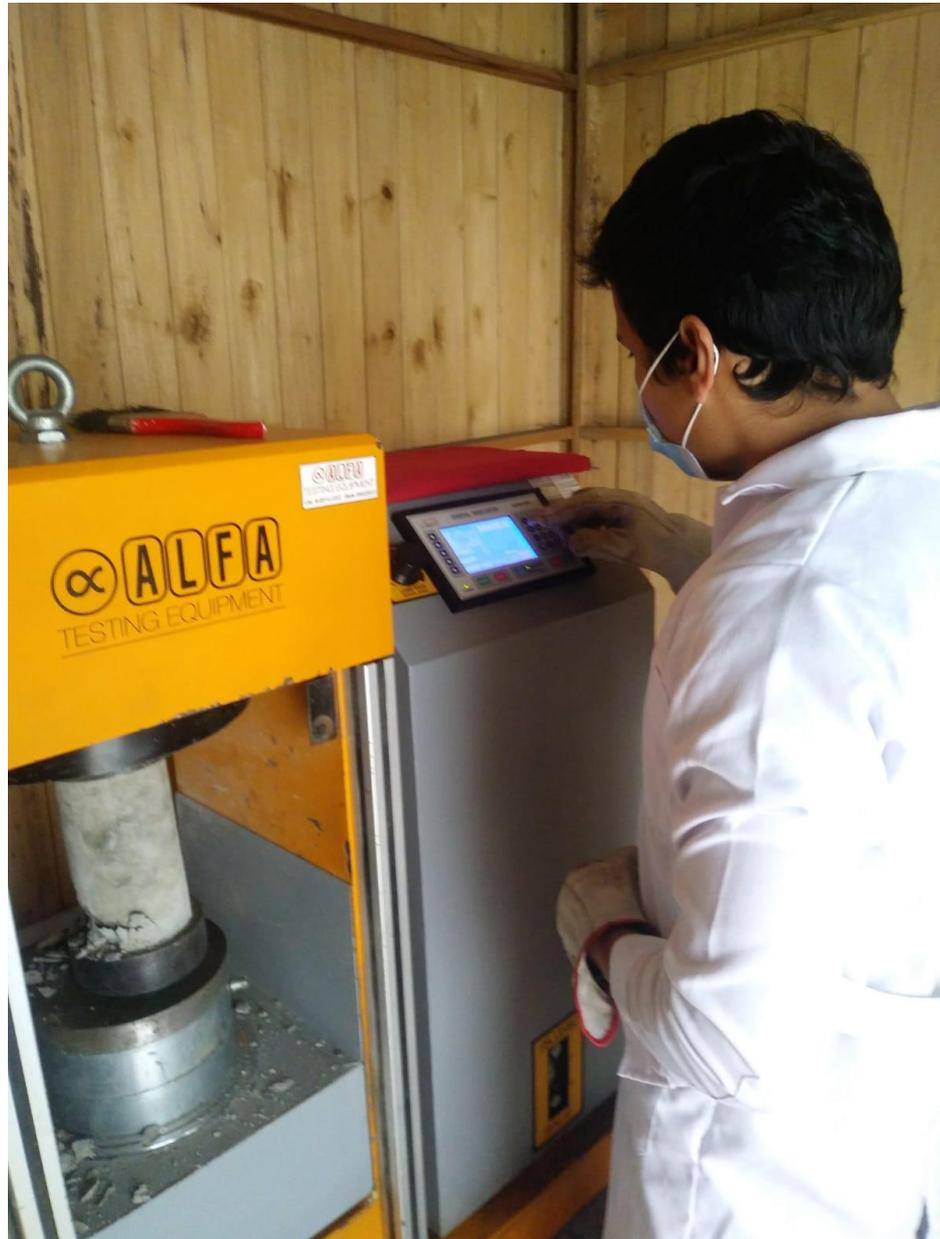
*Figura 85: Máquina compresora*
