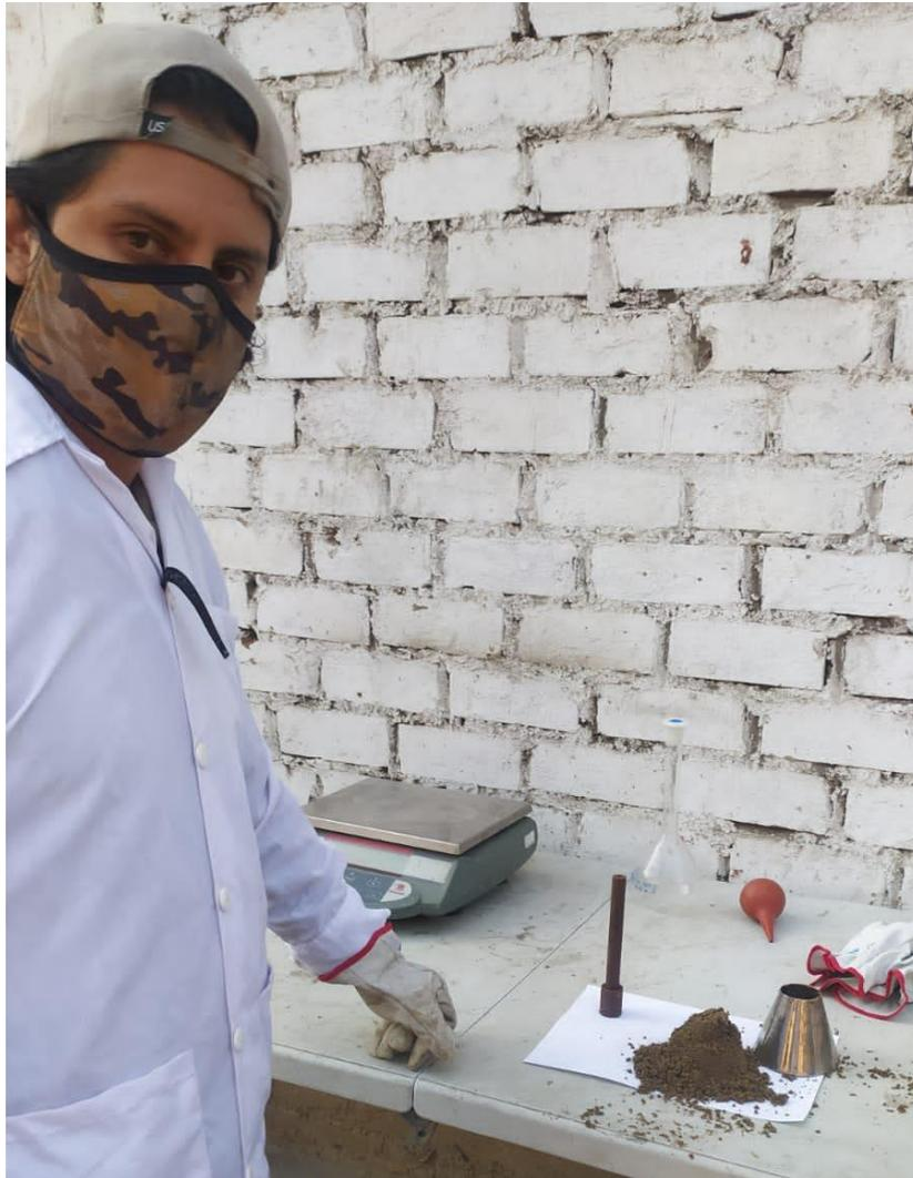
*Figura 54: Peso específico del agregado fino*
