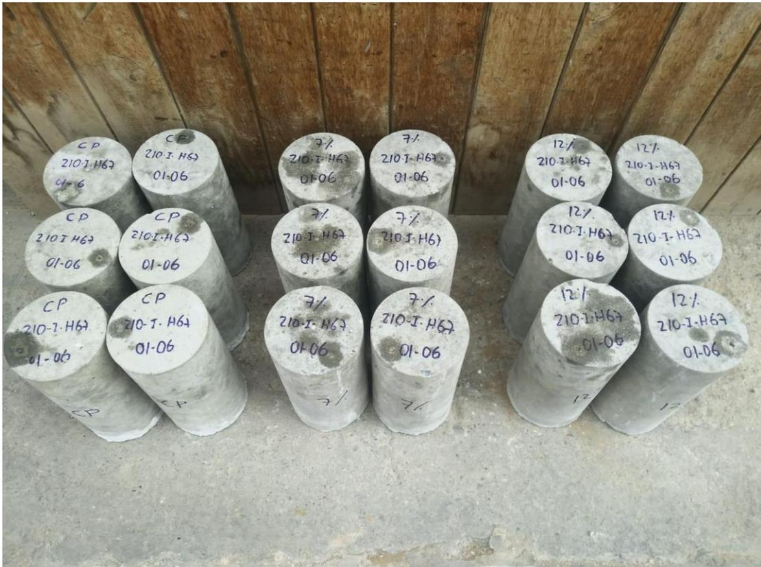
Figura 82: Especímenes de concreto curadas
