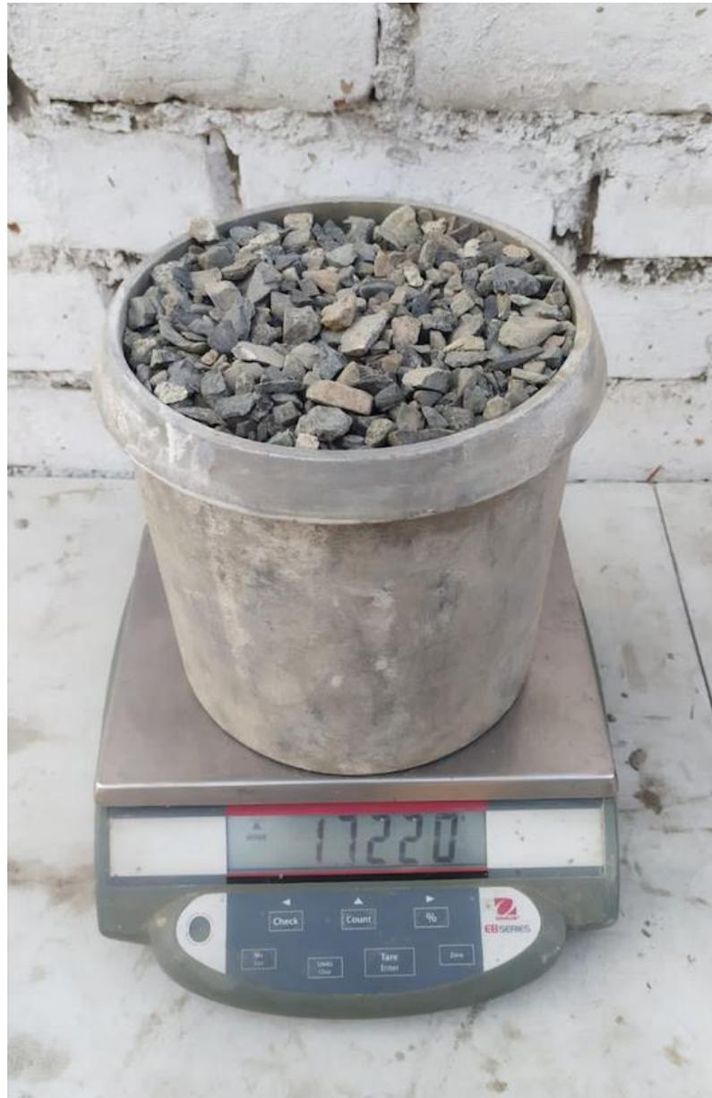
*Figura 49: Resultado del peso unitario suelto del agregado grueso*
