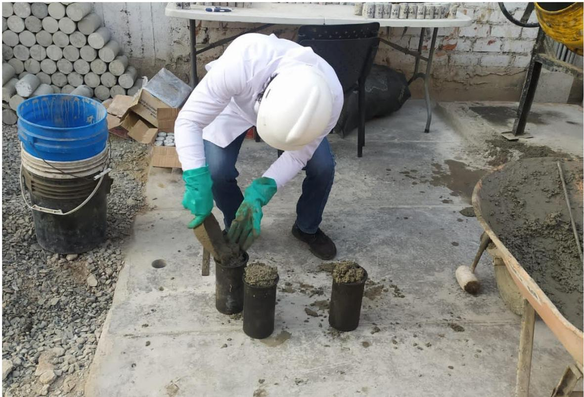
*Figura 76: Elaborando las probetas de concreto*
