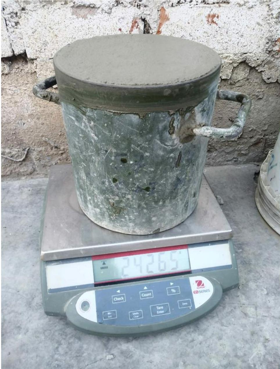
*Figura 63: Peso específico del concreto en estado fresco*
