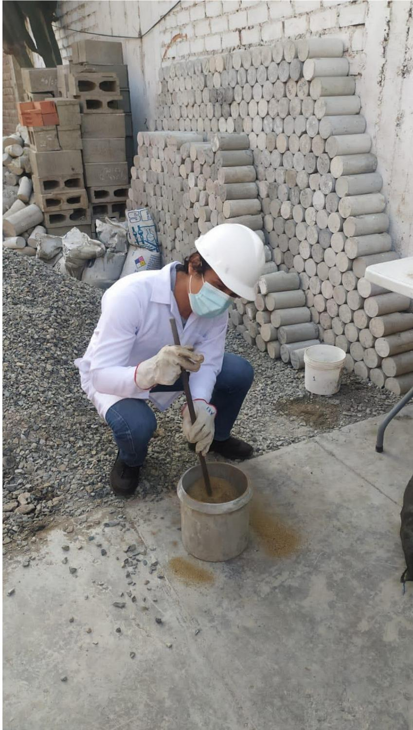
*Figura 46: Peso unitario compactado del agregado fino*
