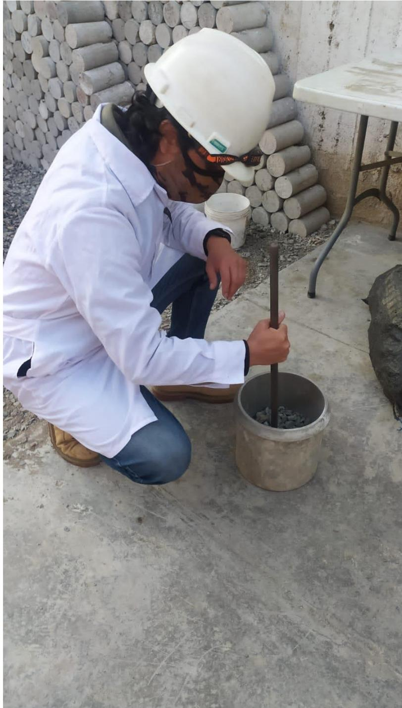
*Figura 50: Peso unitario compactado del agregado grueso*
