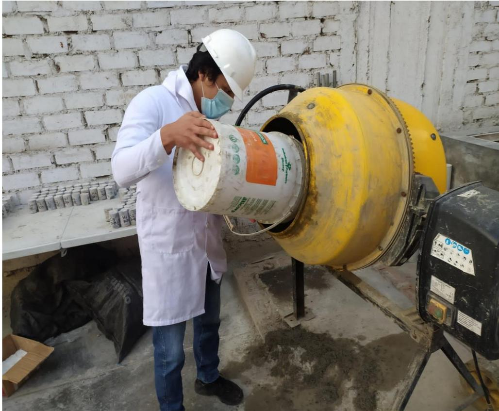
*Figura 57: Vertiendo el agregado grueso*
