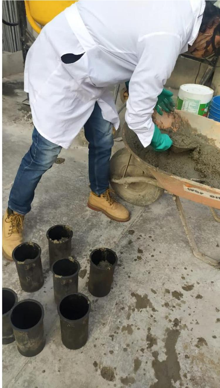
*Figura 71: Elaborando las probetas de concreto*
