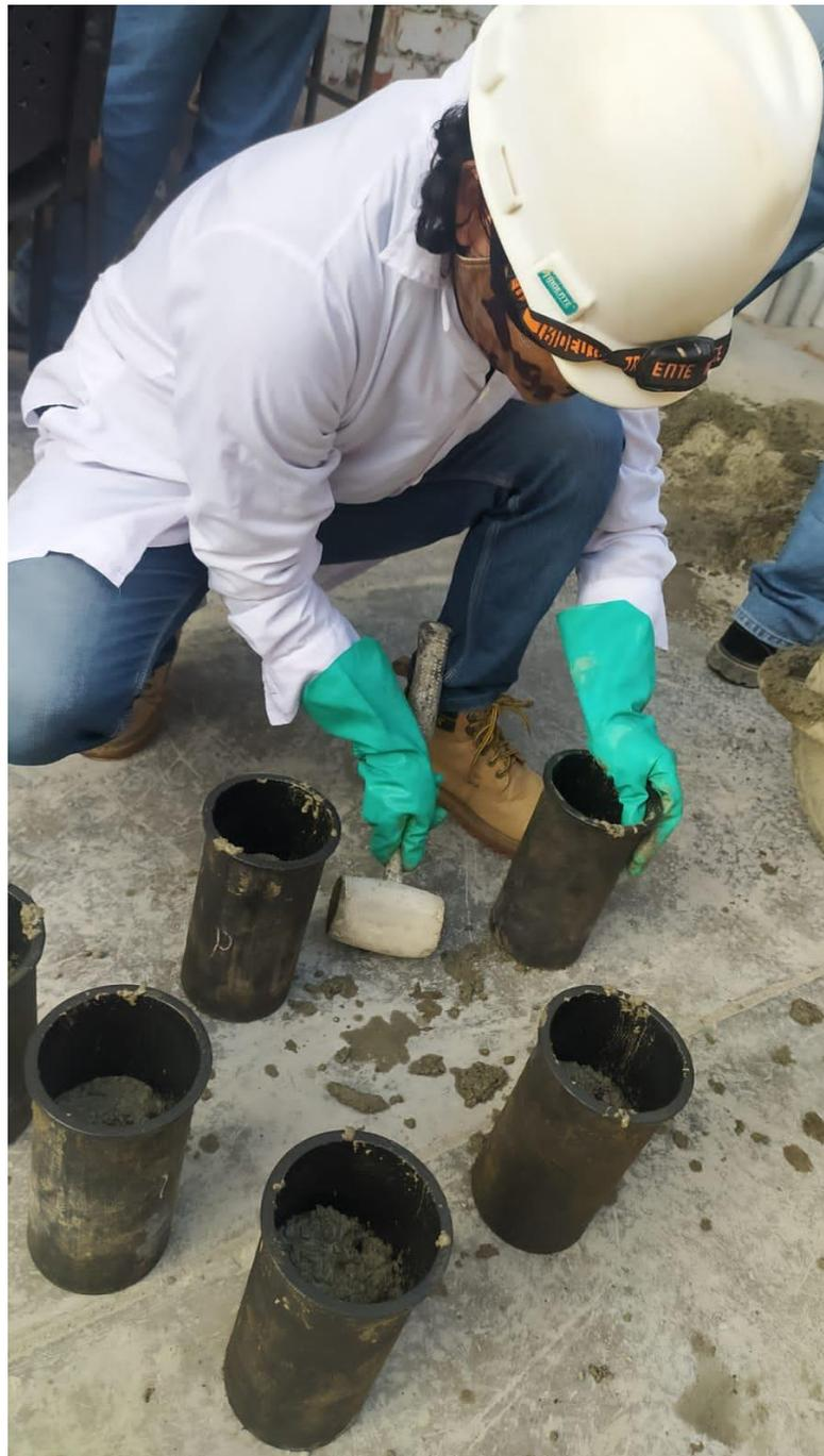
*Figura 73: Compactación de las probetas de concreto*
