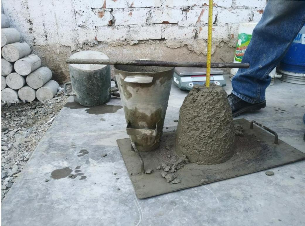
*Figura 67: Resultado del asentamiento del concreto – Muestra N°01*
