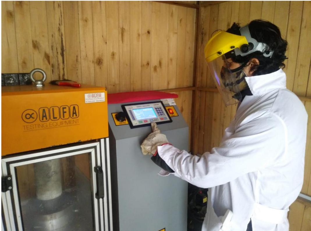
*Figura 83: Ensayo de resistencia a compresión*
