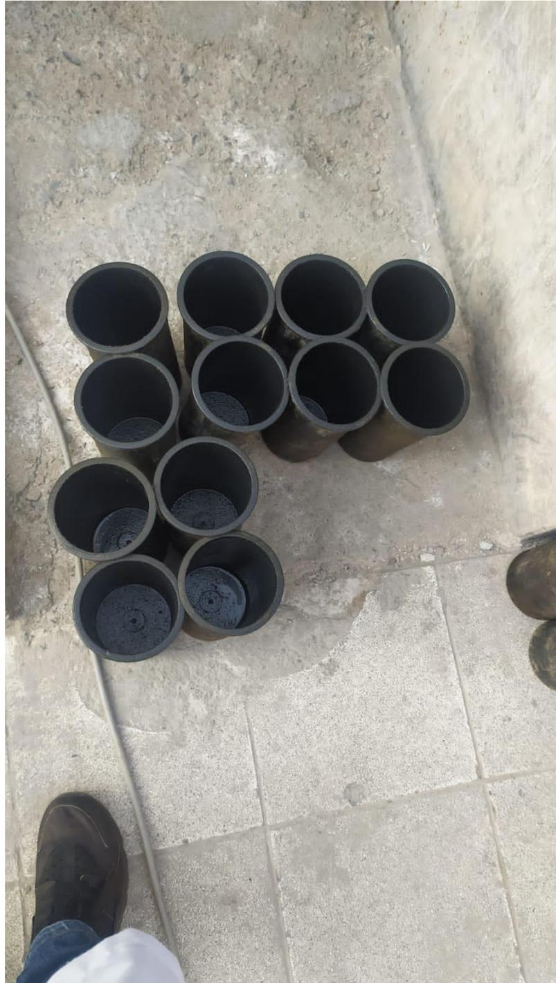
*Figura 70: Probetas de concreto de 10 cm x 20 cm*
