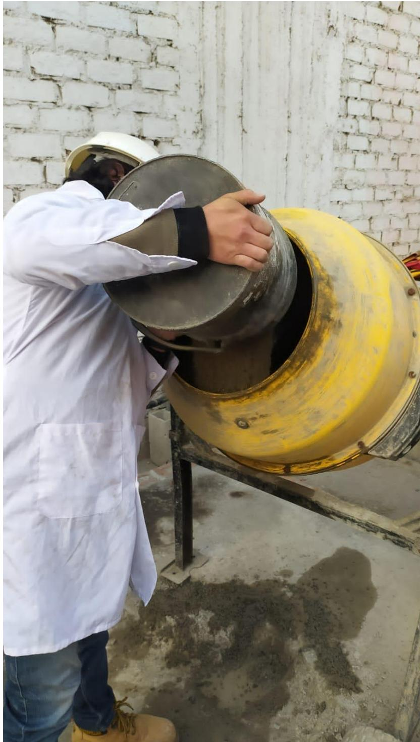
*Figura 58: Vertiendo el agregado fino*
