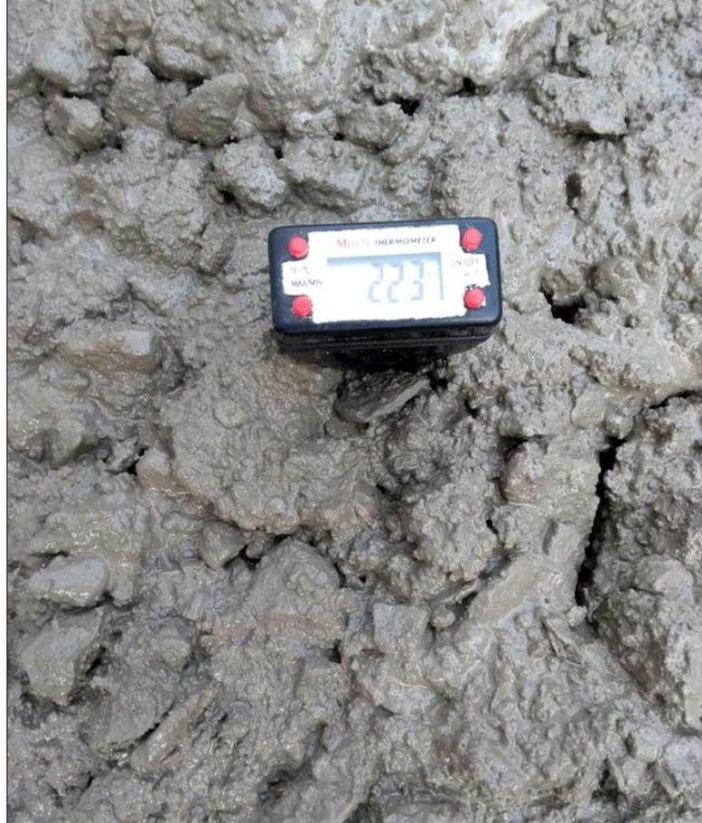
*Figura 62: Temperatura del concreto*
