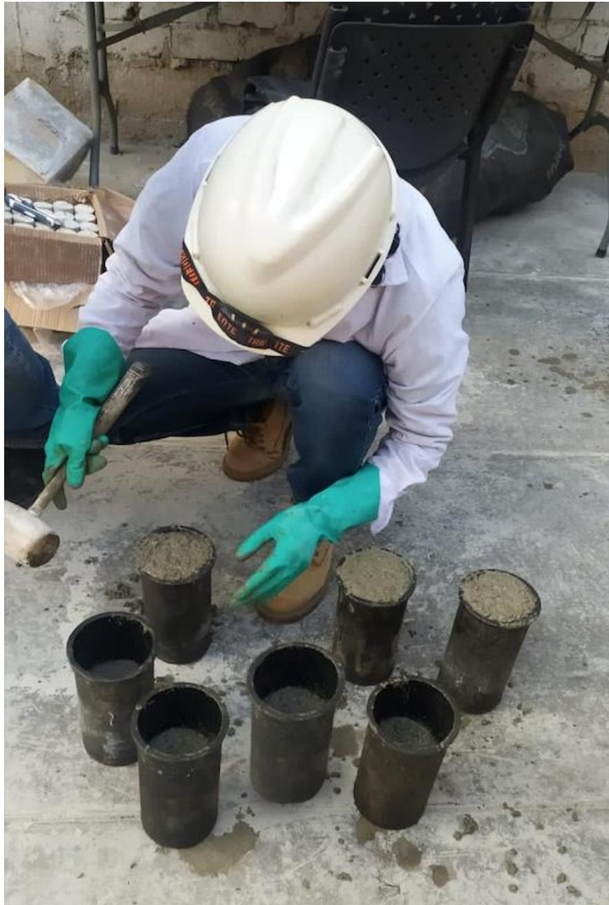
*Figura 74: Compactación de las probetas de concreto – última capa*
