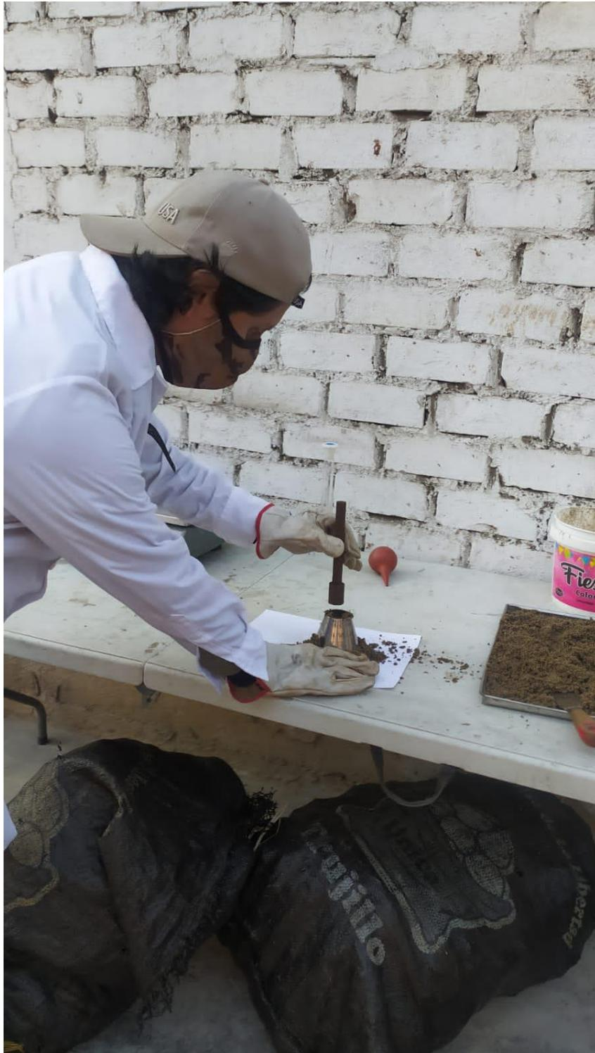
*Figura 53: Peso específico del agregado fino*
