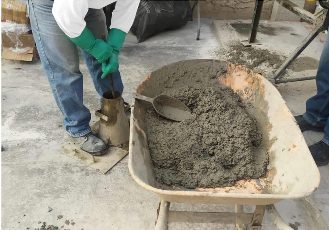
*Figura 65: Asentamiento del concreto*
