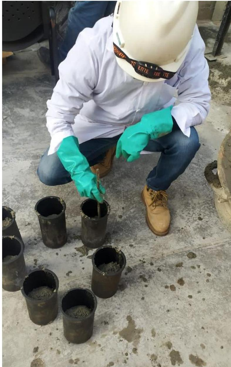
*Figura 72: Chuceando las probetas de concreto*
