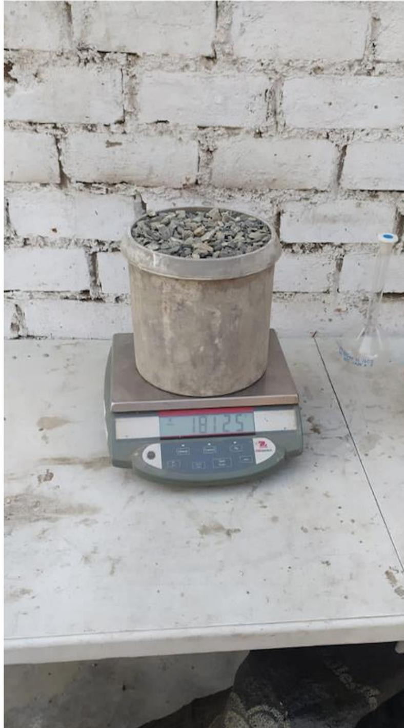
*Figura 51: Resultado del peso unitario suelto del agregado grueso*
