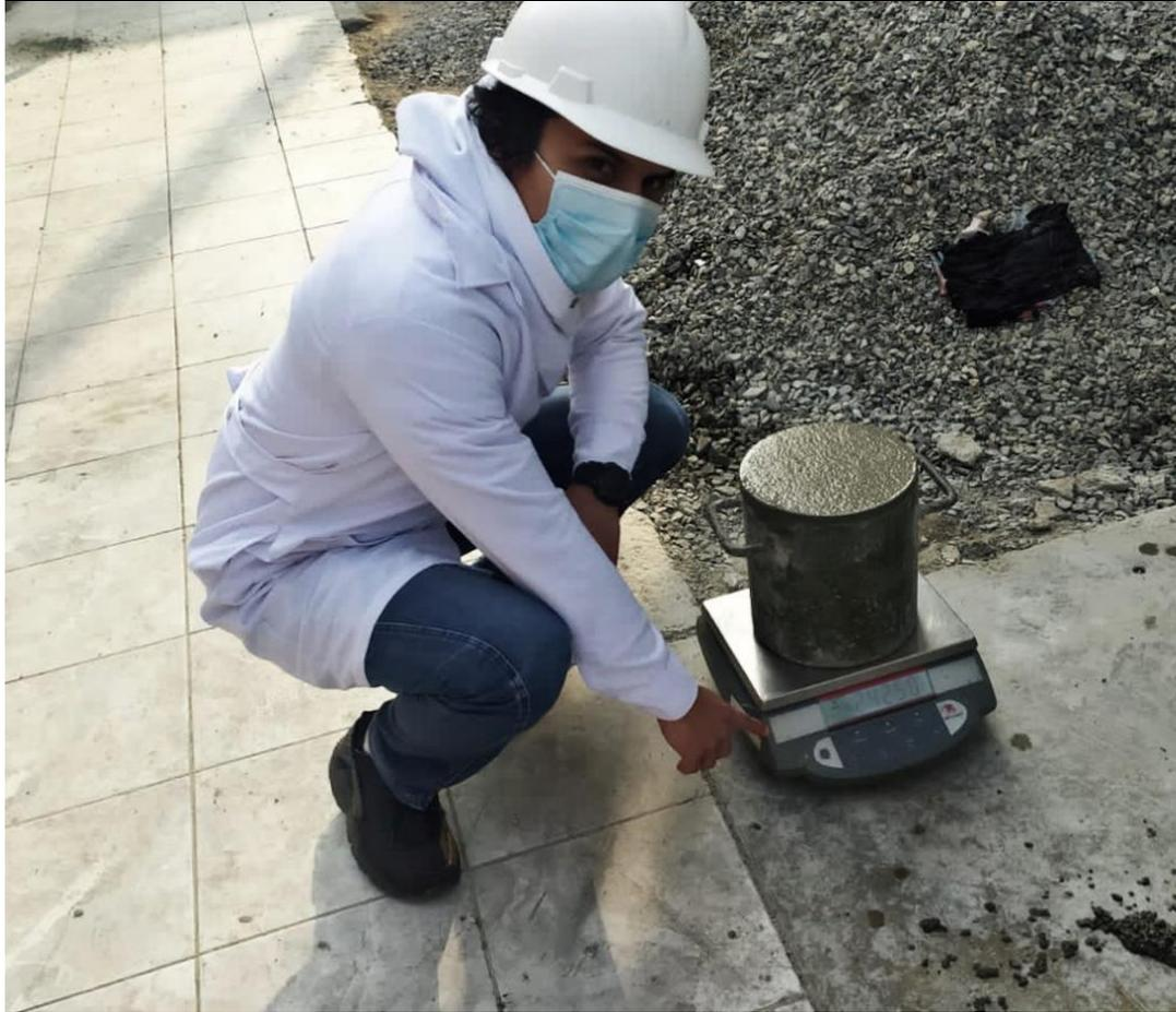
*Figura 64: Peso específico del concreto en estado fresco*
