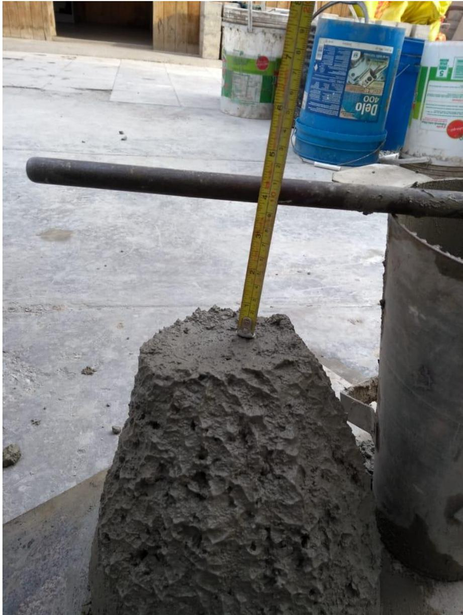
*Figura 69: Asentamiento del concreto - Muestra N°03*
