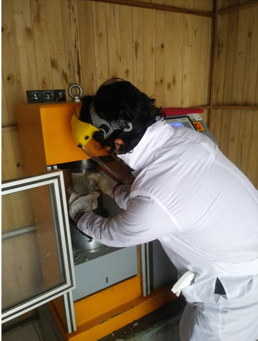
*Figura 84: Rotura de probeta*
