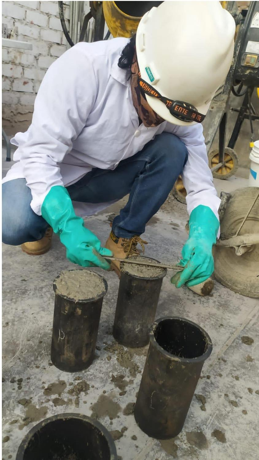
*Figura 75: Enrasado de las probetas de concreto*
