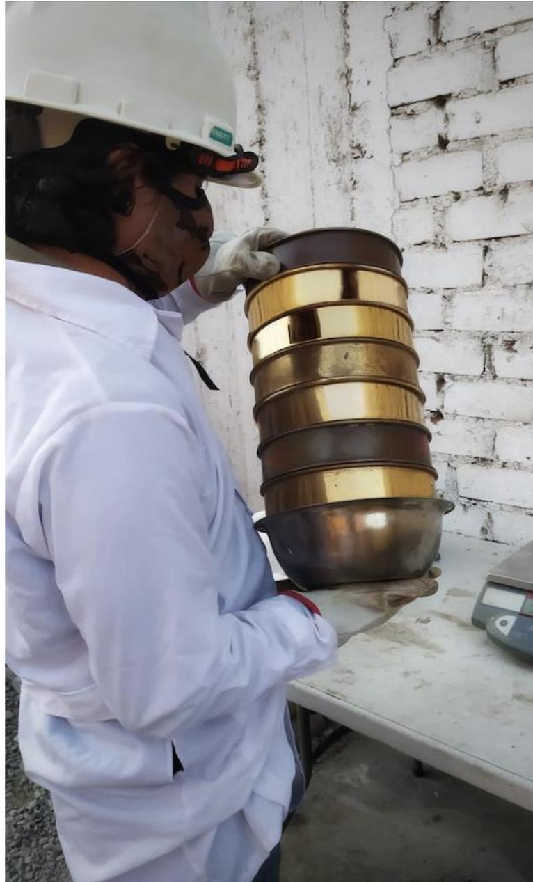
*Figura 42: Análisis granulométrico del agregado fino*
