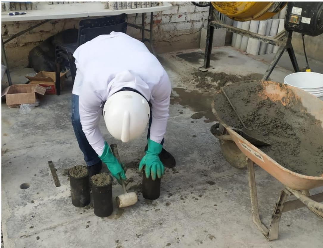
*Figura 78: Compactación de las probetas de concreto*
