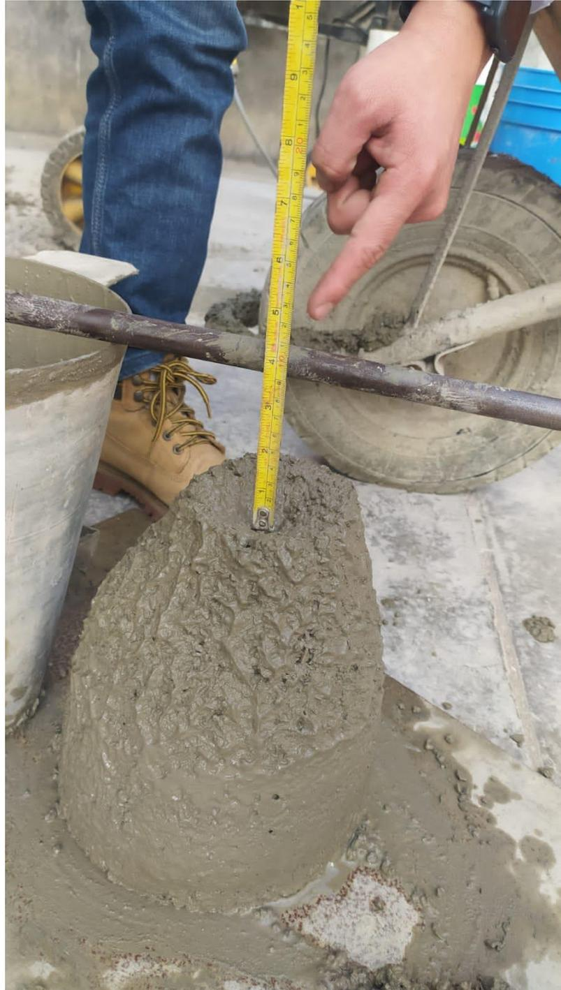
*Figura 68: Resultado del asentamiento del concreto – Muestra N°02*
