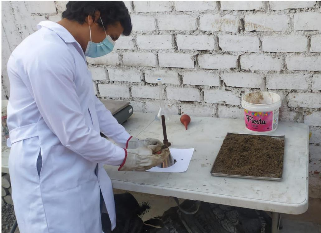
*Figura 52: Peso específico y absorción del agregado fino*
