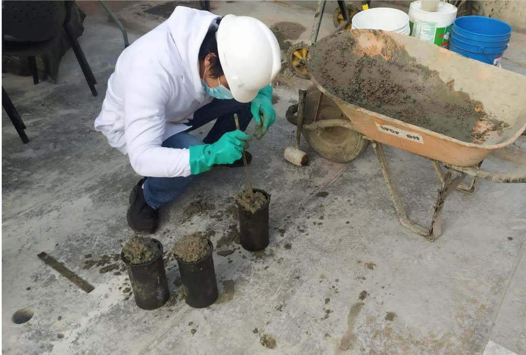
*Figura 77: Chuceado de las probetas de concreto*
