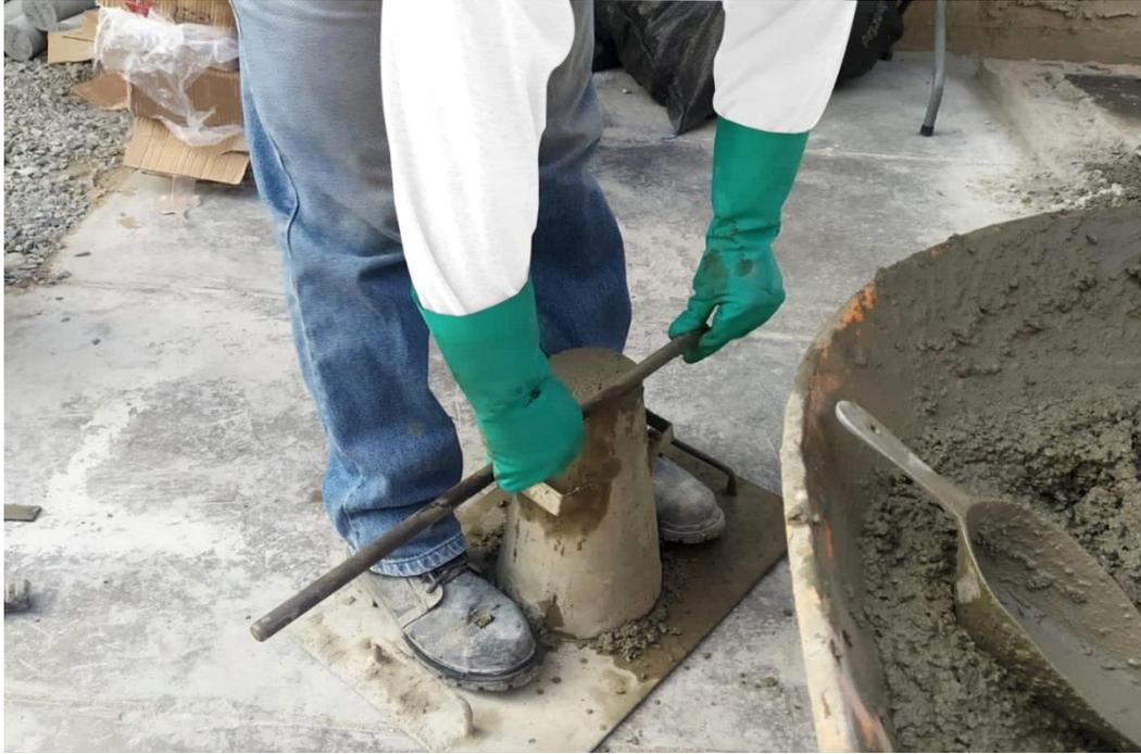
*Figura 66: Asentamiento del concreto*
