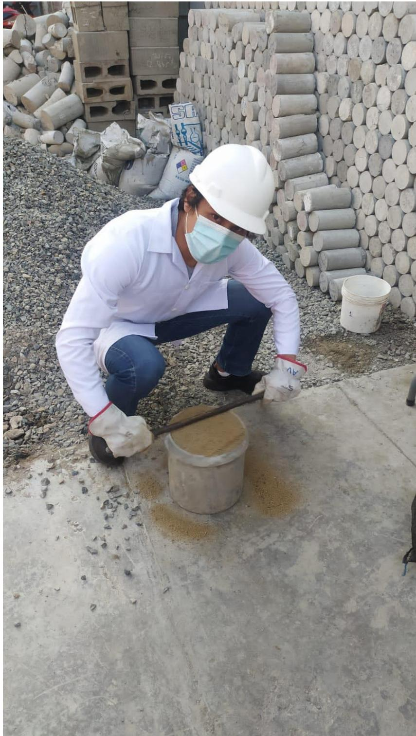
*Figura 44: Peso unitario suelto del agregado fino*
