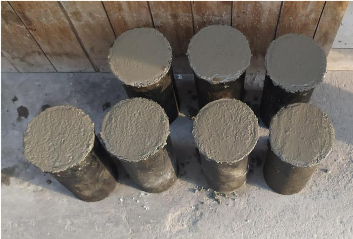
*Figura 80: Especímenes de concreto*
