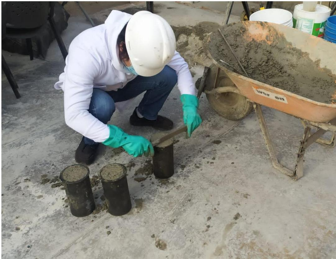
*Figura 79: Enrasado de las probetas de concreto*
