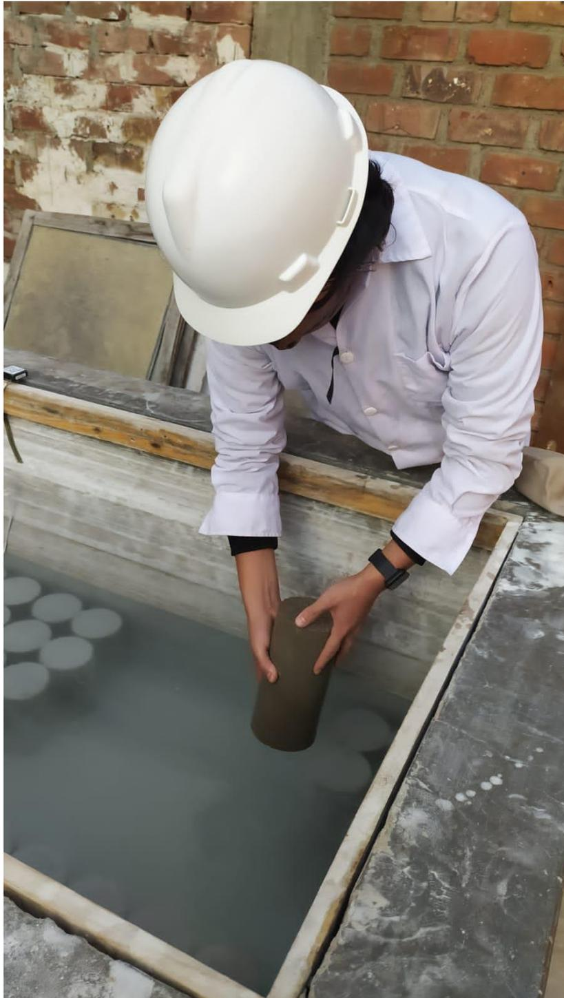
*Figura 81: Curado de las probetas*
