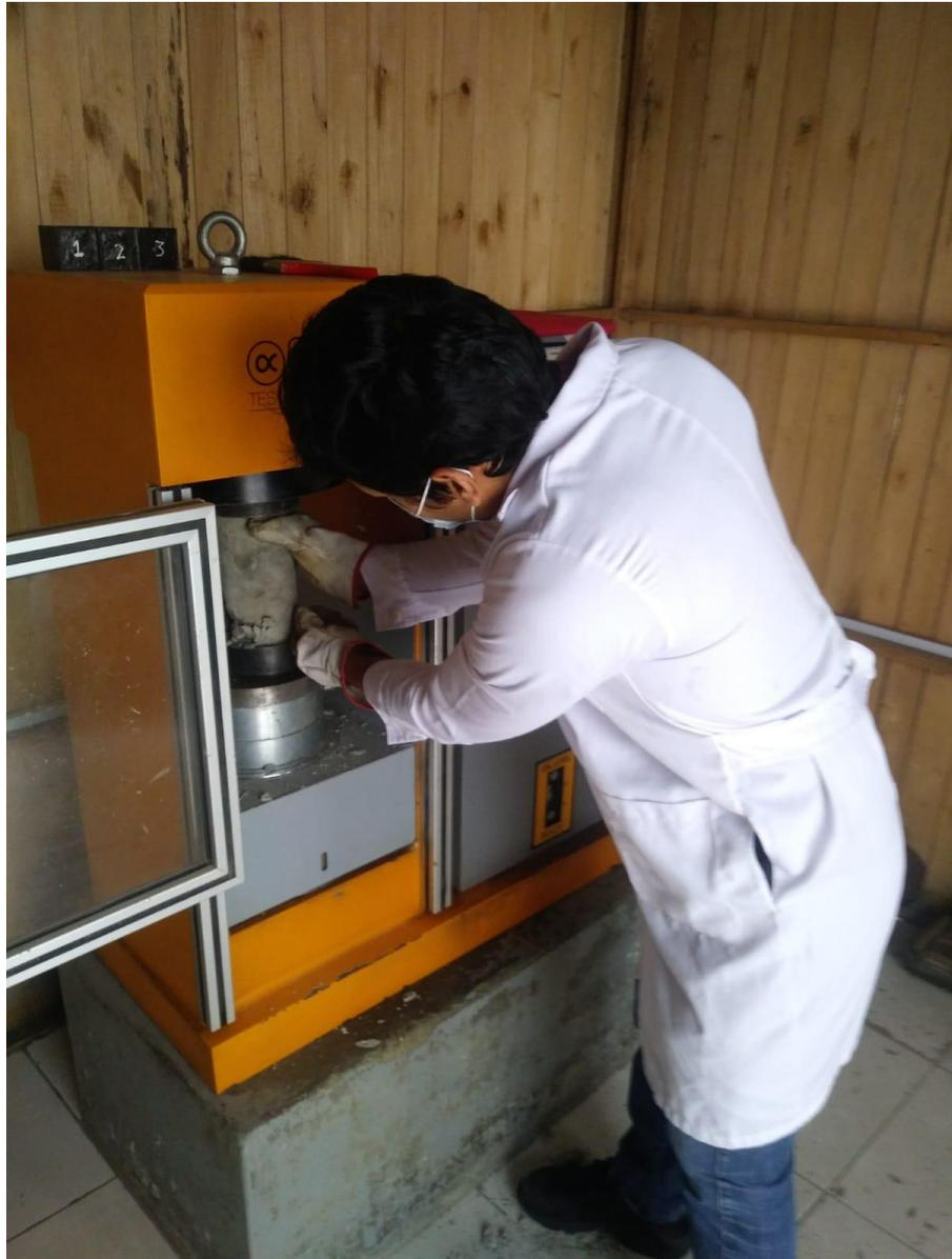
*Figura 86: Rotura de probetas*
