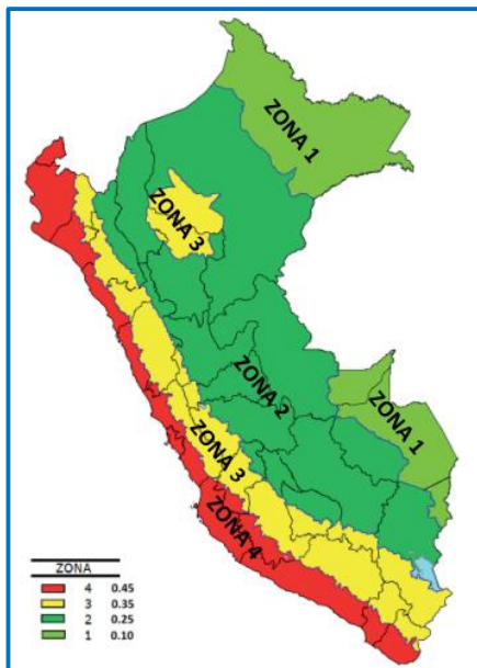
Figura 4. Zonas sísmicas. Fuente: Norma E.030
