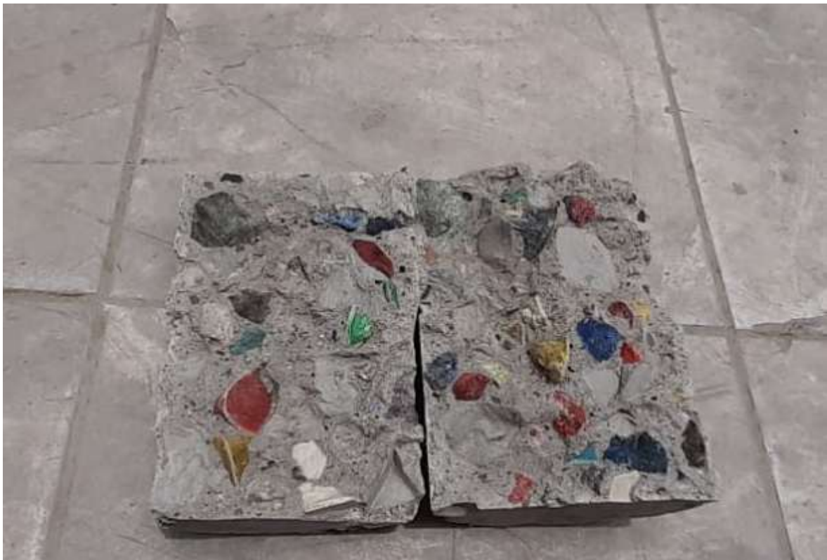
Figura N° 45: Interior del testigo con el 100% de polipropileno reciclado.
