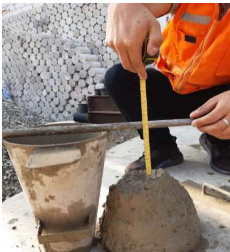
Figura N° 38: Ensayo de asentamiento del concreto.
