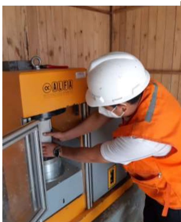
Figura N° 44: Extracción del testigo de la máquina de compresión axial.
