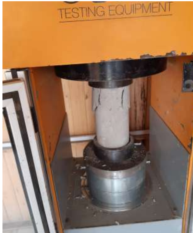
Figura N° 43: Ensayo de resistencia a la compresión.
