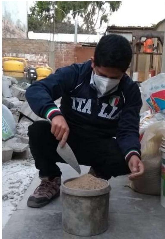
Figura N° 33: Peso unitario compactado del agregado fino.
