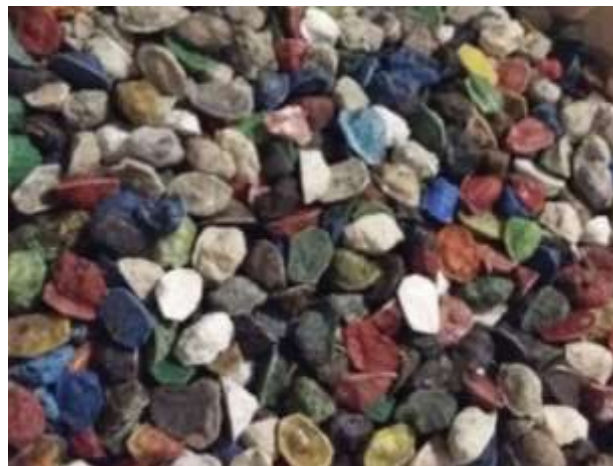
Figura N° 11: Agregado grueso plástico. Elaboración propia, 2020.
