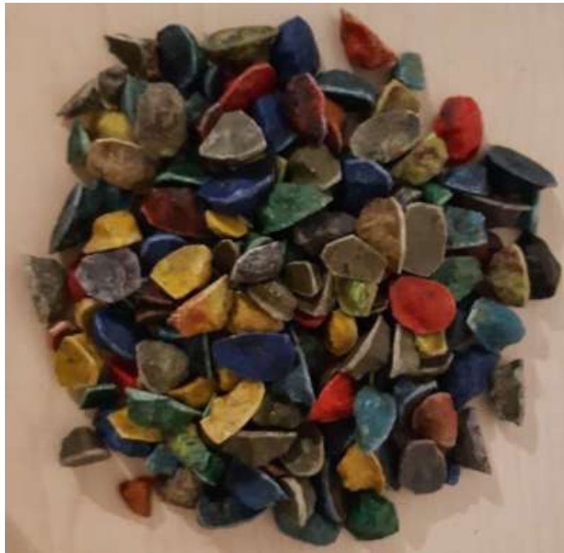
Figura N° 29: Resultado del polipropileno reciclado en forma de agregado grueso.
