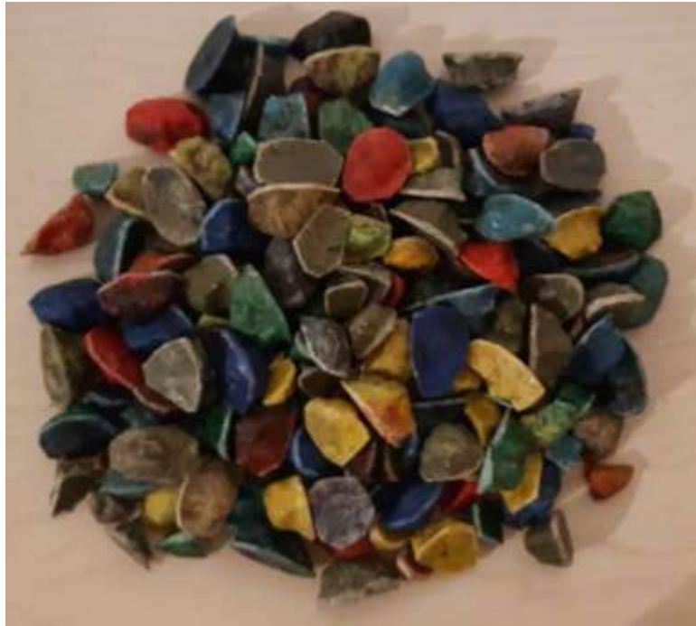
Figura N° 31: Agregado de polipropileno reciclado para granulometría.
