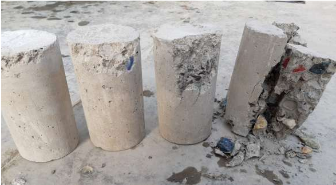
Figura N° 46: Testigos ensayados de la resistencia a la compresión.
