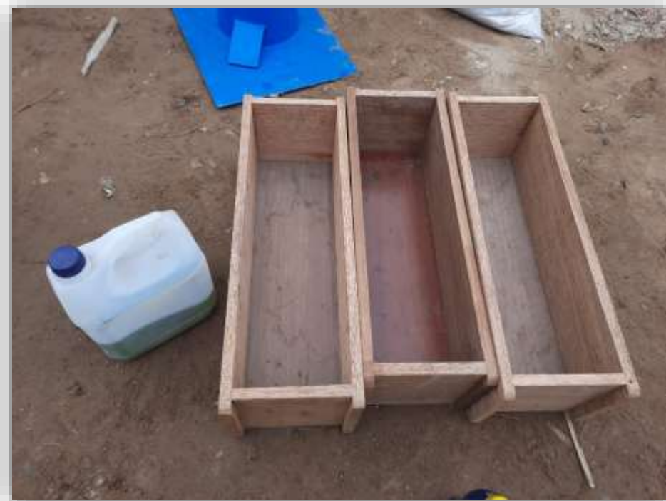
Ilustración 26.- Moldes de madera para la realización de las probetas prismáticas.
