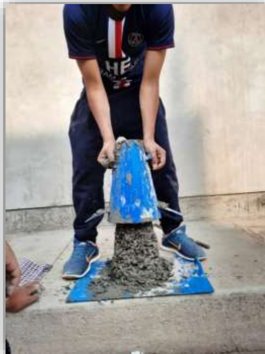
Ilustración 36.- Se retira cuidadosamente de manera vertical.
