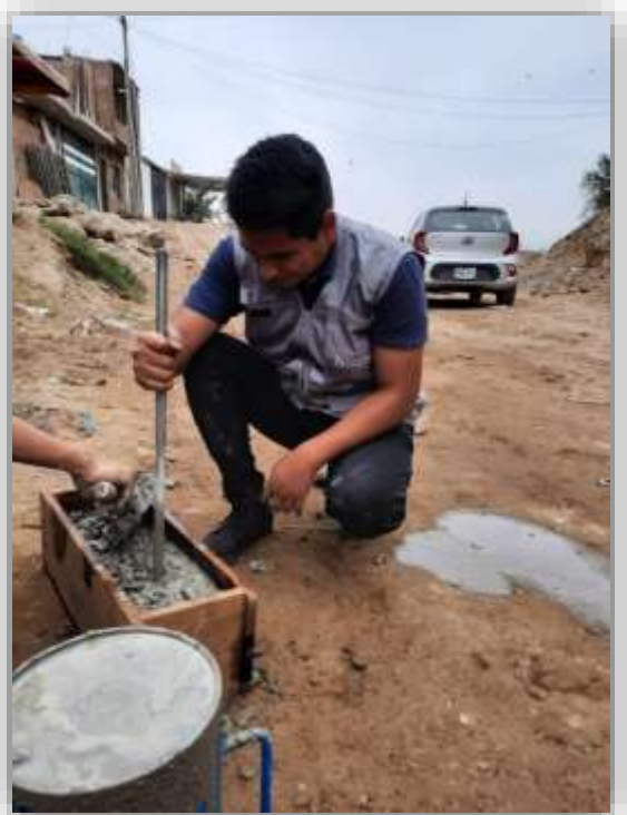
Ilustración 40.- Chuceo con 25 golpes, en cada una de las 3 capas, del molde prismático.
