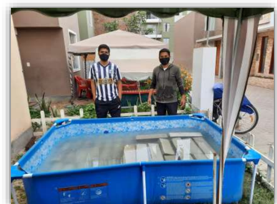
Ilustración 44.- Curado de todas las probetas, cilíndricas y prismáticas.
