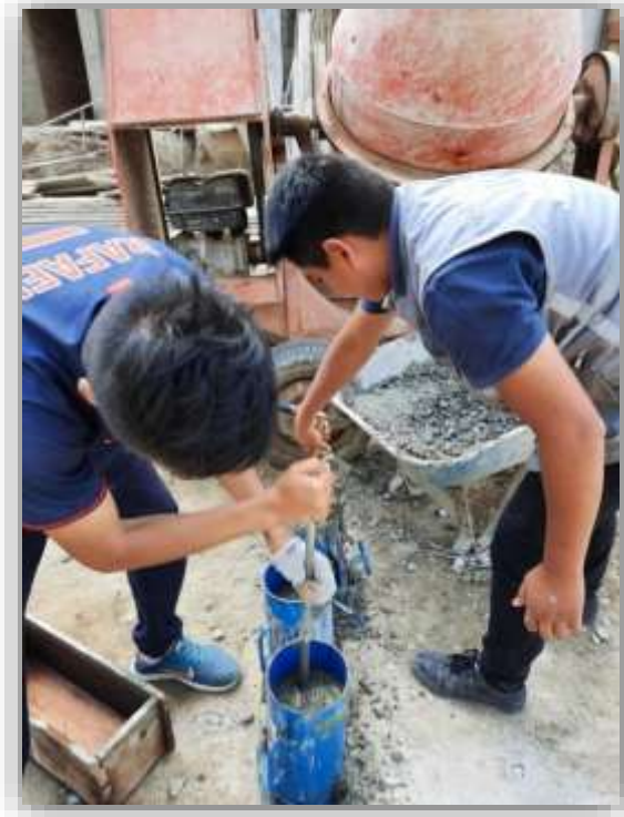
Ilustración 39.- Chuceo con 25 golpes, en cada una de las 3 capas.
