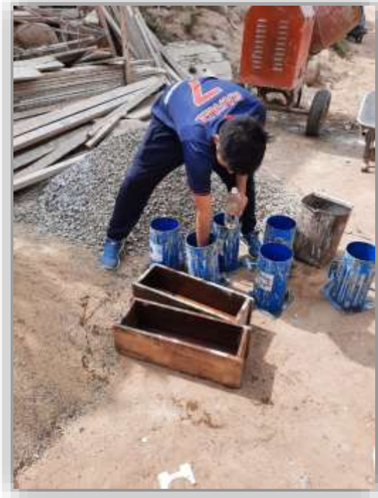
Ilustración 27.- Como desmoldante para las probetas cilíndricas se usó el aceite.
