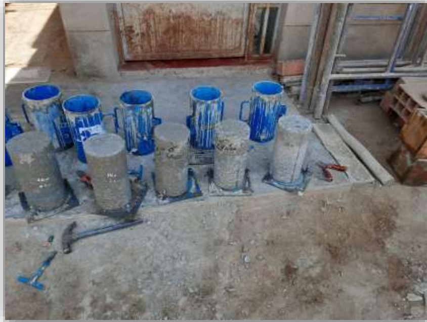
Ilustración 41.- Desencofrado de probetas cilíndricas.
