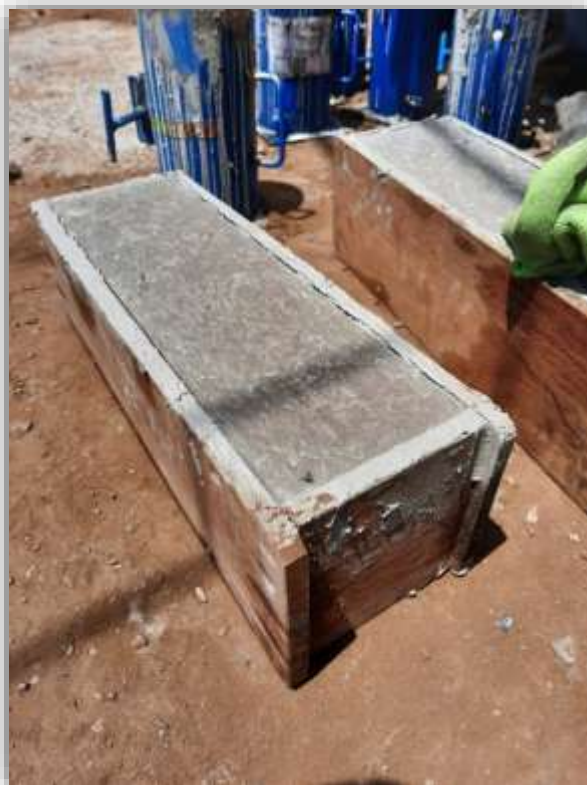
Ilustración 42.- Desencofrado de probetas prismáticas.
