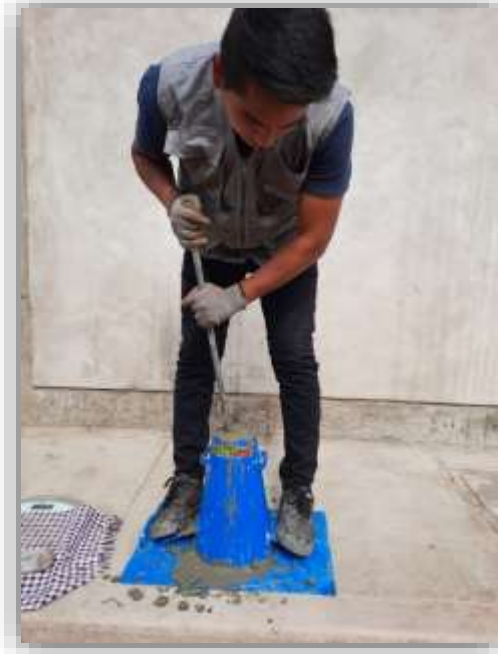
Ilustración 35.- Se realiza el chuceado y al final se enrasa.
