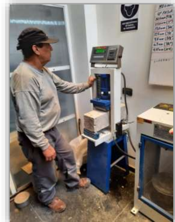
Ilustración 47.- Colocando la probeta a la prensa de resistencia a la flexión.
