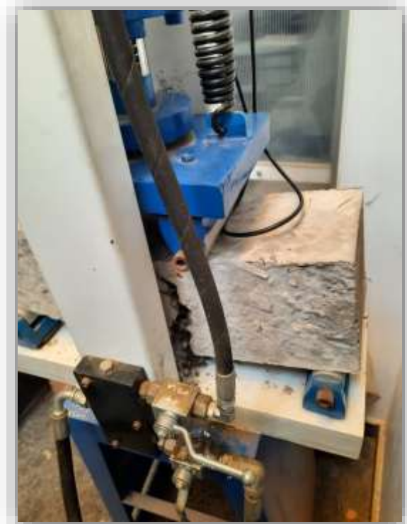
Ilustración 48.- Ensayo de Resistencia a la Flexión.
