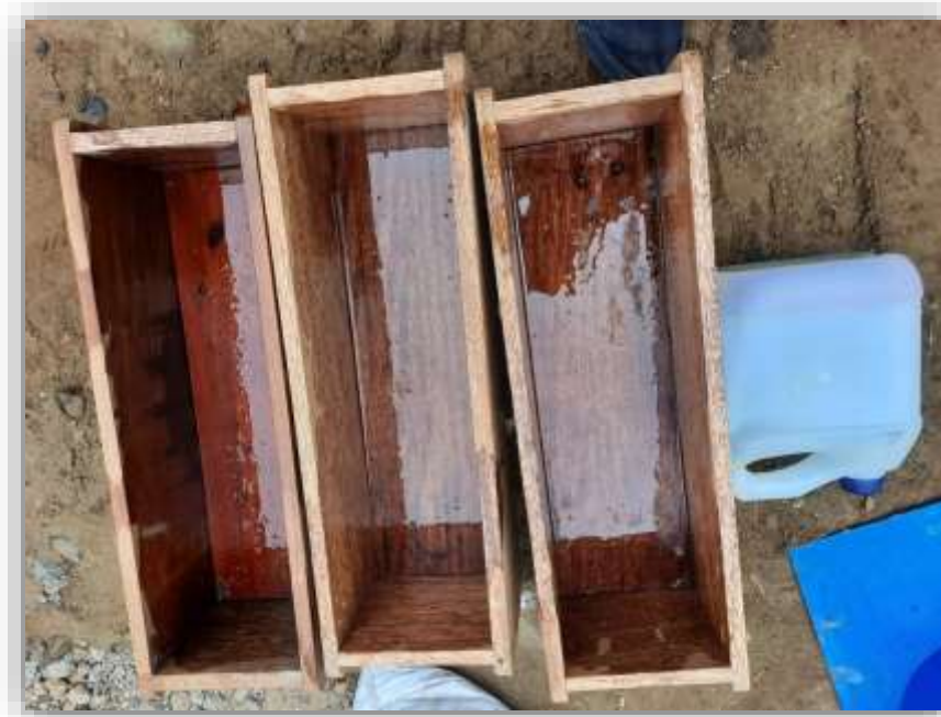
Ilustración 28.- Como desmoldante para las probetas prismáticas se usó petróleo.
