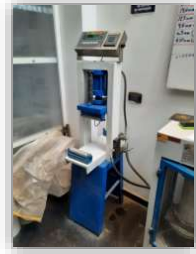
Ilustración 5.- Prensa Hidráulica de Flexión.
