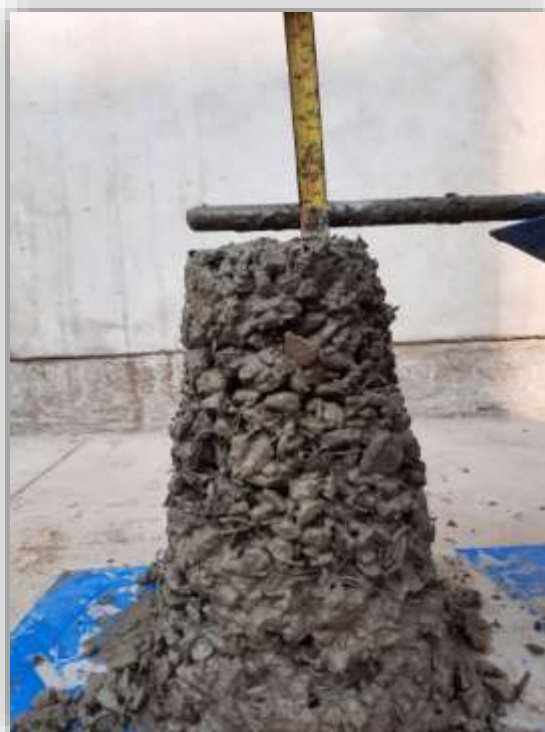
Ilustración 38.- La mezcla usada para el ensayo de slump se desecha.
