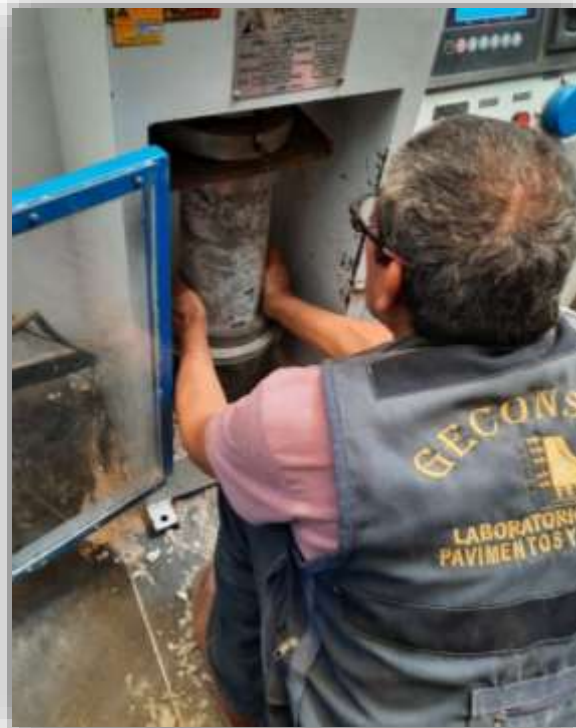
Ilustración 45.- Colocando la probeta a la prensa de resistencia a la compresión..
