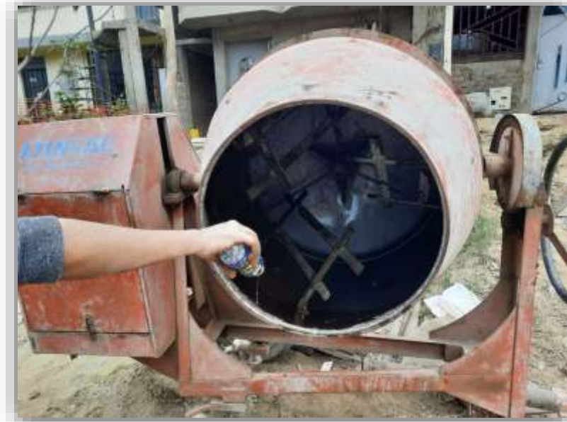
Ilustración 29.- Para que la mezcla no se pegue en el trompo se le mojó con petróleo.
