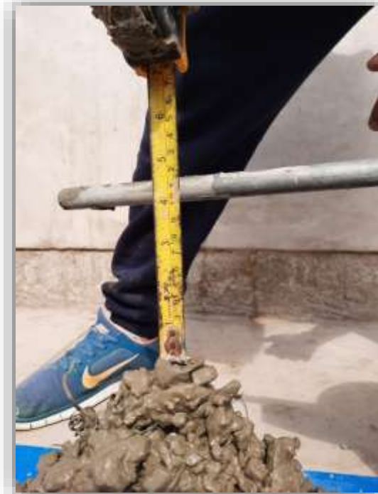
Ilustración 37.- Se mide el Slump en pulgadas.
