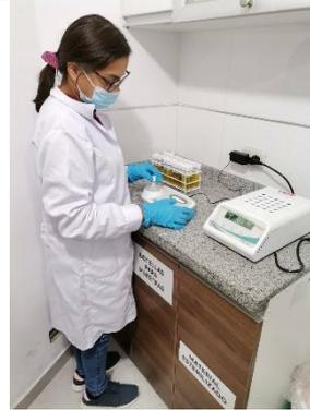
Medición de DQO mediante el colorímetro
