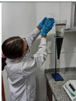
Adición de muestra tratada con cloruro férrico al proceso de adsorción
