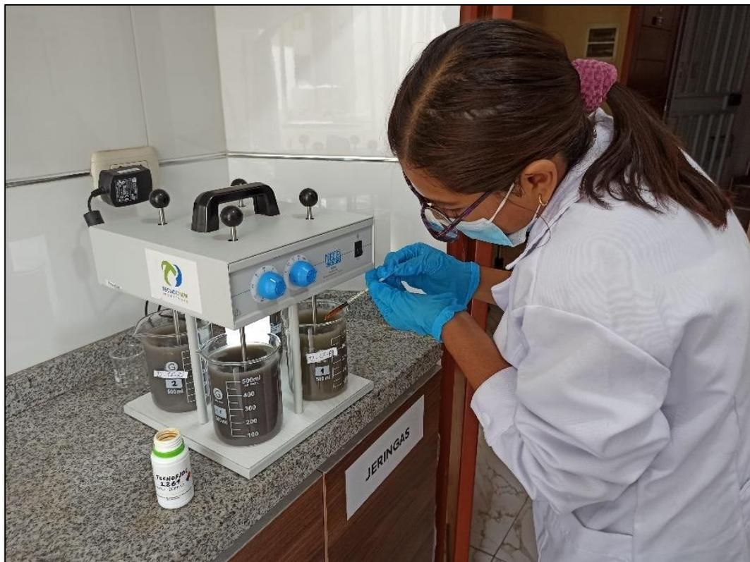
Figura 2. Proceso de Coagulación-Floculación aplicando Cloruro Férrico.
