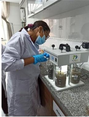
Coagulación con Policloruro de aluminio (PA)
