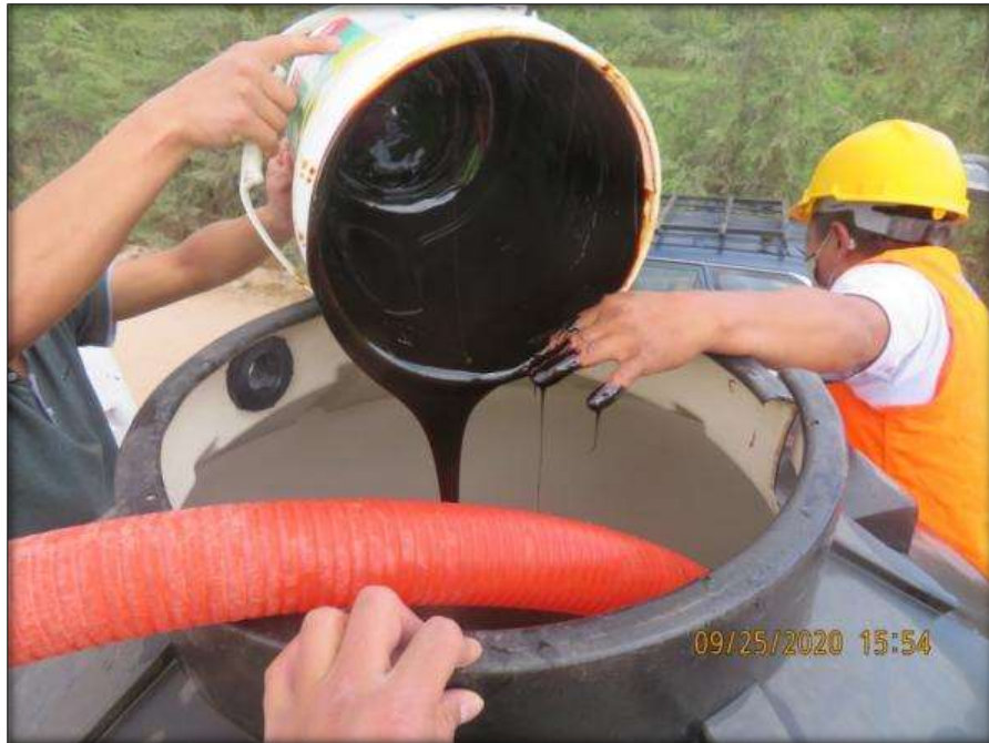
Imagen 14. Se adición de melaza en agua.
