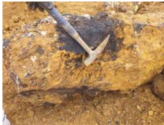
Muestra de Psilomelano de alta pureza (>53% en mn), extraído de la calicata N°01.
